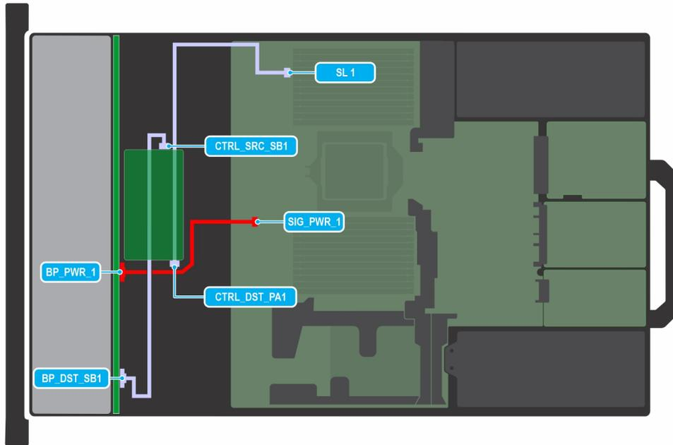
**Ilustración 72. Configuración 4-1: 10 SAS4/SATA RAID de 2,5 pulgadas (con FPERC11)**
