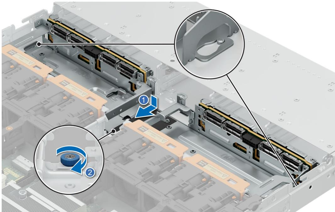
**Ilustración 61. Instalación del backplane de 14 unidades E3.S**
