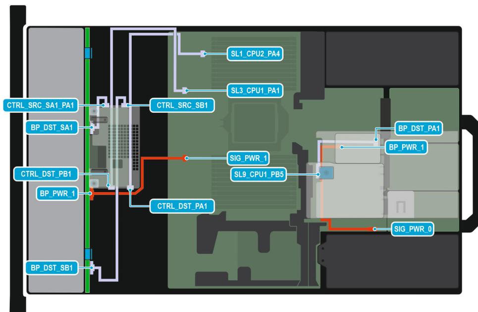
**Ilustración 80. Configuración 4-12: 10 RAID SAS4/SATA de 2,5 pulgadas con 2 x E3 posteriores. S G5x4 (con FPERC 12)**
