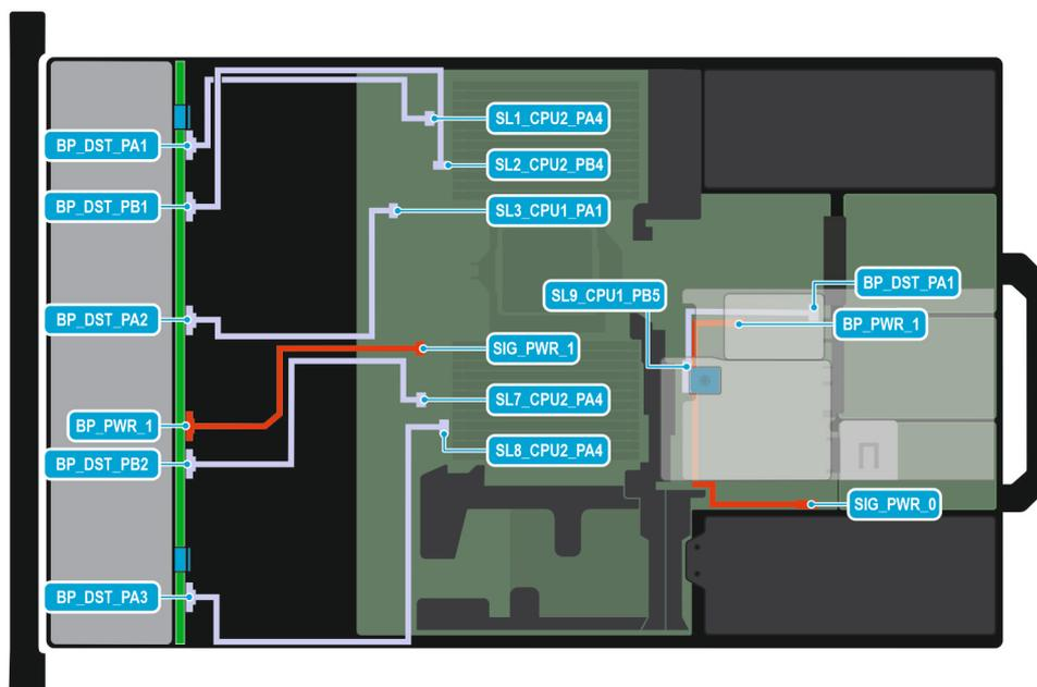
**Ilustración 81. Configuración 4-13: 10 X U.2 G4 con posterior 2 x E3. S G5x4**
