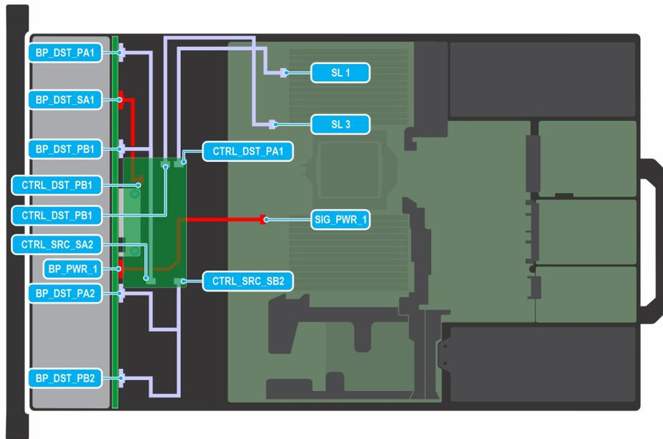
**Ilustración 71. Configuración 3-3: 8 NVMe RAID (con FPERC12) de 2,5 pulgadas**
