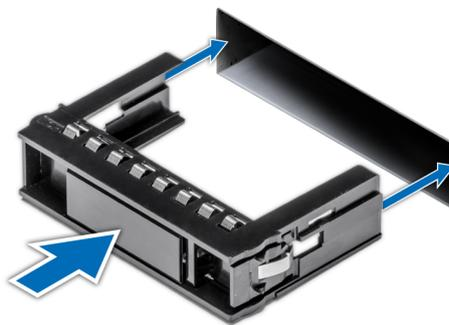
**Ilustración 39. Instalación de una unidad de relleno**
