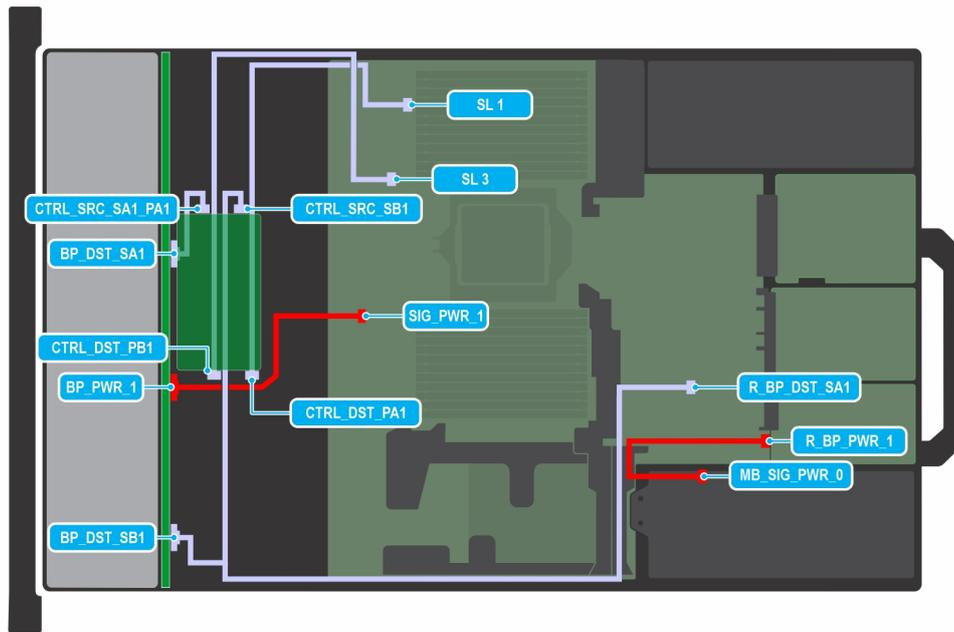
**Ilustración 77. Configuración 4-6: 10 SAS4/SATA RAID de 2,5 pulgadas con posterior de 2 x 2,5 pulgadas (con FPERC12)**
