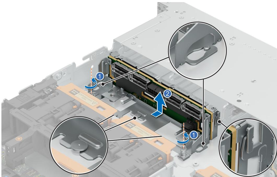
**Ilustración 62. Extracción del backplane de 16 unidades E3.S**
