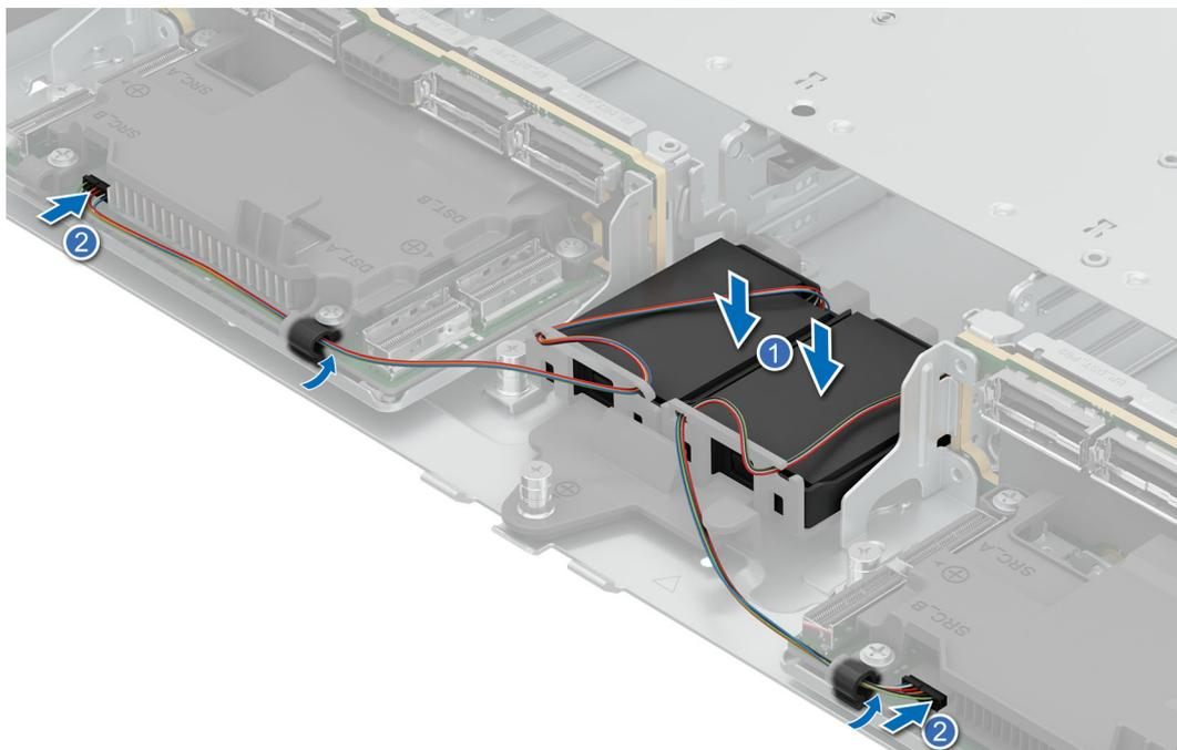
**Ilustración 92. Instalación de la batería de la PERC**
