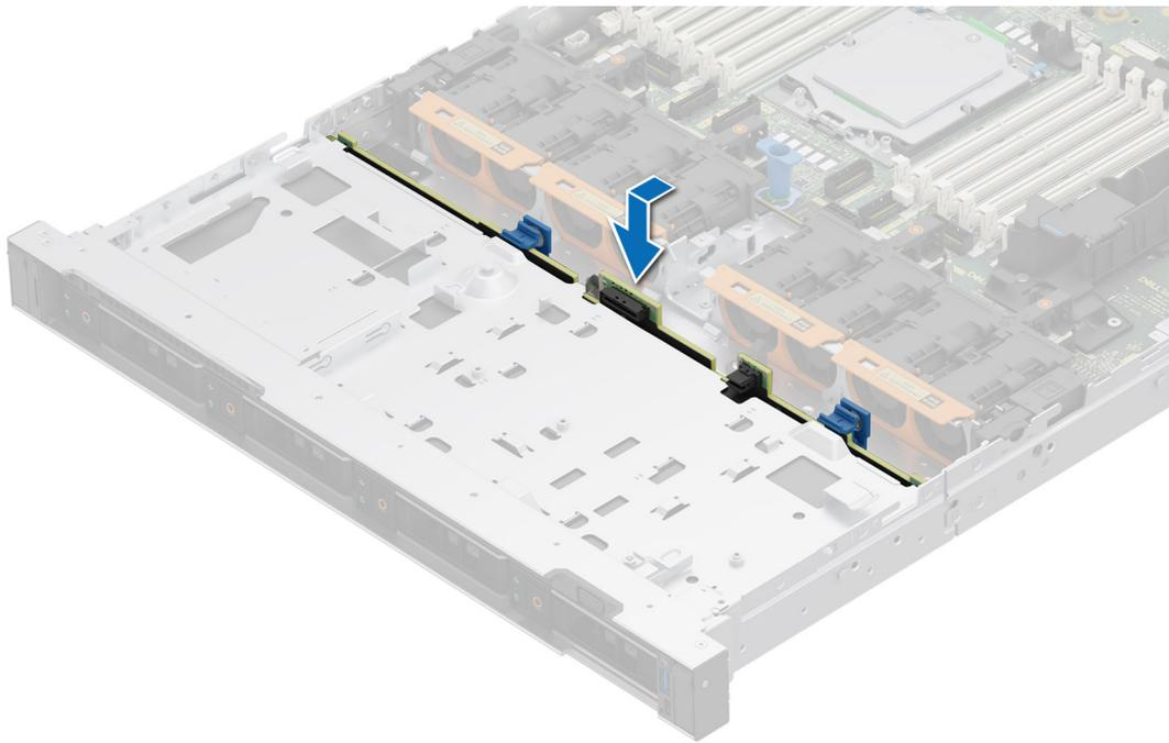
**Ilustración 59. Instalación del backplane de la unidad**
