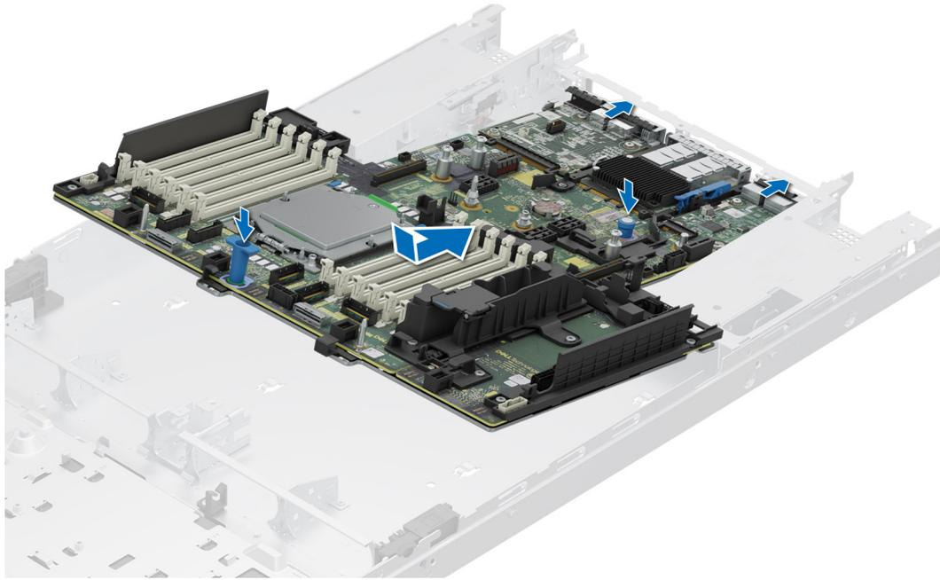
**Ilustración 169. Instalación de la tarjeta madre**
