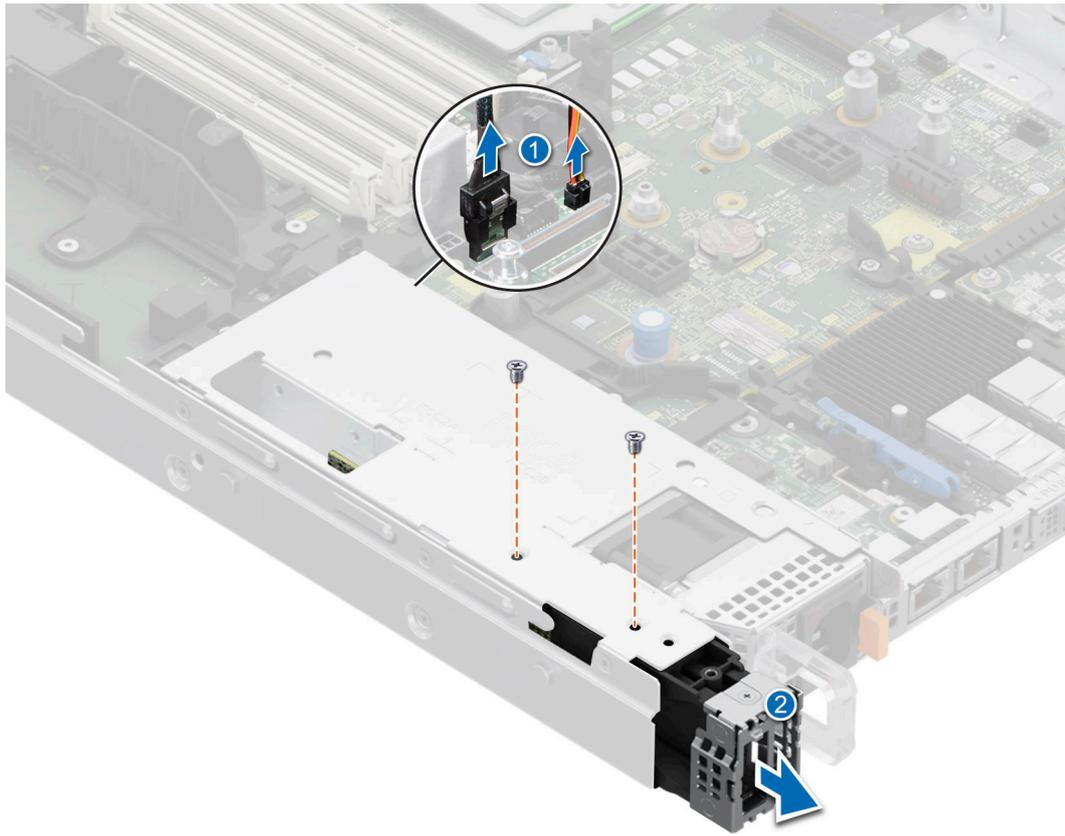
**Ilustración 141. Extracción del portaunidades de tarjeta BOSS-N1 de relleno**
