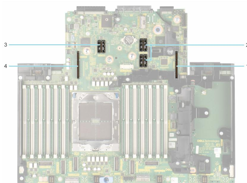
**Ilustración 108. Conectores de la ranura de tarjeta elevadora para tarjetas de expansión**
