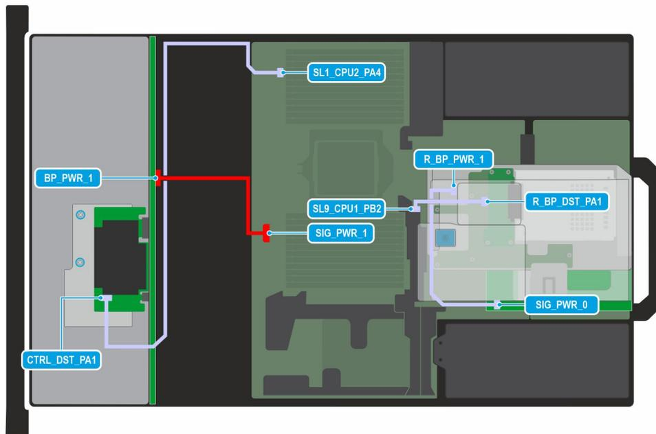
**Ilustración 68. Configuración 1-3: 4 RAID SAS3/SATA de 3,5 pulgadas con 2 E3. S G5x4 posterior**
