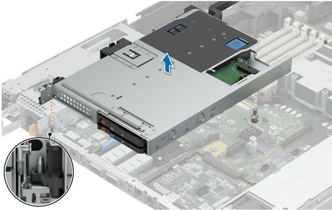
**Ilustración 51. Extracción del módulo de E3.S posteriores**
