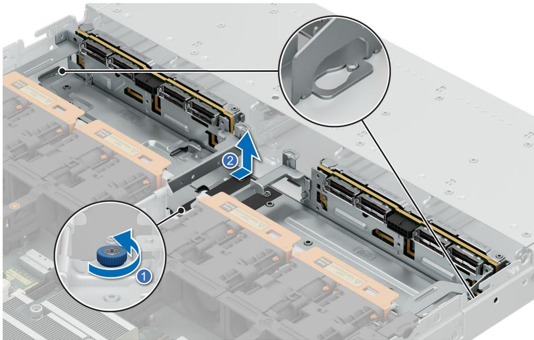
**Ilustración 60. Extracción del backplane de 14 unidades E3.S**
