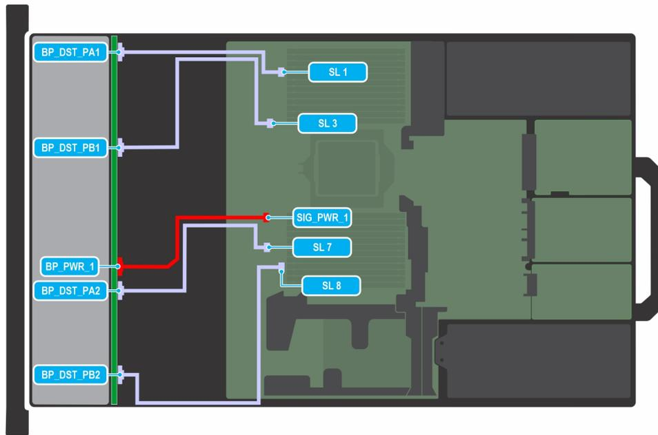
**Ilustración 69. Configuración 3-1: 8 NVMe de 2,5 pulgadas**
