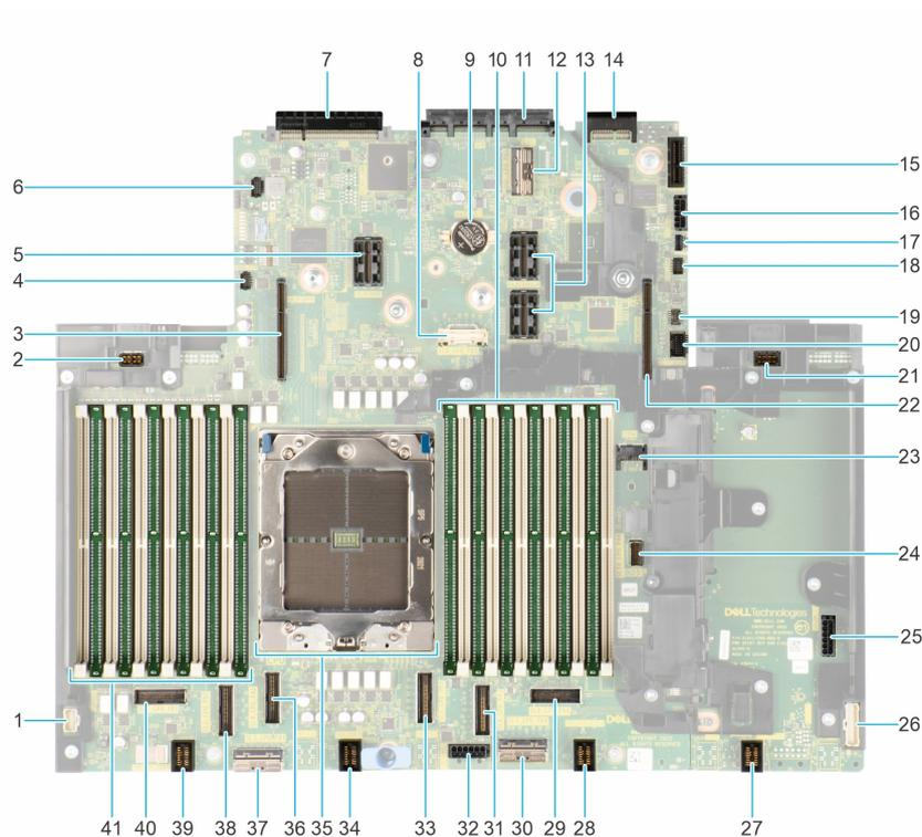
Ilustración 178. Puentes y conectores de la tarjeta madre del sistema
