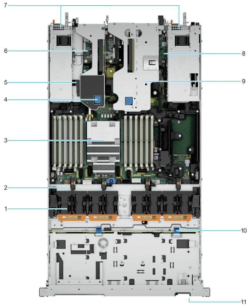
**Ilustración 11. Interior del sistema con tarjetas elevadoras**
