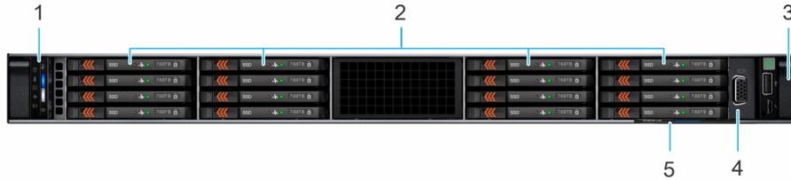
**Ilustración 5. Vista frontal de un sistema de 16 unidades E3.S**
