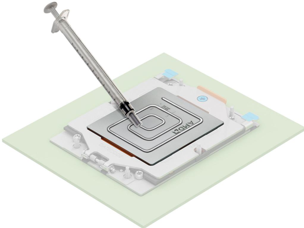
**Ilustración 105. Aplicación de la grasa térmica**
