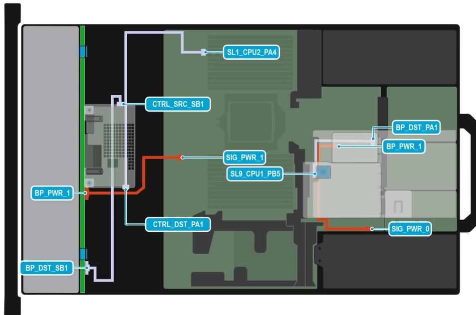
**Ilustración 79. Configuración 4-11: 10 RAID SAS4/SATA de 2,5 pulgadas con 2 x E3 posteriores. S G5x4 (con FPERC 11)**
