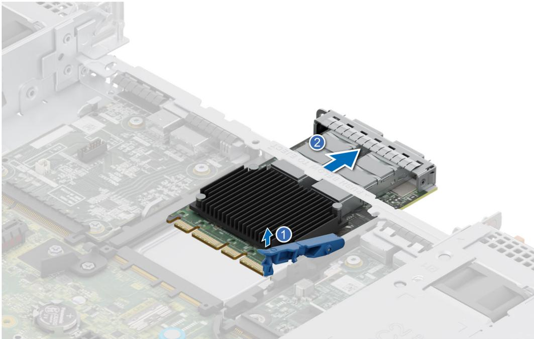
Ilustración 157. Extracción de la tarjeta OCP
