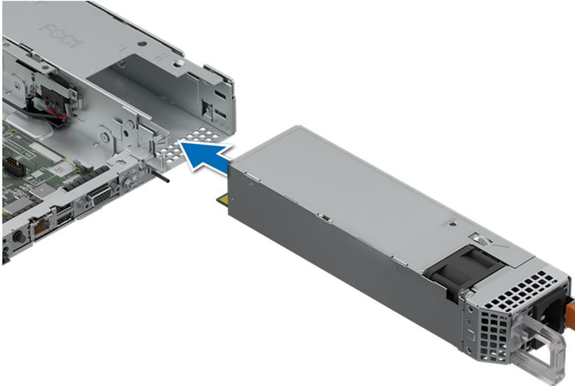
**Ilustración 166. Instalación de una fuente de alimentación**
