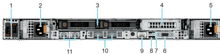
**Ilustración 7. Vista posterior del sistema con módulo de unidades posterior de 2 x 2,5 pulgadas**
