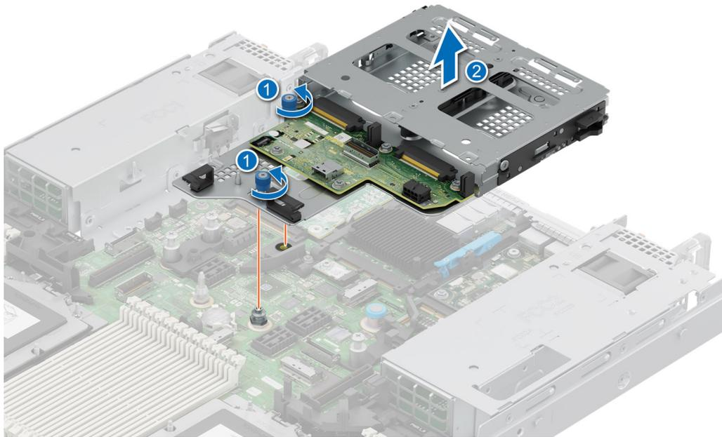
**Ilustración 49. Extracción de la HDD posterior**
