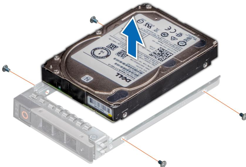
**Ilustración 45. Extracción de una unidad del portaunidades**
