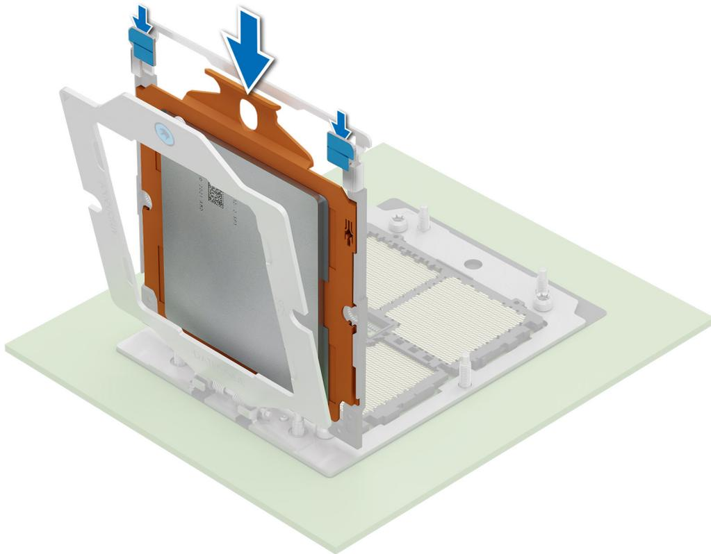
**Ilustración 102. Colocación de la trama del portaunidades en la trama de la guía**
