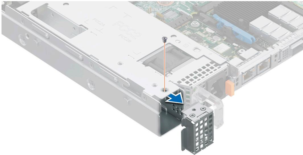
Ilustración 139. Extracción del módulo de BOSS-N1 de relleno
