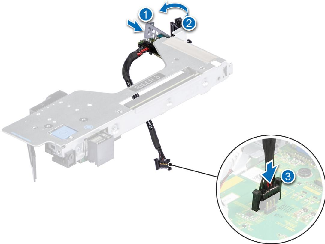
**Ilustración 134. Instalación del puerto serie COM**
