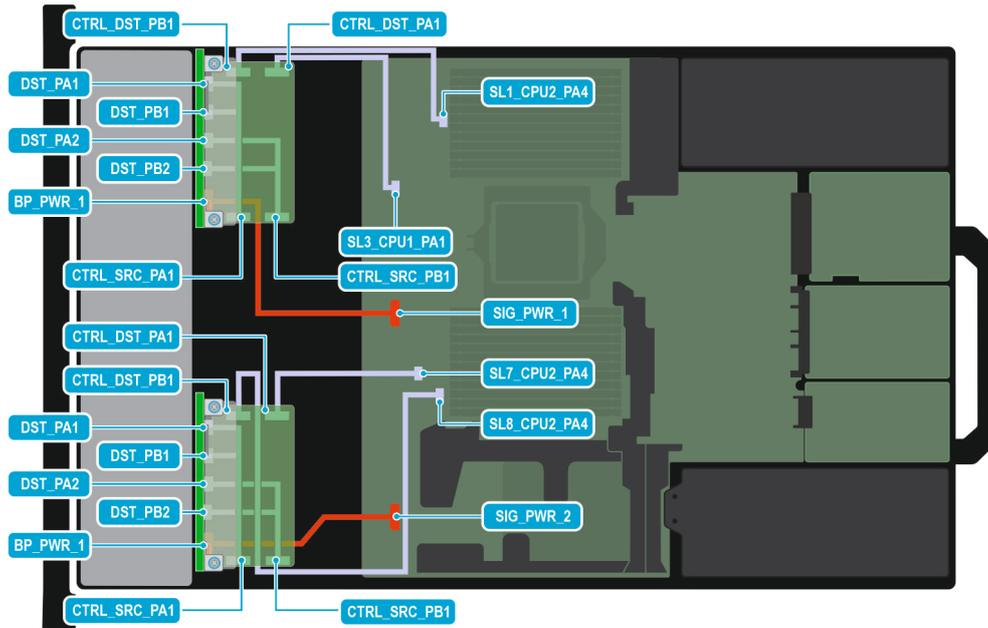
**Ilustración 83. Configuración 6-2: 16 x E3. S G5x4 RAID doble**
