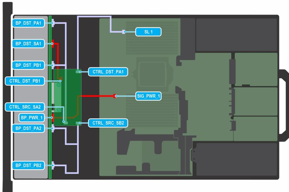
**Ilustración 70. Configuración 3-2: 8 NVMe RAID (con FPERC11 N) de 2,5 pulgadas**
