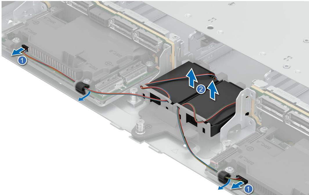
**Ilustración 88. Extracción de la batería de la PERC**
