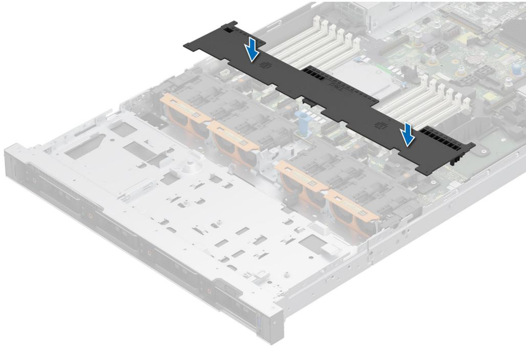
**Ilustración 34. Instalación de la cubierta para flujo de aire**
