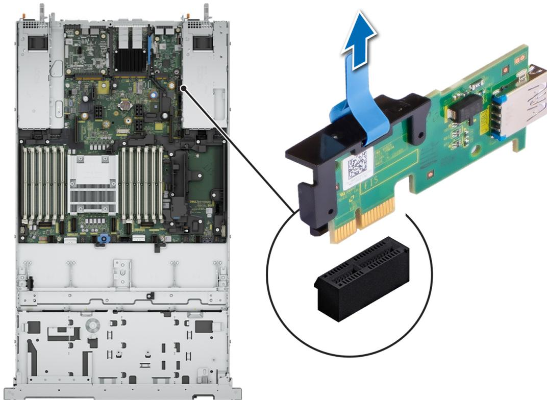
**Ilustración 26. Internal USB Port Puerto USB interno**
