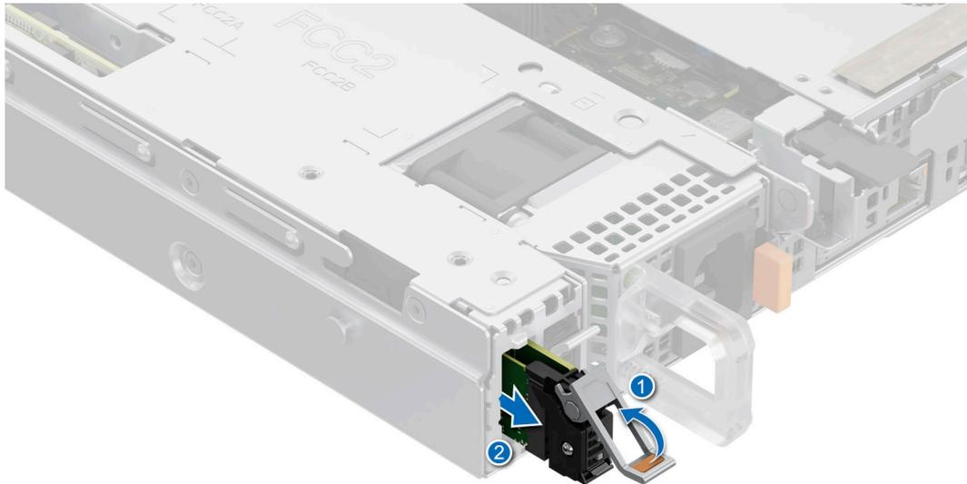
**Ilustración 143. Extracción del portaunderes de tarjeta BOSS-N1**
