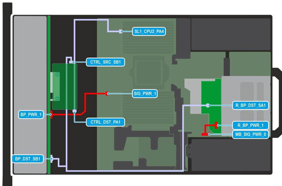
**Ilustración 76. Configuración 4-5: 10 SAS4/SATA RAID de 2,5 pulgadas con posterior de 2 x 2,5 pulgadas (con FPERC11)**
