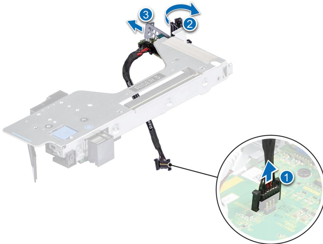
**Ilustración 133. Extracción del puerto serial de COM**
