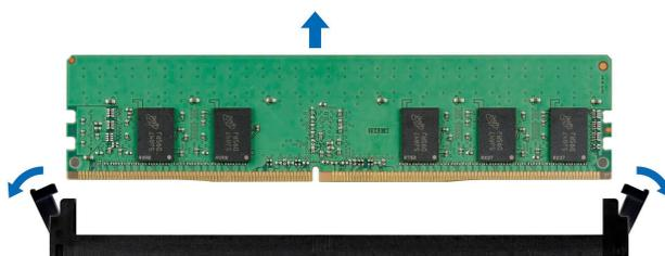
Ilustración 95. Extracción de un módulo de memoria
