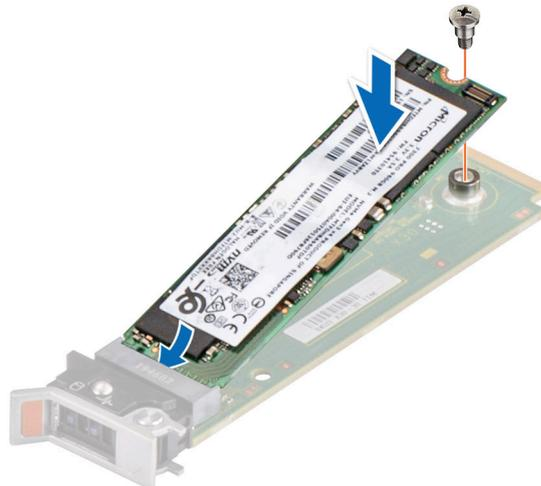
**Ilustración 149. Instalación de la SSD M.2**
