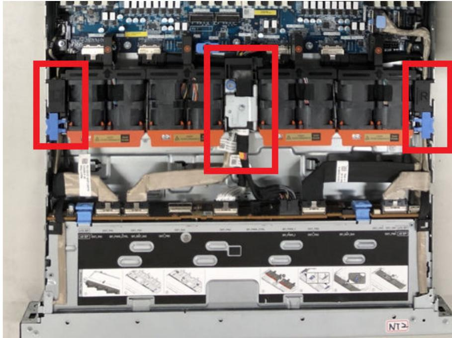
**Ilustración 64. Soportes derecho, izquierdo y central**
