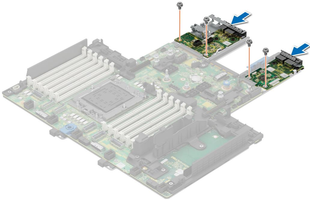
**Ilustración 173. Instalación de la tarjeta LOM y la placa de I/O posterior de enfriamiento con líquido**
