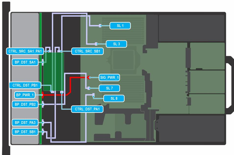
**Ilustración 75. Configuración 4-4: 10 x 2,5 pulgadas con 4 x Uni G4 (con FPERC12)**
