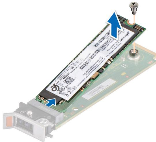
**Ilustración 144. Extracción de la SSD M.2**
