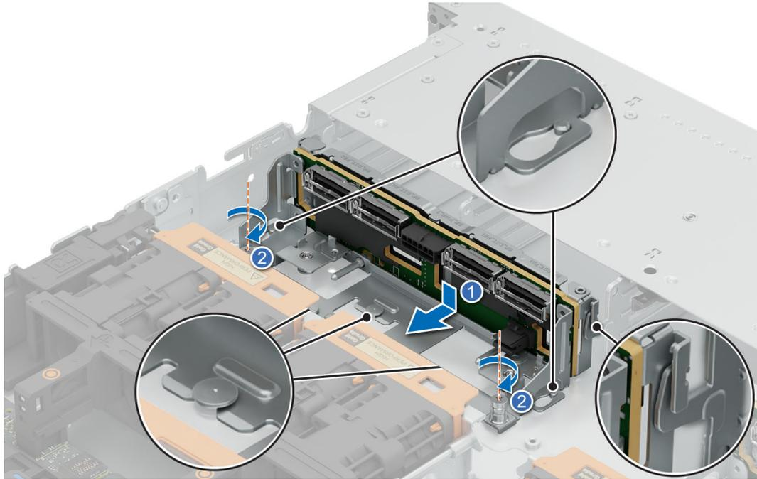
**Ilustración 63. Instalación del backplane de 16 unidades E3.S**
