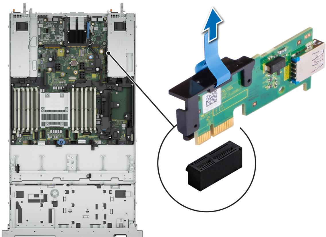
Ilustración 153. Extracción de la tarjeta USB interna
