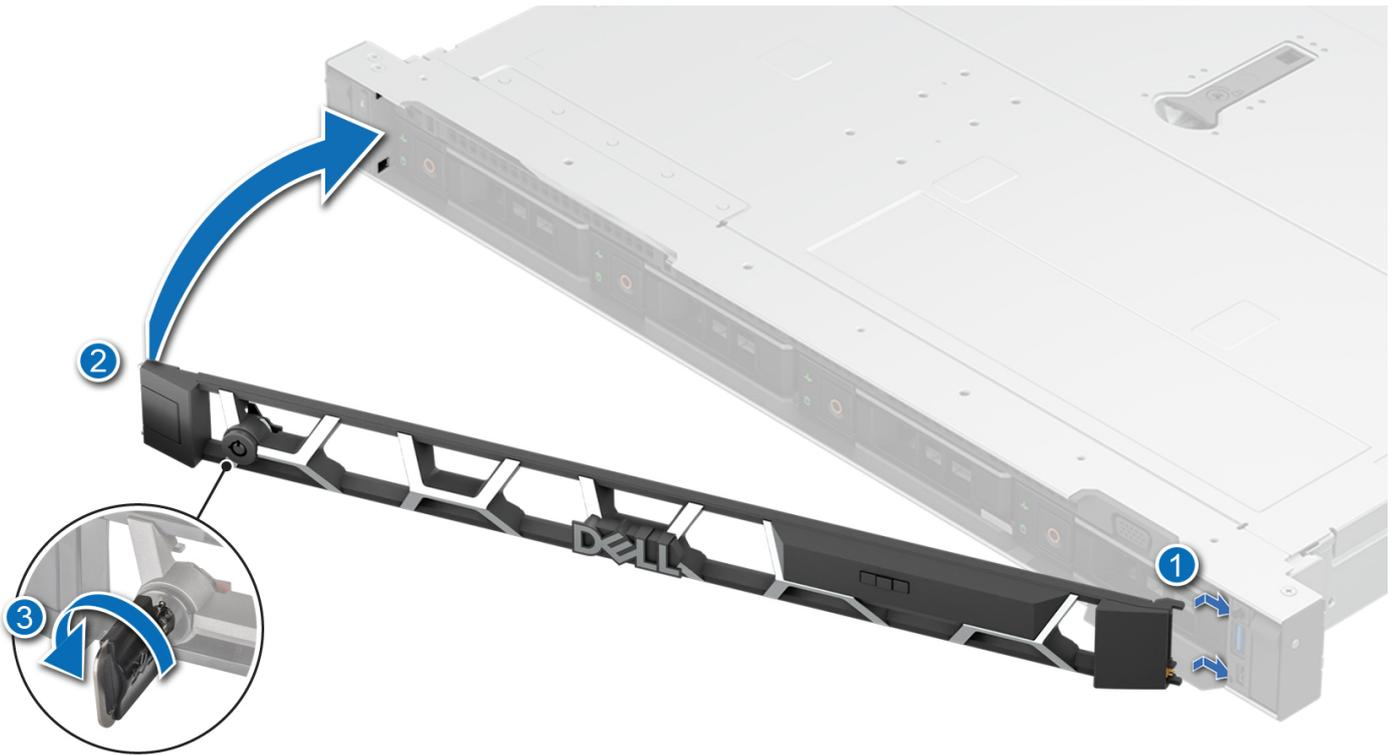
Ilustración 28. Instalación del bisel frontal
