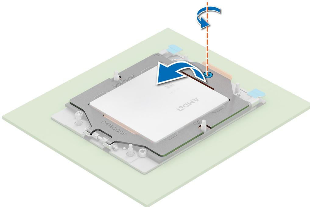
**Ilustración 99. Extracción de los tornillos de la trama de retención**
