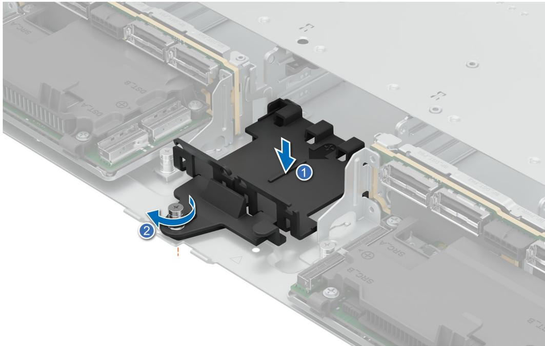
**Ilustración 93. Instalación de la bandeja de la batería de la PERC**
