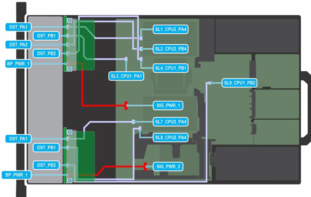
**Ilustración 82. Configuración 5-3: 14 x E3. S G5x4**
