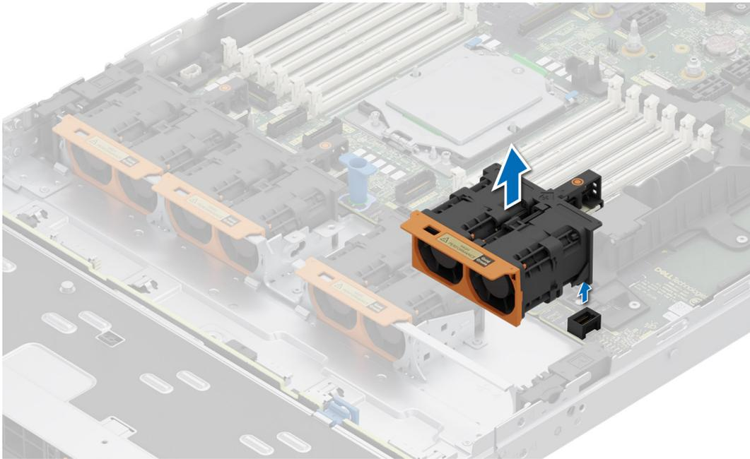
**Ilustración 35. Extracción de un ventilador**
