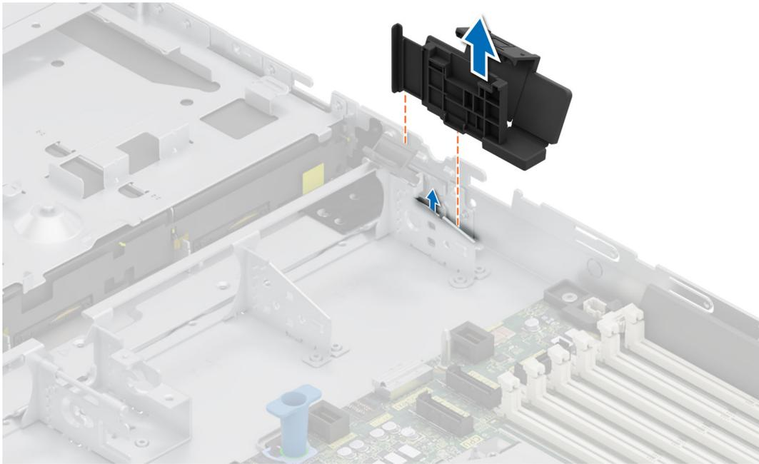
**Ilustración 65. Extracción del soporte de pared lateral**
