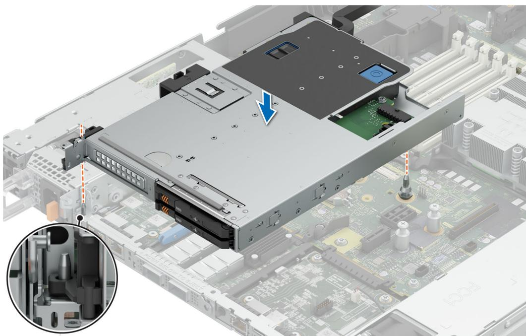
**Ilustración 52. Instalación del módulo de E3.S posteriores**
