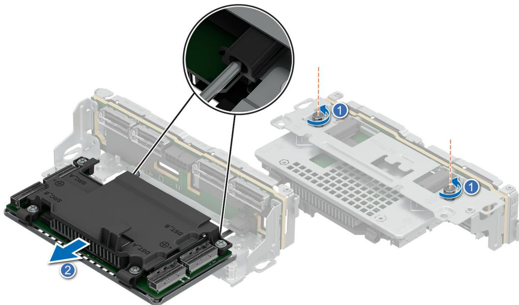
**Ilustración 89. Extracción del módulo de PERC H965**
