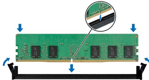
Ilustración 96. Instalación de un módulo de memoria
