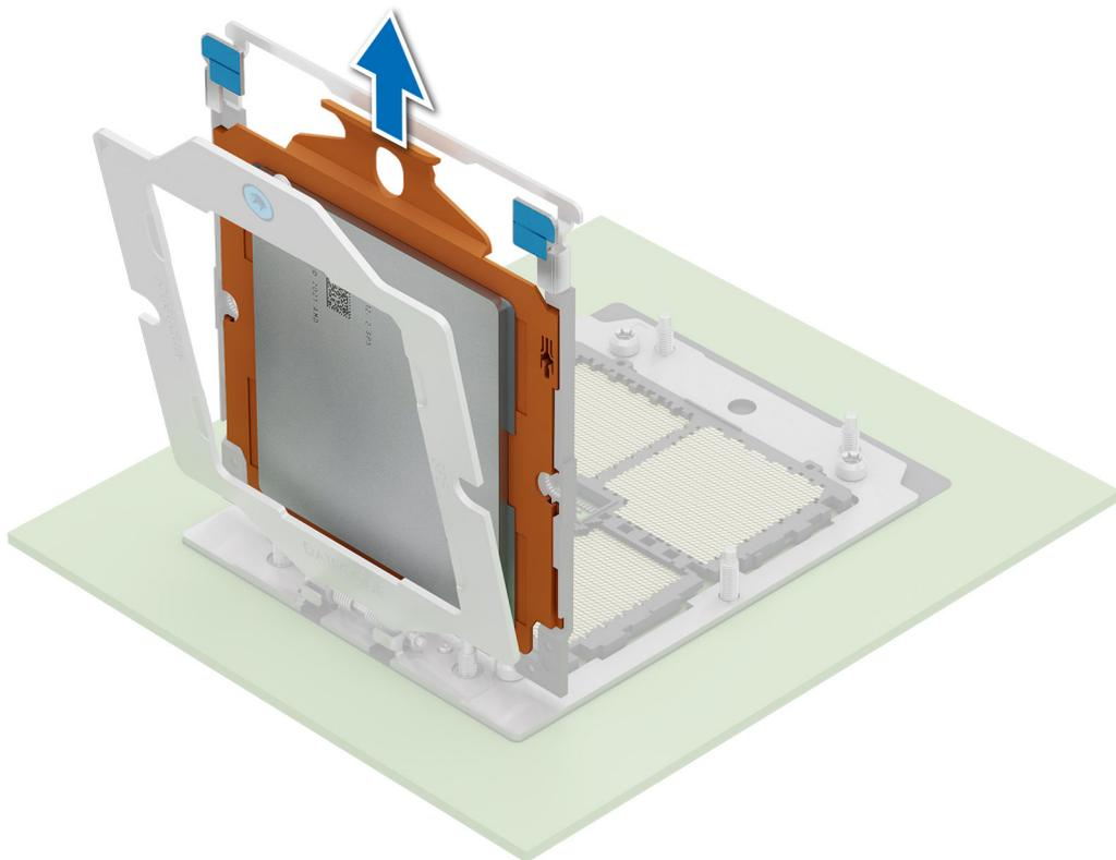
**Ilustración 101. Extracción de la trama del portaunidades**
