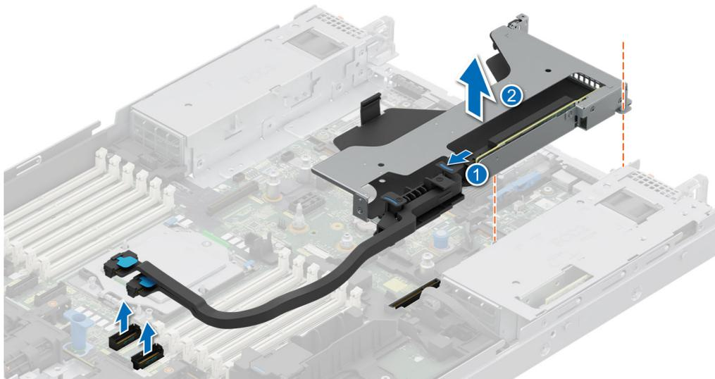
Ilustración 117. Extracción de la tarjeta elevadora para tarjetas de expansión 1
