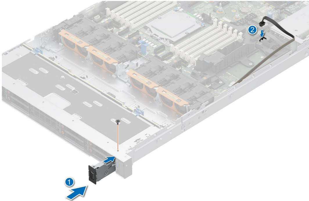
**Ilustración 136. Instalación del módulo de VGA**
