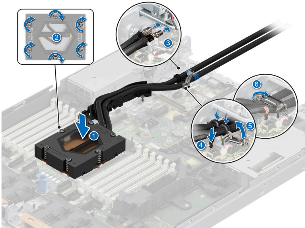
**Ilustración 107. Instalación del módulo de DLC**
