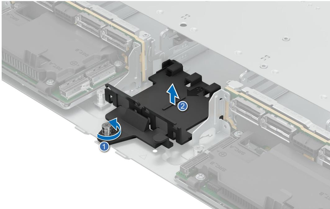
**Ilustración 90. Extracción de la bandeja de la batería de la PERC**
