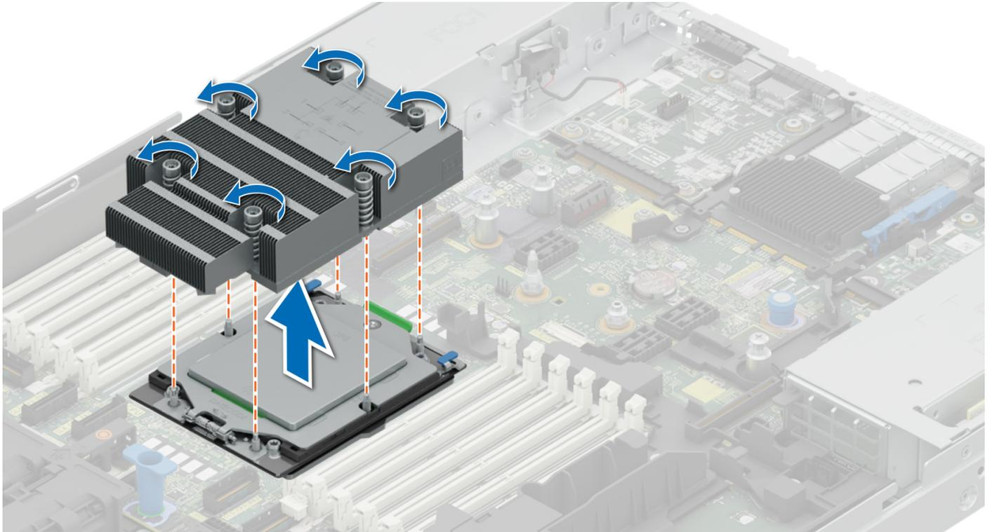
Ilustración 97. Extracción de un disipador de calor
