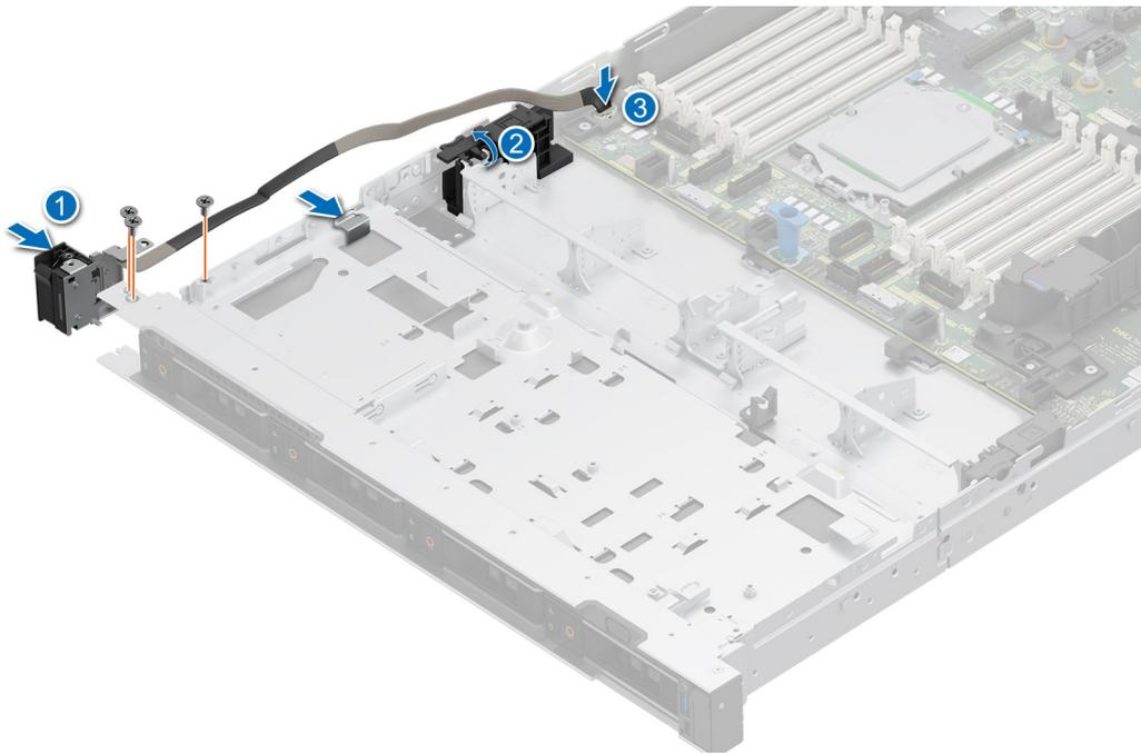
**Ilustración 162. Instalación del panel de control izquierdo**
