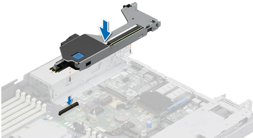
**Ilustración 127. Instalación de la tarjeta elevadora para tarjetas de expansión 3**
