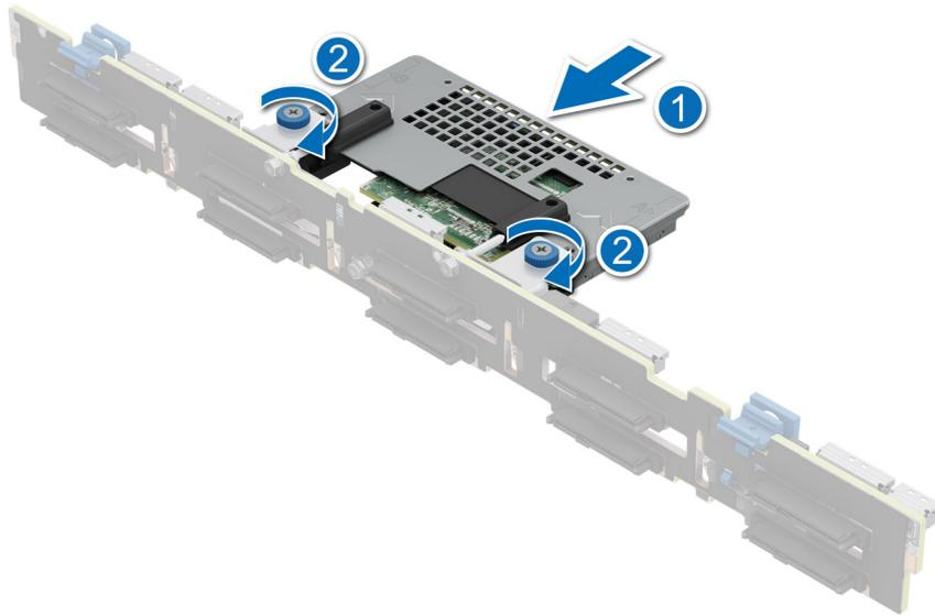
**Ilustración 87. Instalación del módulo de PERC frontal de montaje posterior**
