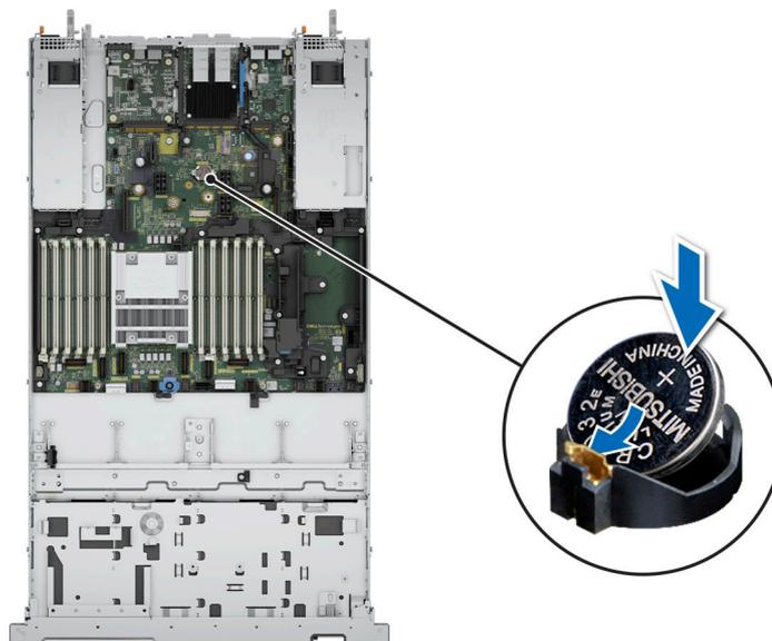
**Ilustración 152. Instalación de la batería del sistema**
