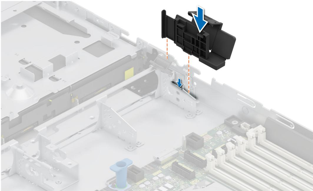
**Ilustración 66. Instalación del soporte de pared lateral**
