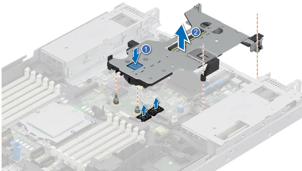
Ilustración 118. Extracción de la tarjeta elevadora para tarjetas de expansión 2
