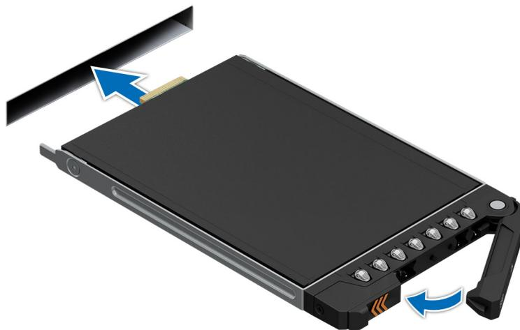
Ilustración 44. Instalación de una unidad E3.S
