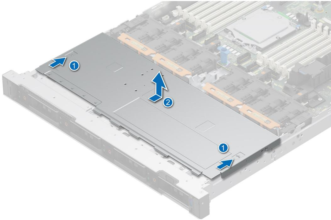
**Ilustración 31. Extracción de la cubierta del backplane de la unidad**
