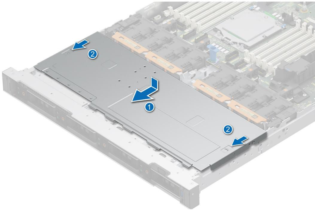
**Ilustración 32. Instalación de la cubierta del backplane de la unidad**
