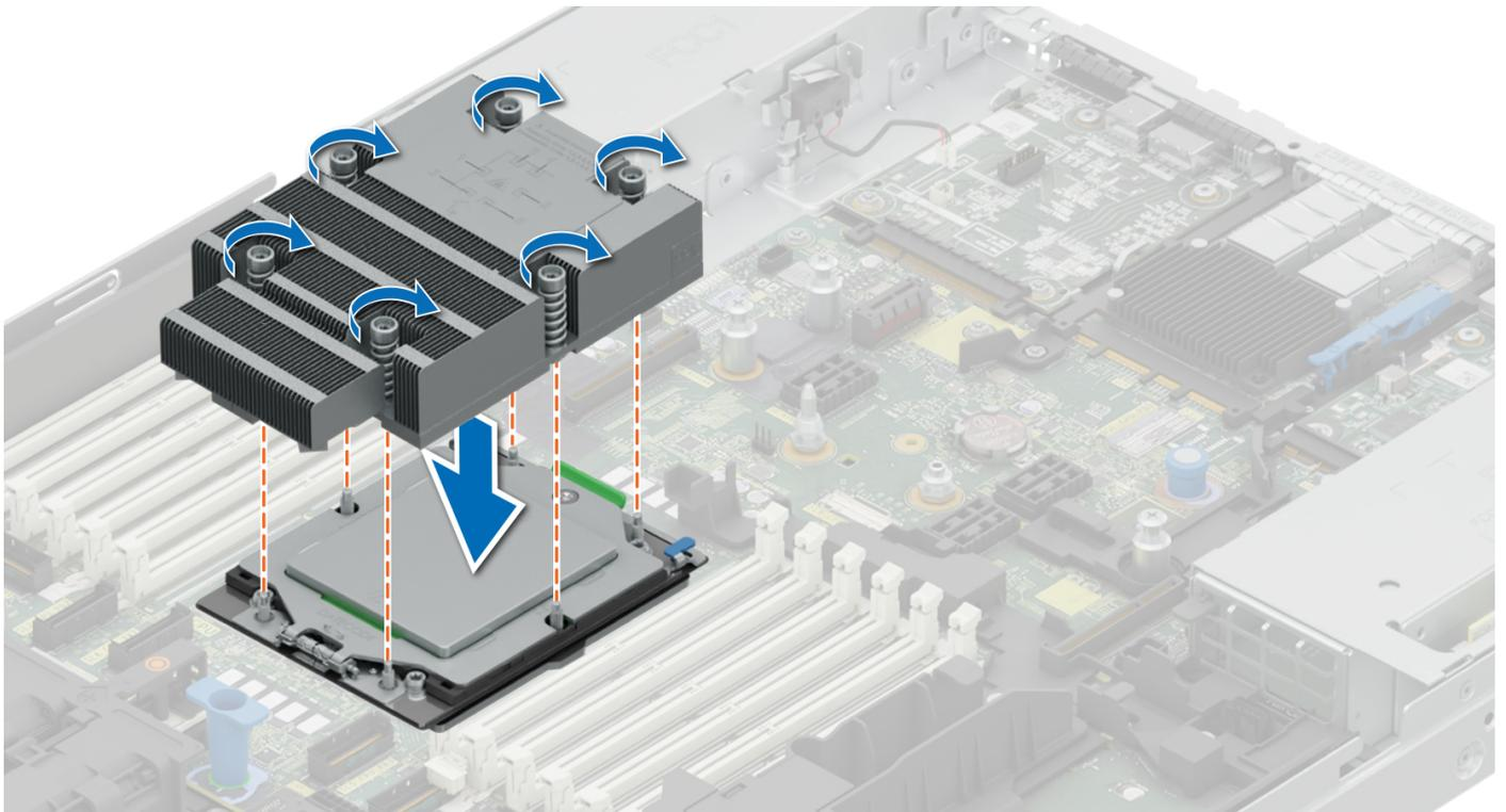
**Ilustración 106. Instalación del disipador de calor**
