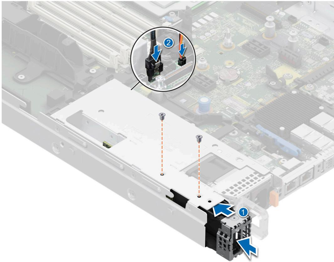
**Ilustración 148. Instalación del módulo de BOSS-N1**
