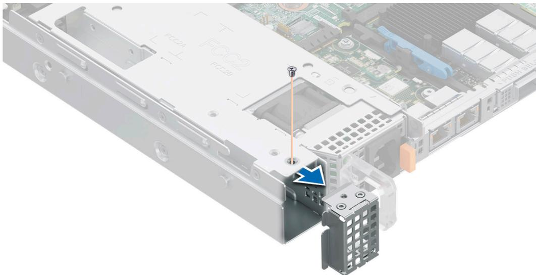
**Ilustración 174. Extracción del módulo de BOSS-N1 de relleno**
