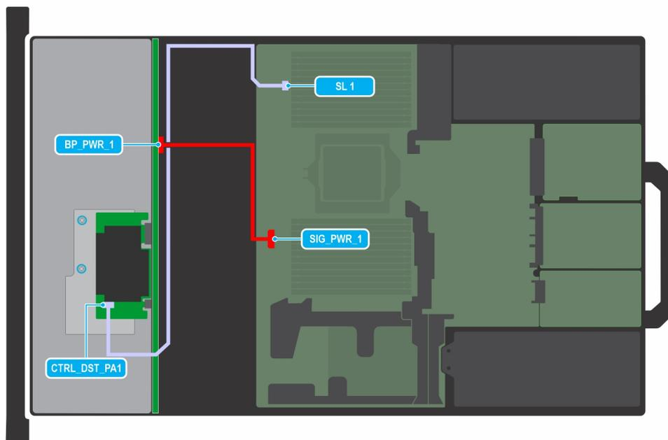
**Ilustración 67. Configuración 1-1: 4 RAID SAS3/SATA de 3,5 pulgadas**
