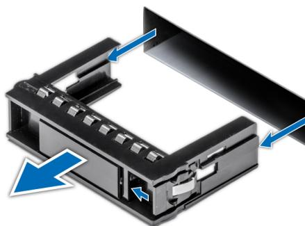
**Ilustración 37. Extracción de una unidad de relleno**
