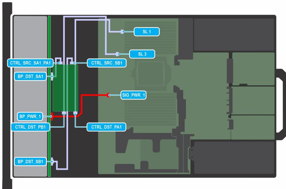
**Ilustración 73. Configuración 4-2: 10 SAS4/SATA RAID de 2,5 pulgadas (con FPERC12)**
