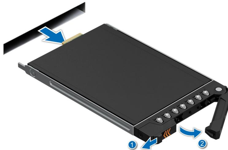
Ilustración 42. Extracción de un portaunidades E3.S
