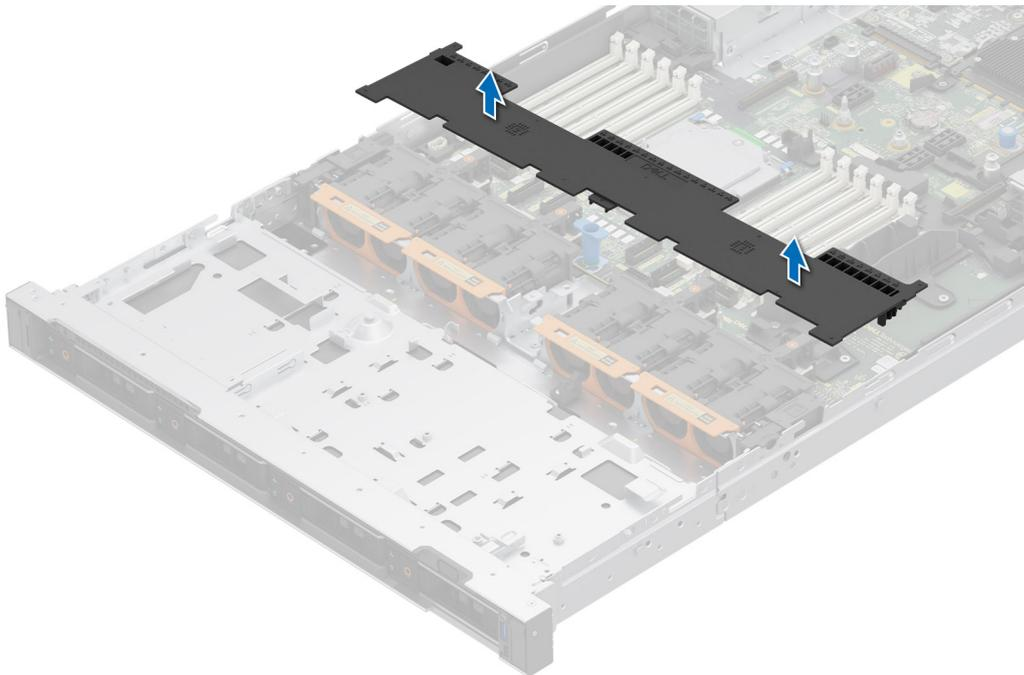
Ilustración 33. Extracción de la cubierta para flujo de aire
