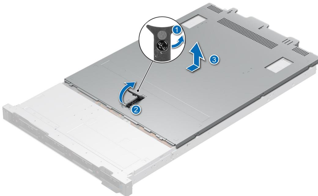
**Ilustración 29. Extracción de la cubierta del sistema**
