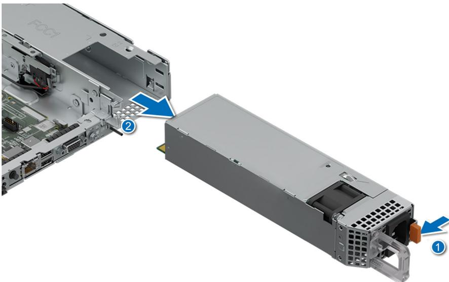
Ilustración 165. Extracción de una fuente de alimentación
