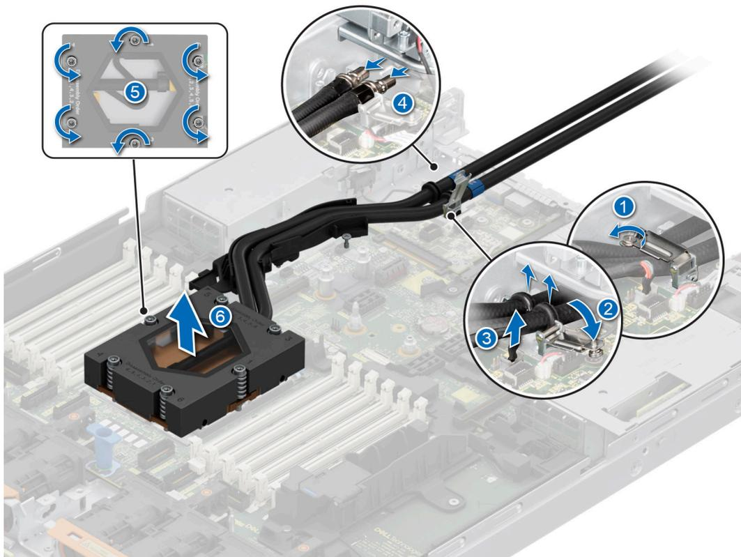
**Ilustración 98. Extracción del módulo DLC**
