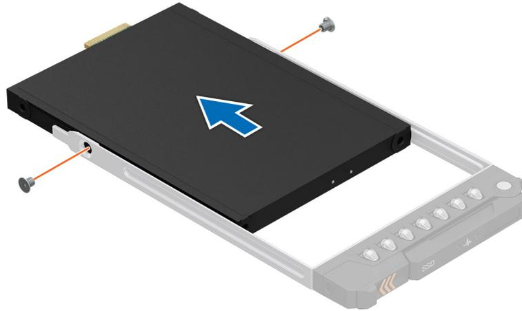
**Ilustración 46. Extracción de la unidad E3.S del portaunidades**
