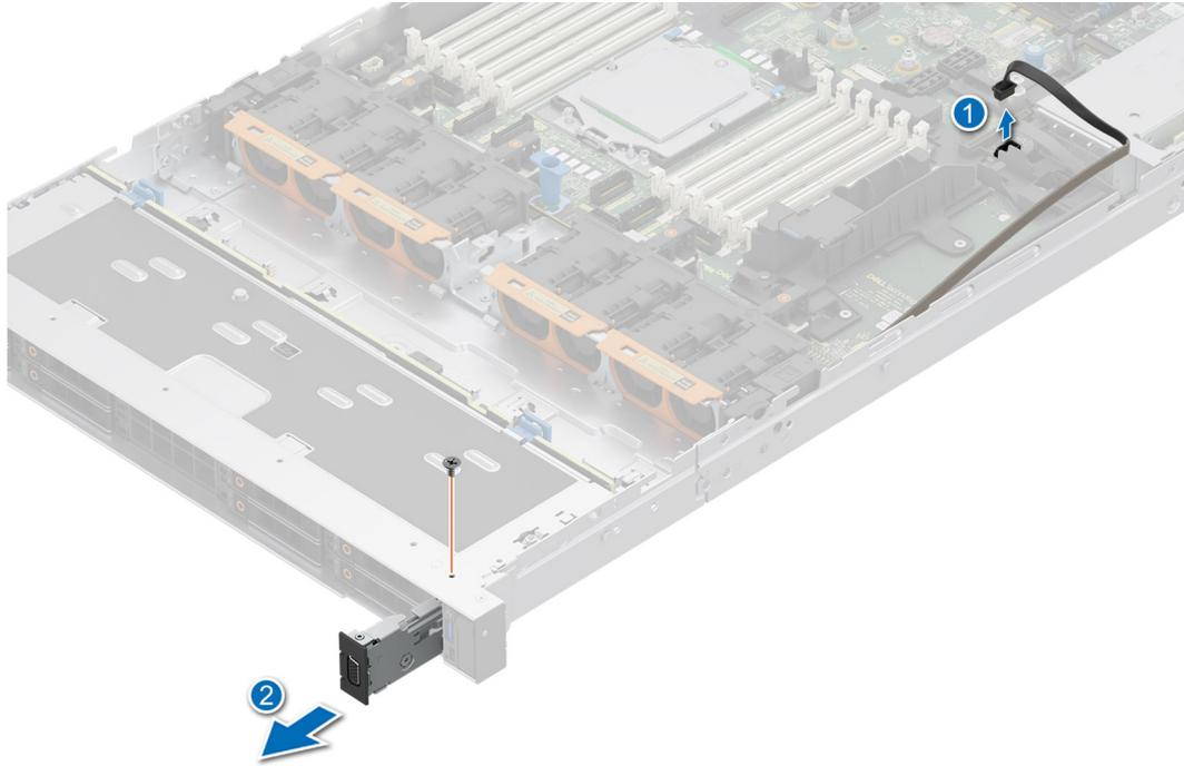
**Ilustración 135. Extracción del módulo VGA**
