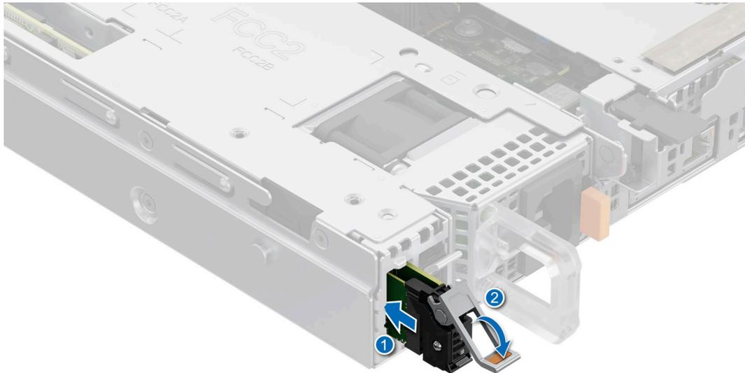
**Ilustración 150. Instalación del portaunidades de tarjeta BOSS-N1**
