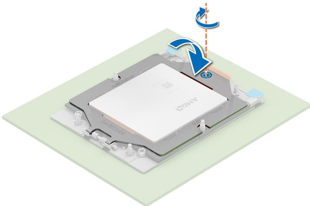
**Ilustración 104. Protección de la trama de retención**
