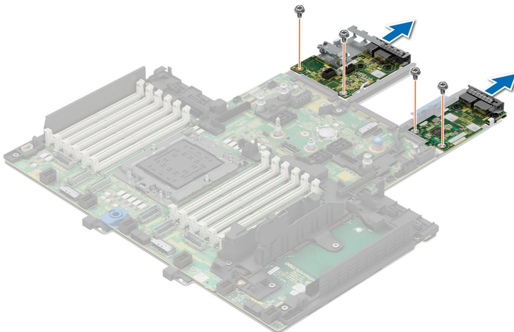
Ilustración 171. Extracción de la tarjeta LOM y la placa de I/O posterior de enfriamiento con líquido
