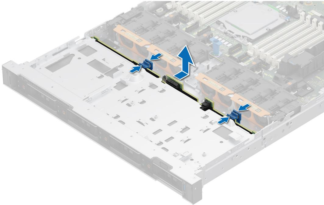
**Ilustración 58. Extracción del backplane de la unidad**
