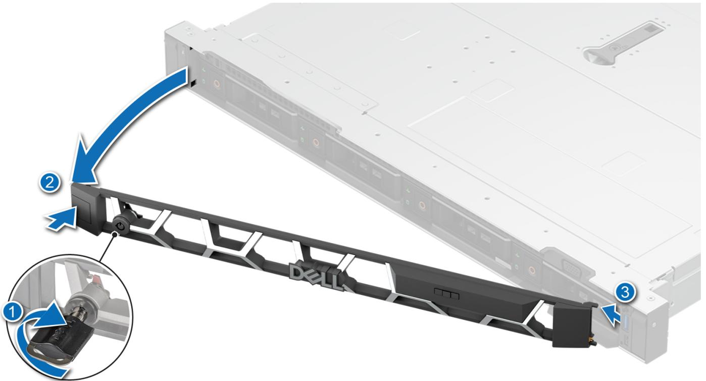
Ilustración 27. Extracción del bisel frontal
