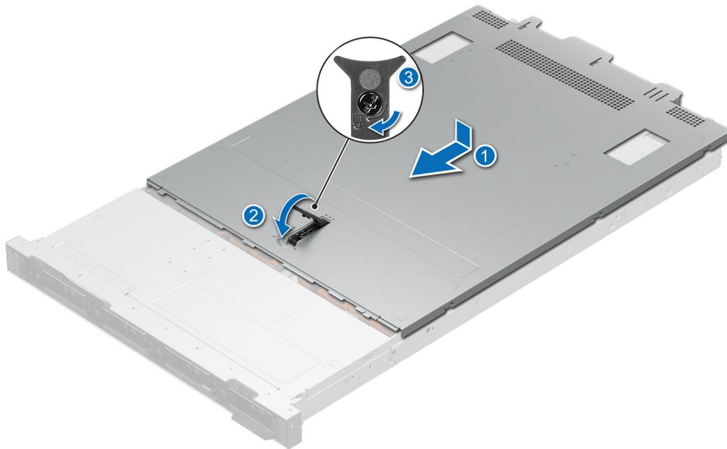
**Ilustración 30. Instalación de la cubierta del sistema**
