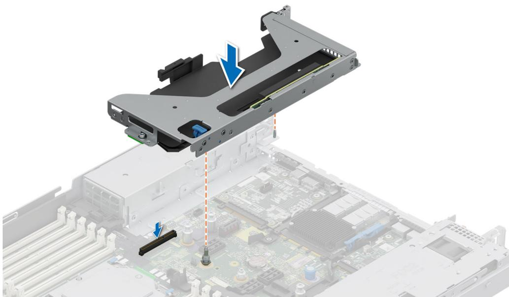
**Ilustración 128. Instalación de la tarjeta elevadora de expansión 4**
