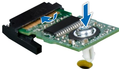
Figure 167. Installation du module TPM
