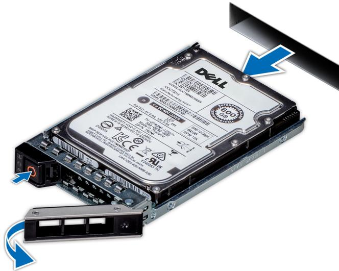
Figure 41. Retrait d'un support de disque
