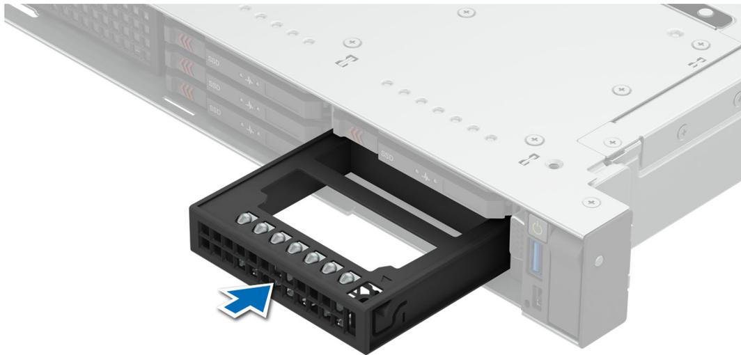
Figure 40. Installation d'un cache de disque E3.S
