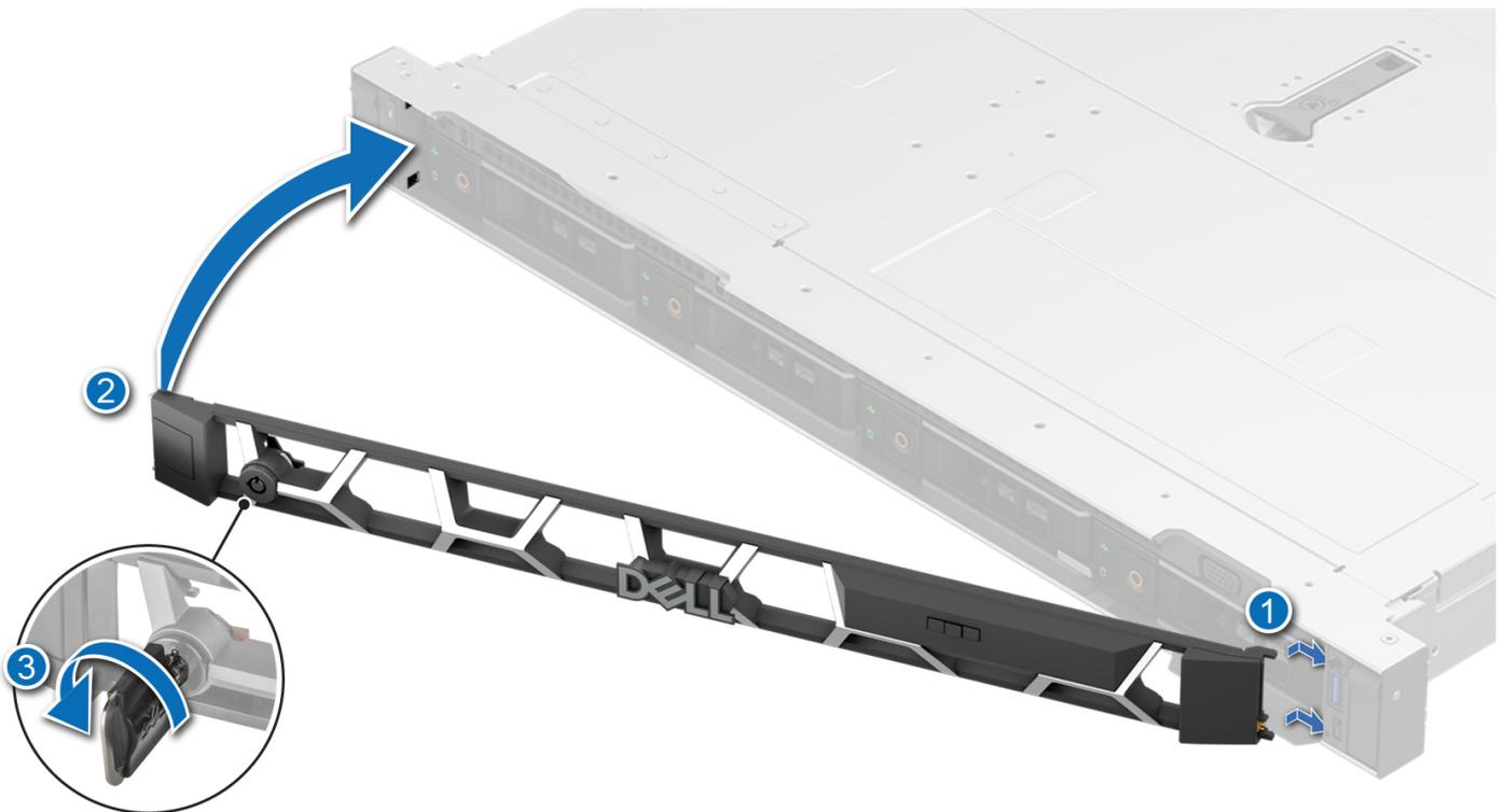
Figure 28. Installation du panneau avant
