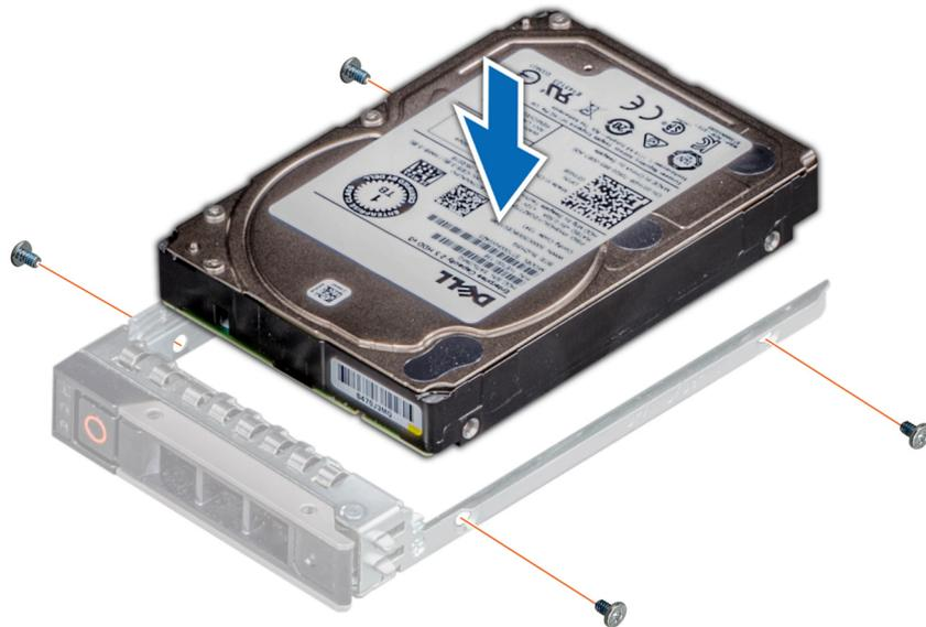
Figure 47. Installation d'un disque dans un support de disque
