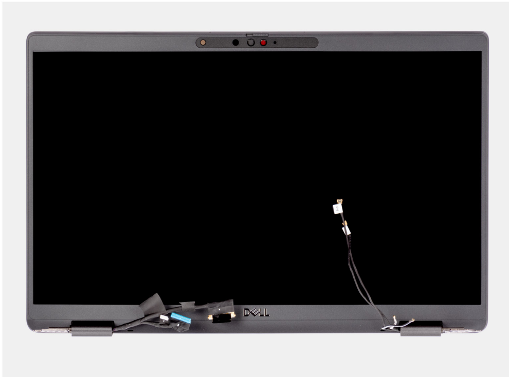
Figur 3. Bildskärmsenhet med WWAN-antennkablar
