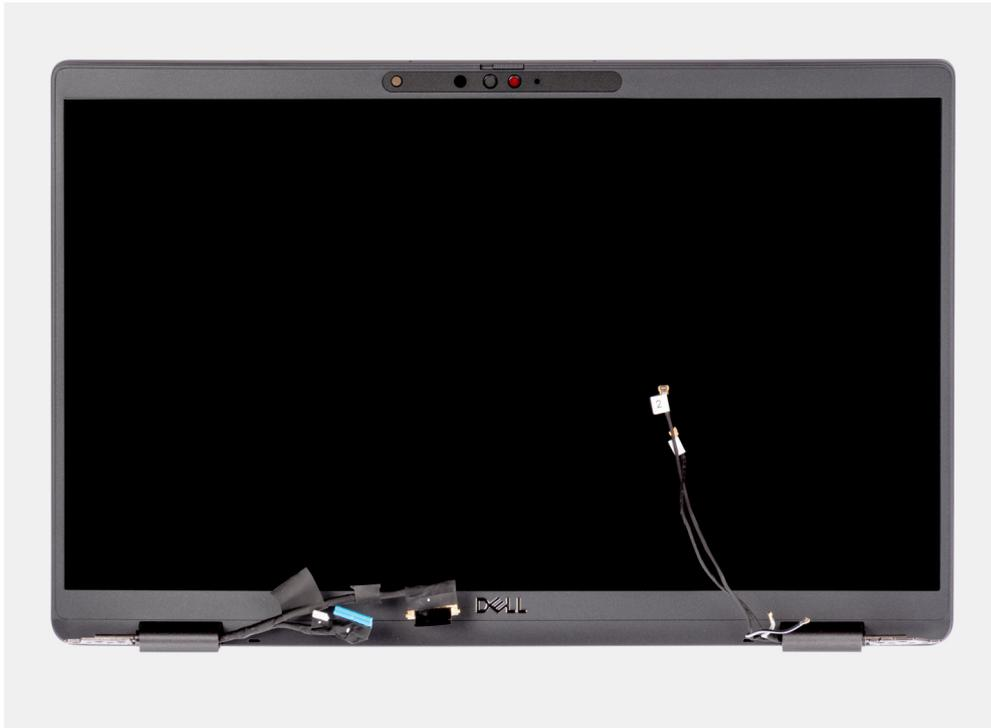
**Figura 3. Gruppo del display con cavi dell'antenna WWAN**
