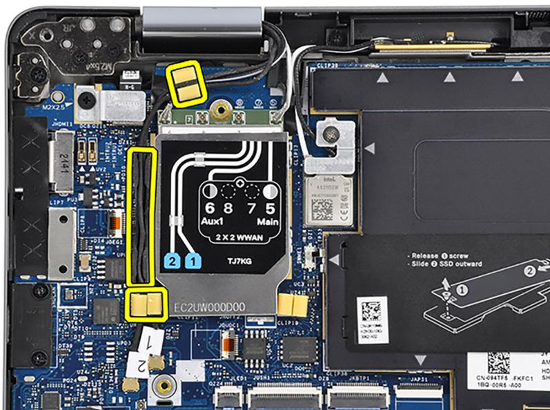
16. Collegare il cavo dell'antenna Darwin n. 1 e il cavo dell'antenna Darwin n. 2 ai connettori rispettivi connettori sulla scheda di sistema.
