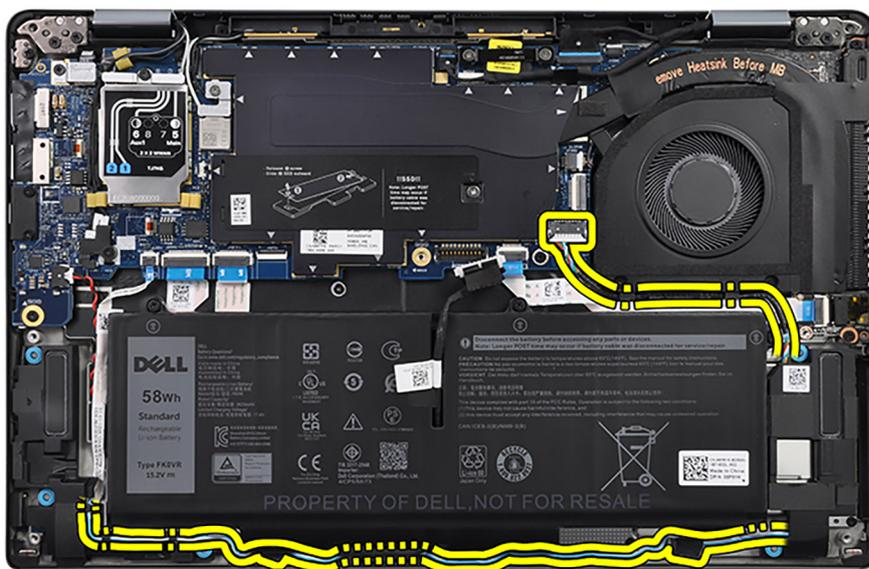
4. Per i sistemi forniti con antenne 5G, collegare il cavo del sensore P e il cavo dell'altoparlante ai rispettivi connettori sulla scheda di sistema.
