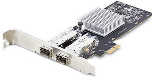
Aggiungete fino a due moduli SFP da 1GbE a uno slot PCI Express (PCIe) 2.0 x1 (o superiore) in una workstation o in un backplane di server, utilizzando questa Scheda di rete SFP a 2 porte.
