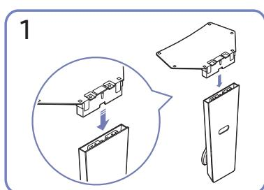
Postavite osnovu postolja na vrat postolja, u pravcu prikazanom na slici. Proverite da li je priključak za postolje čvrsto spojen.
