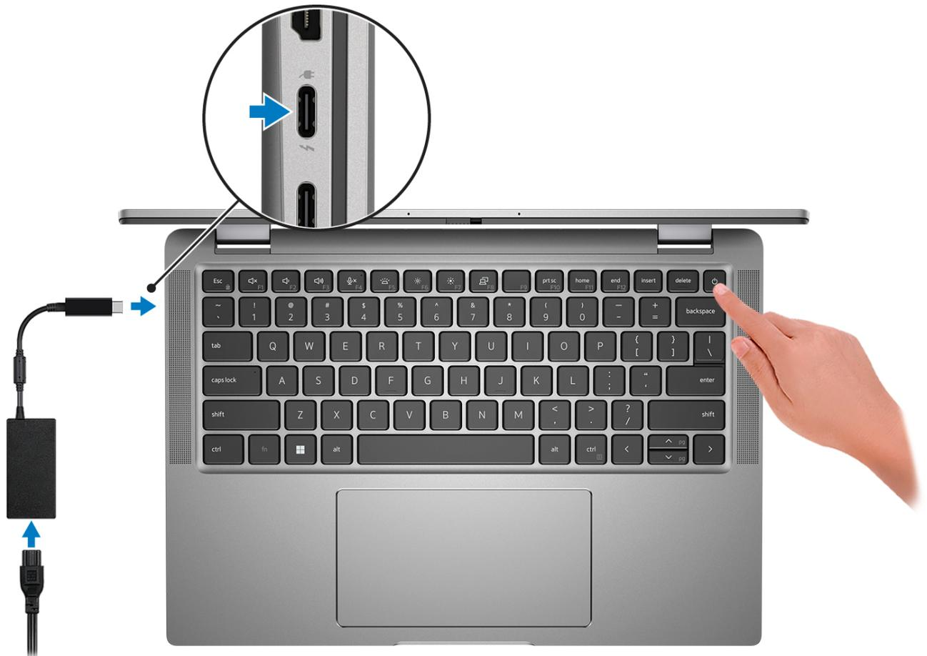
**NOTA:** Para conservar la energía de la batería, es posible que esta ingrese en modo de ahorro energético. Para encender el equipo, conecte el adaptador de alimentación y presione el botón de encendido.
