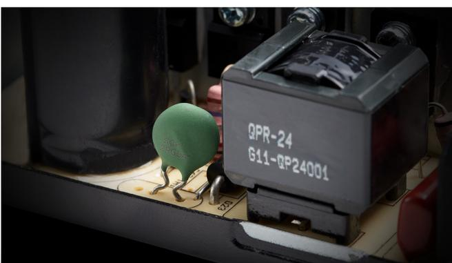
O varistor da XPG PROBE 500 atua como um elemento de controle para proporcionar uma condição operacional ideal e proteger a PSU de tensões transitórias excessivas.
