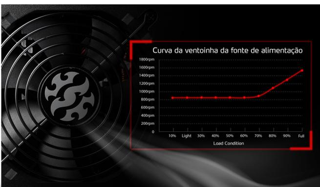
A XPG PROBE 500 BRONZE é equipada com um ventilador de rolamento de 120mm, capaz de manter seu RPM abaixo de 1000 RPM até a condição de 70% de carga. Este design serve para prolongar a expectativa de vida da PSU e garante que o ambiente de operação seja mantido em um nível silencioso de ruído .
