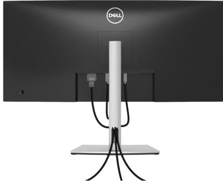
Nachdem Sie sämtliche erforderlichen Kabelverbindungen an Monitor und Computer hergestellt haben (siehe [Monitor anschließen](#) für den Anschluss der Kabel), führen Sie die Kabel wie oben gezeigt ordentlich durch den Kabelschacht.
