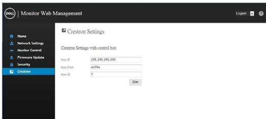
Configura a definição dos dispositivos do sistema de controle da **Crestron**®.
