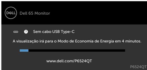
4. Esta caixa também aparece durante a operação normal do sistema, se o cabo de vídeo torna-se desconectado ou danificado
