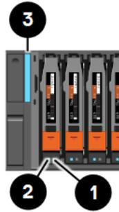
**Figure 2. Boîtier de base et voyants des disques**
