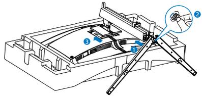
3. Dopo aver fissato la base, sollevare il monitor con entrambe le mani tenendo saldamente il monitor con il polistirolo. Ora è possibile estrarre il polistirolo. Quando si estrae il polistirolo, non schiacciare il pannello per evitare che si rompa.
