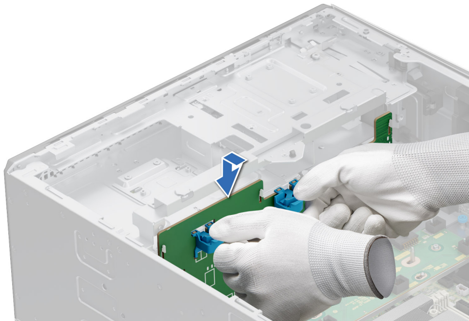
Abbildung 110. Installieren der hinteren 3,5-Zoll-Laufwerkrückwandplatine
