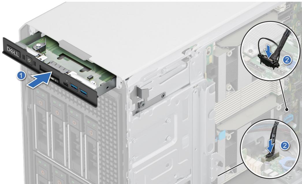
Abbildung 134. Installieren des vorderen I/O-Moduls
