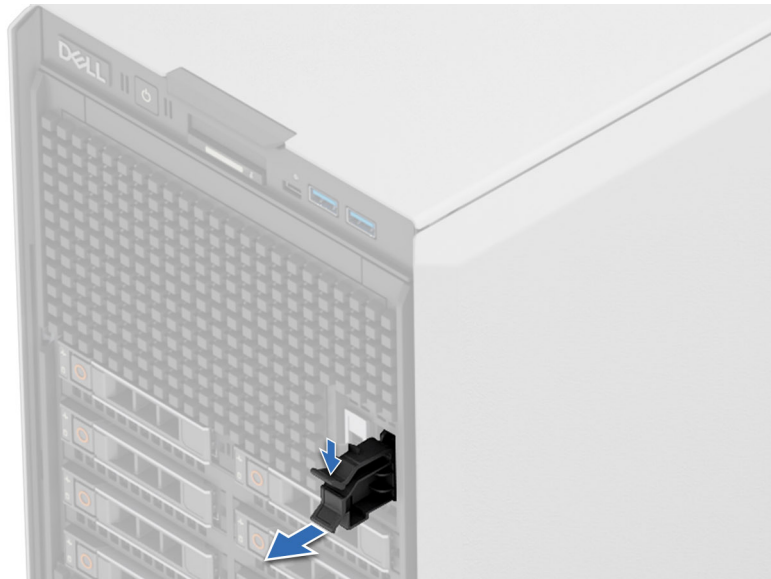
Abbildung 145. Entfernen des Platzhalters für den BOSS-N1-Kartenträger
