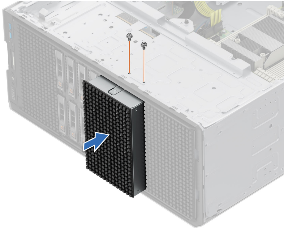
Abbildung 116. Installieren des Laufwerksschacht-Platzhalters
