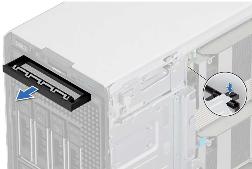
Abbildung 125. Entfernen des Platzhalters für das optische Laufwerk
