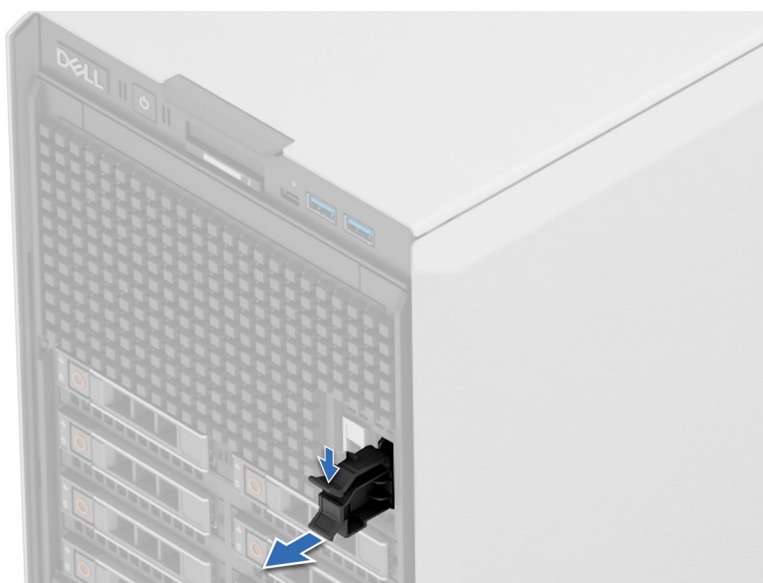
Abbildung 198. Entfernen des Platzhalters für das BOSS-N1-Modul
