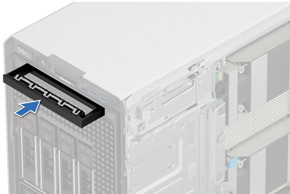
Abbildung 126. Installieren des Platzhalters für das optische Laufwerk
