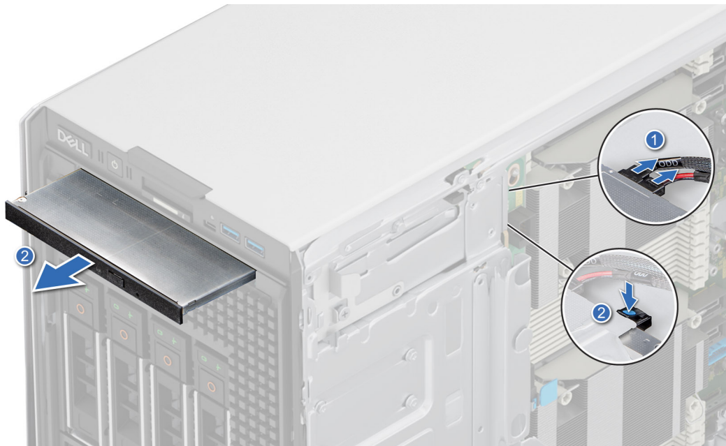
Abbildung 127. Entfernen des optischen Laufwerks
