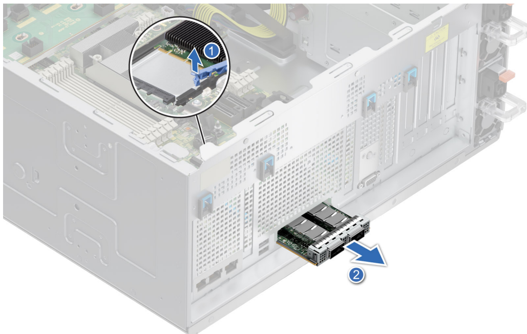
Abbildung 173. Entfernen der OCP-Karte
