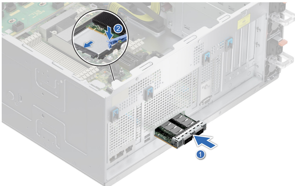
Abbildung 176. Installieren der OCP-Karte
