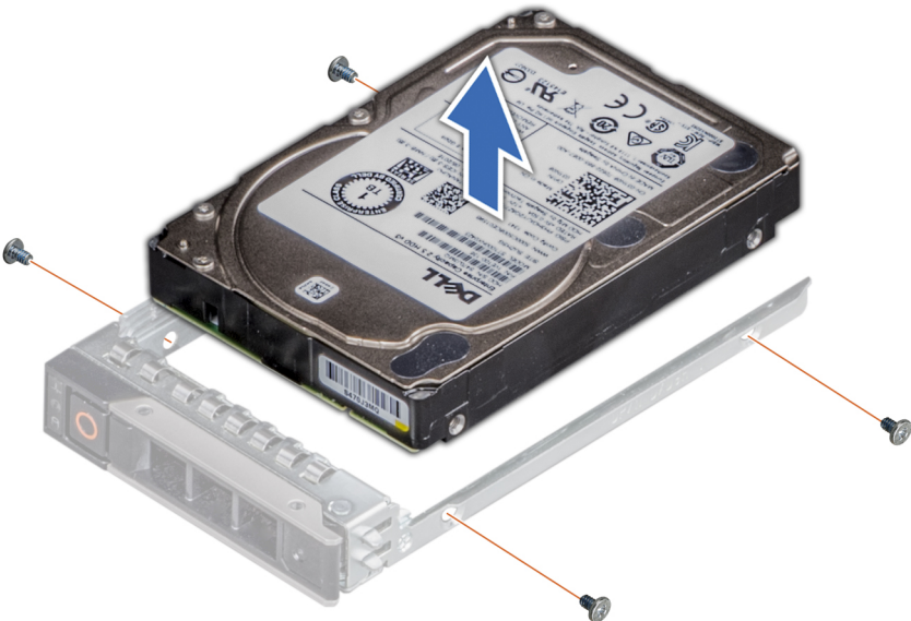
Abbildung 105. Entfernen des Laufwerks aus dem Laufwerkträger
