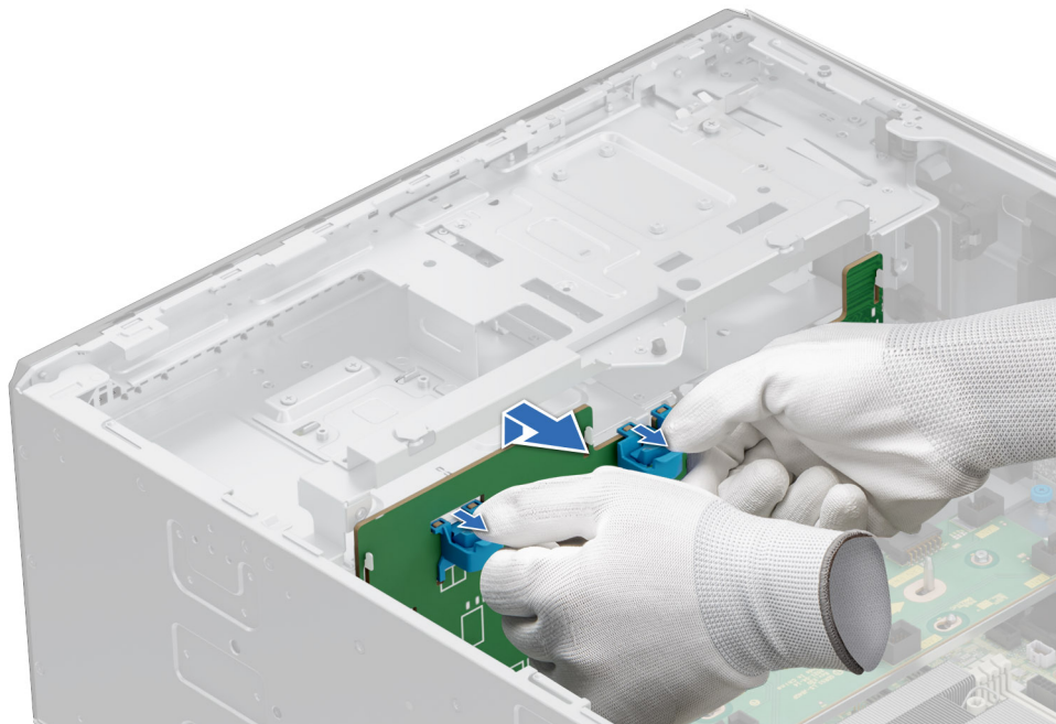
Abbildung 109. Entfernen der 3,5"-Laufwerkrückwandplatte
