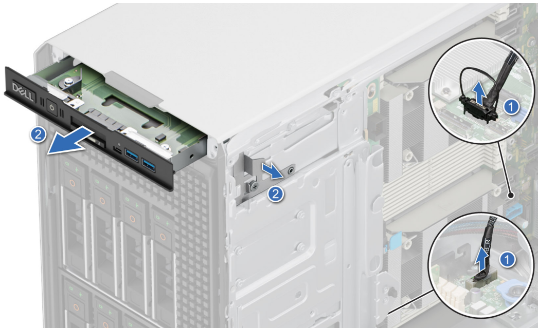
Abbildung 133. Entfernen des vorderen I/O-Moduls
