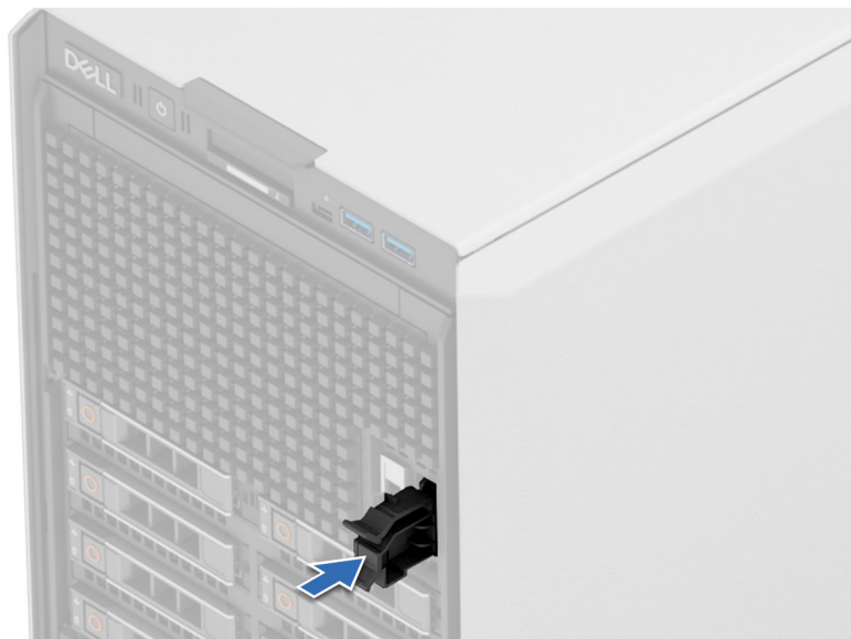
Abbildung 144. Installieren des Platzhalters für den BOSS-N1-Kartenträger
