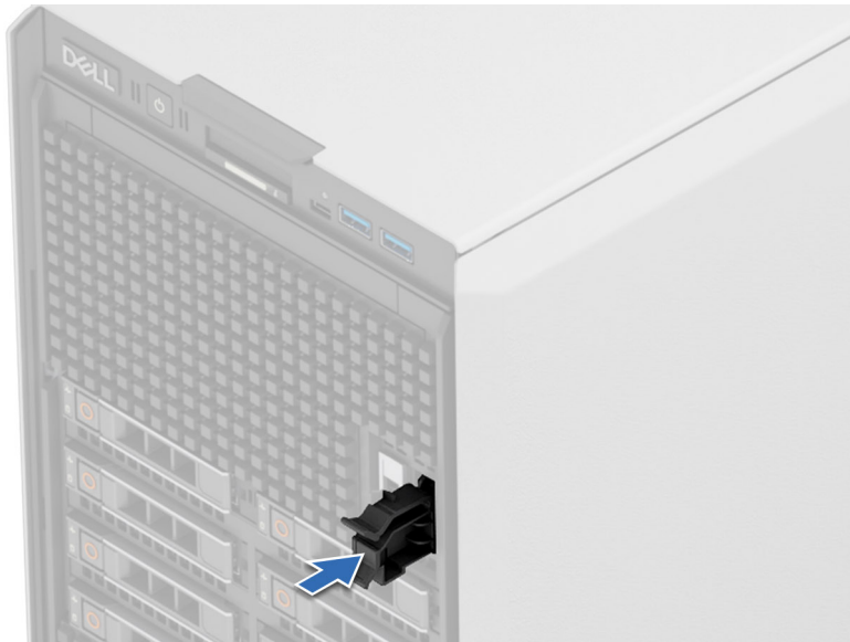
Abbildung 199. Installieren des Platzhalters für das BOSS-N1-Modul
