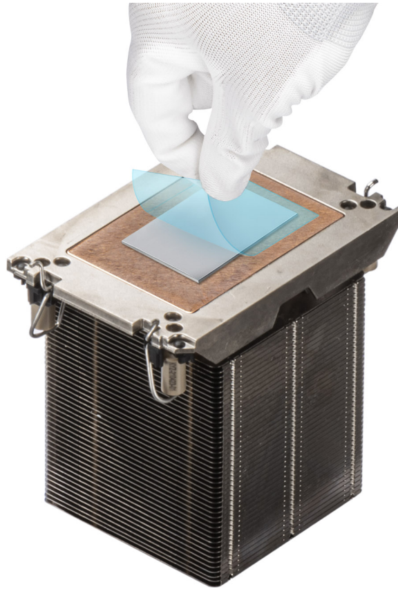
Abbildung 168. Entfernen der TIM-Schutzfolie (Thermal Interface Material)
