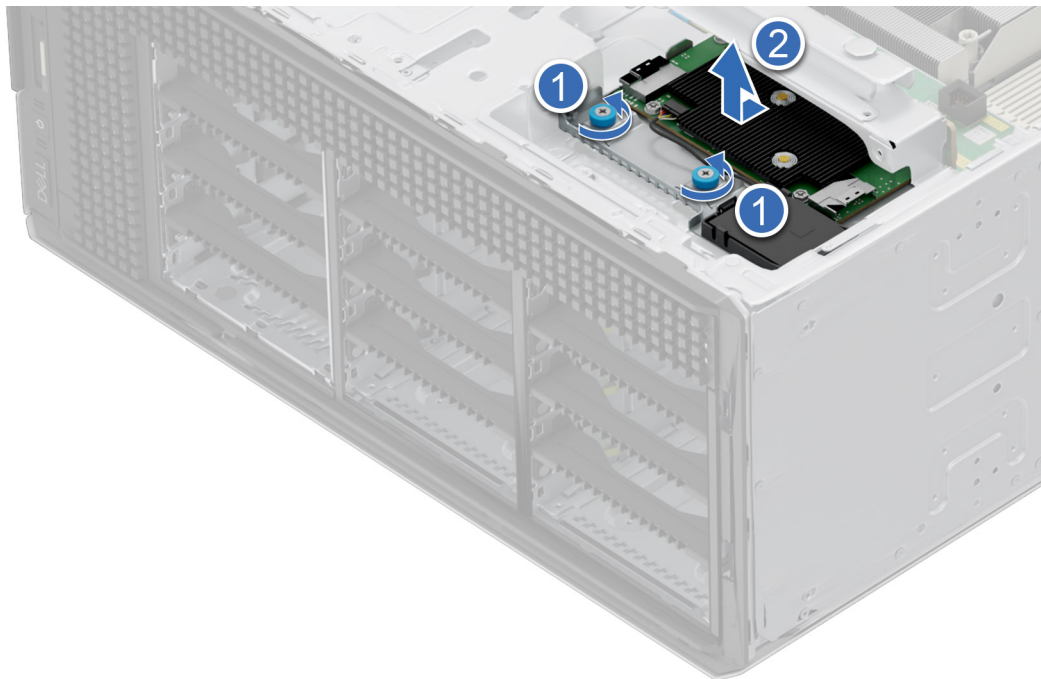
Abbildung 96. Entfernen des fPERC-Moduls von der 3,5"-Laufwerkrückwandplatine
