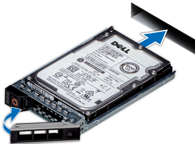
Abbildung 103. Installieren eines Laufwerksträgers
