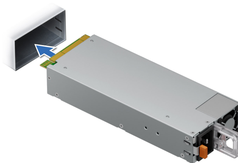
Abbildung 191. Installieren eines 86-mm-Netzteils
