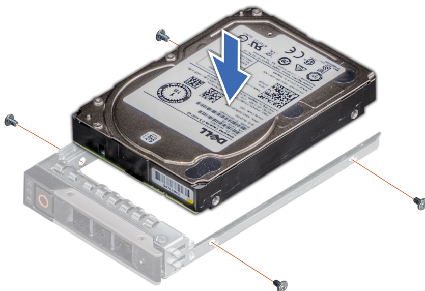
Figure 104. Installation d'un disque dans un support de disque
