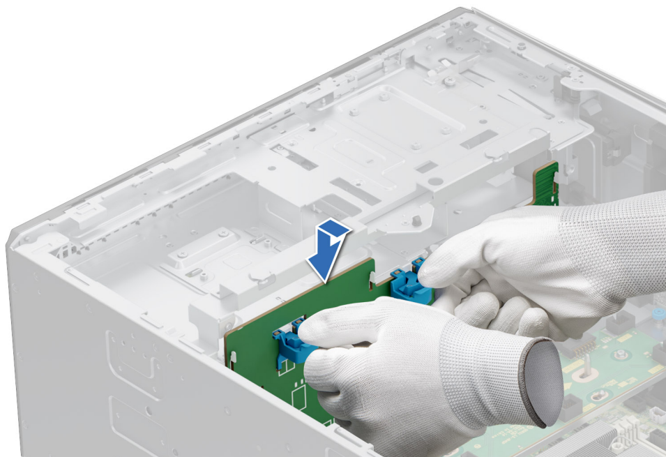
Figure 110. Installation du fond de panier du disque de 3,5 pouces
