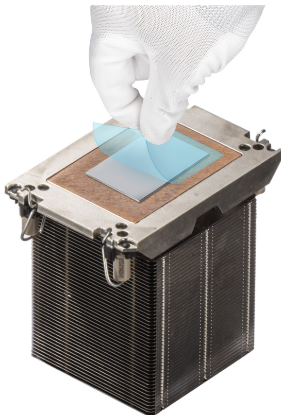
Figure 168. Retrait du film protecteur du matériau d'interface thermique (TIM)
