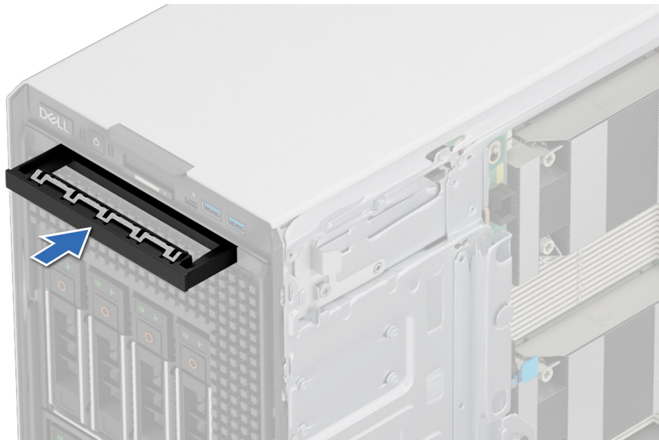
Figure 126. Installation du cache de lecteur optique
