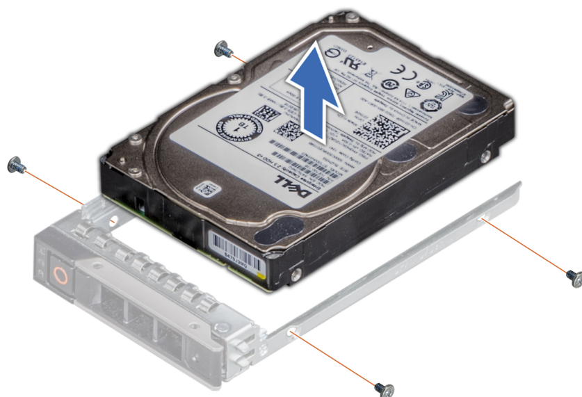
Figure 105. Retrait d'un disque dur installé de son support
