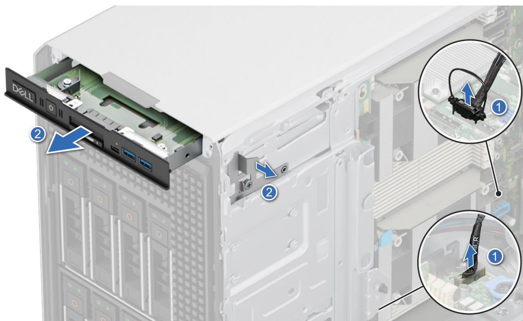
Figure 133. Retrait du module d'E/S avant
