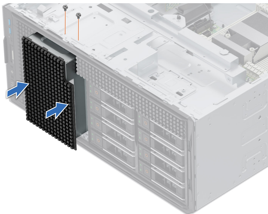
Figure 118. Installation du cache de baie de disques NVMe
