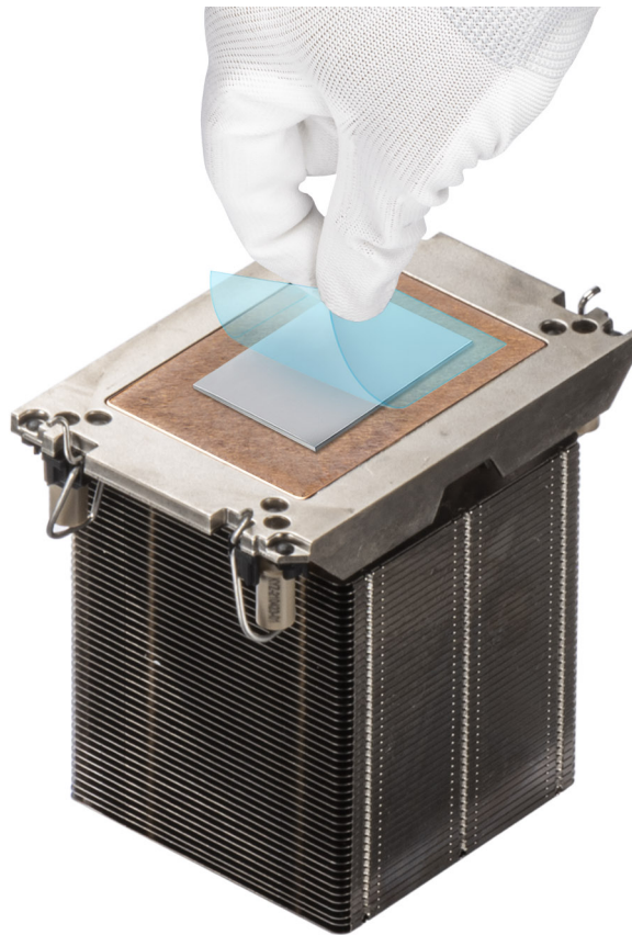
Abbildung 168. Entfernen der TIM-Schutzfolie (Thermal Interface Material)
