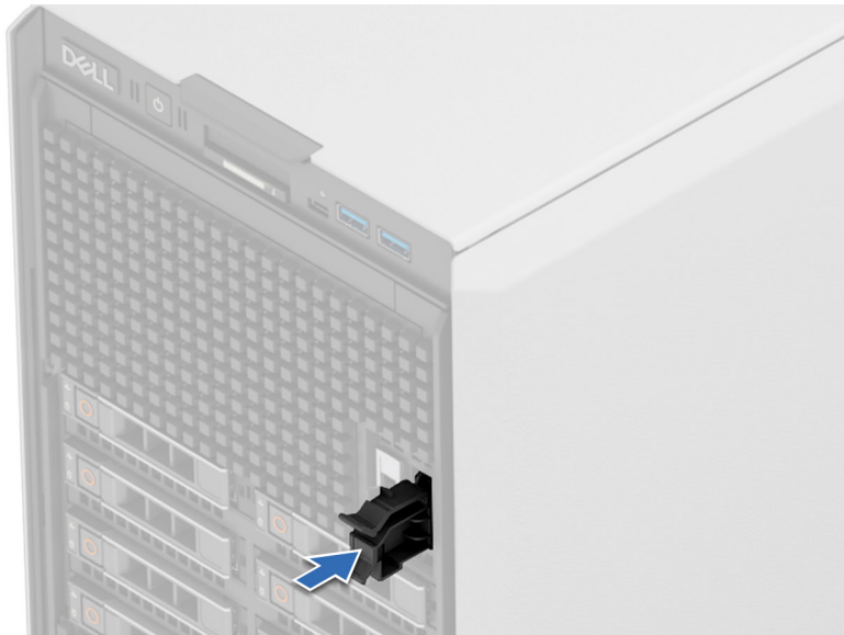
Abbildung 199. Installieren des Platzhalters für das BOSS-N1-Modul
