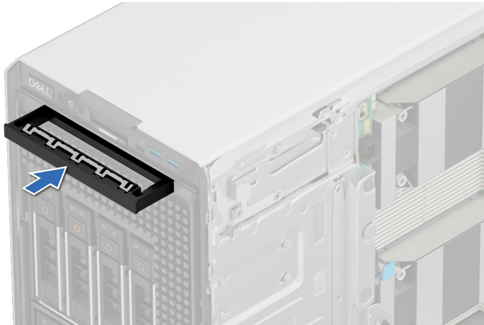
Abbildung 126. Installieren des Platzhalters für das optische Laufwerk
