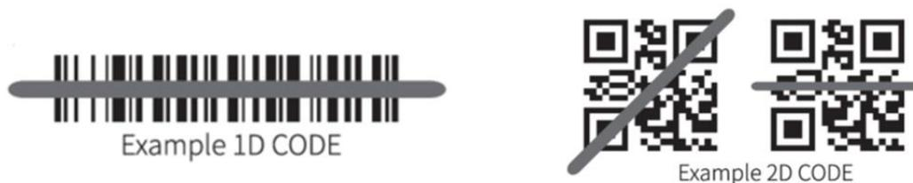
Plus le scanner est proche du code-barres, plus le faisceau devient petit, et plus il est éloigné du code-barres, plus le faisceau devient grand. Si le code-barres est petit, le scanner doit être proche du code-barres. Si le code-barres est plus grand, le scanner doit être plus éloigné du code-barres, facilitant ainsi la lecture correcte du code-barres.
