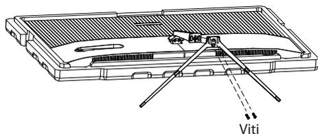
5. Basta tenere il supporto con la mano per sostenere il monitor in posizione verticale.
