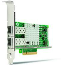
Profitieren Sie durch die Intel® X550 10GBASE-T Dual Port NIC von einer kostengünstigen maximalen Leistung mit CAT 6a- oder besseren Kabeln über Entfernungen bis 100 Meter sowie Unternehmens- und Virtualisierungsfunktionen.
