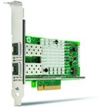
Profitieren Sie durch die Intel® X550 10GBASE-T Dual Port NIC von einer kostengünstigen maximalen Leistung mit CAT 6a- oder besseren Kabeln über Entfernungen bis 100 Meter sowie Unternehmens- und Virtualisierungsfunktionen.
