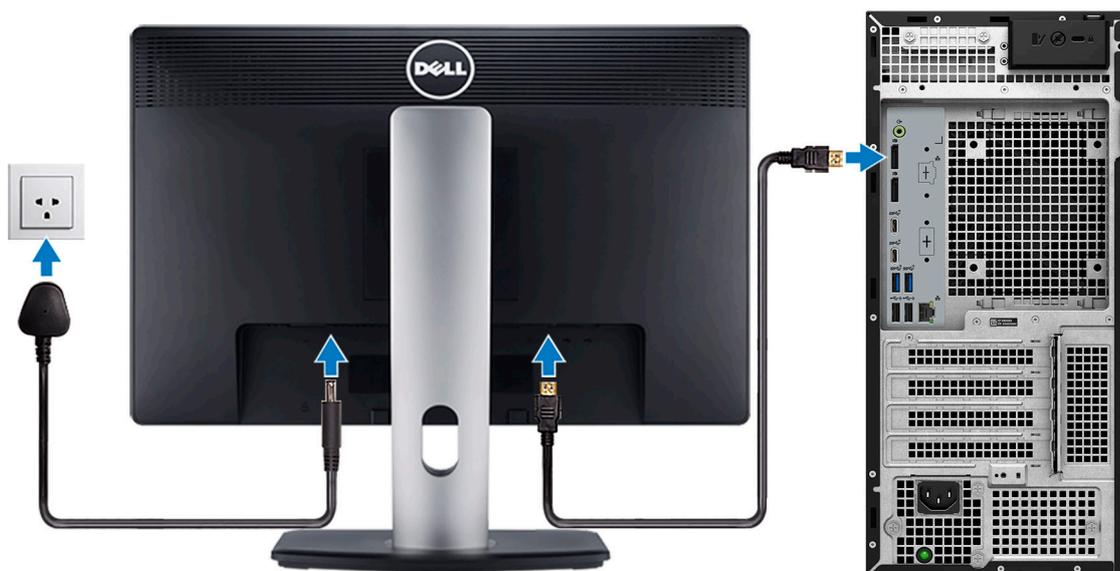
**NOTA:** Si se realizó el pedido del equipo con una tarjeta de gráficos discretos, el puerto HDMI y los puertos de visualización en el panel posterior de la computadora estarán cubiertos. Conecte la pantalla al puerto de la tarjeta de gráficos discretos.
