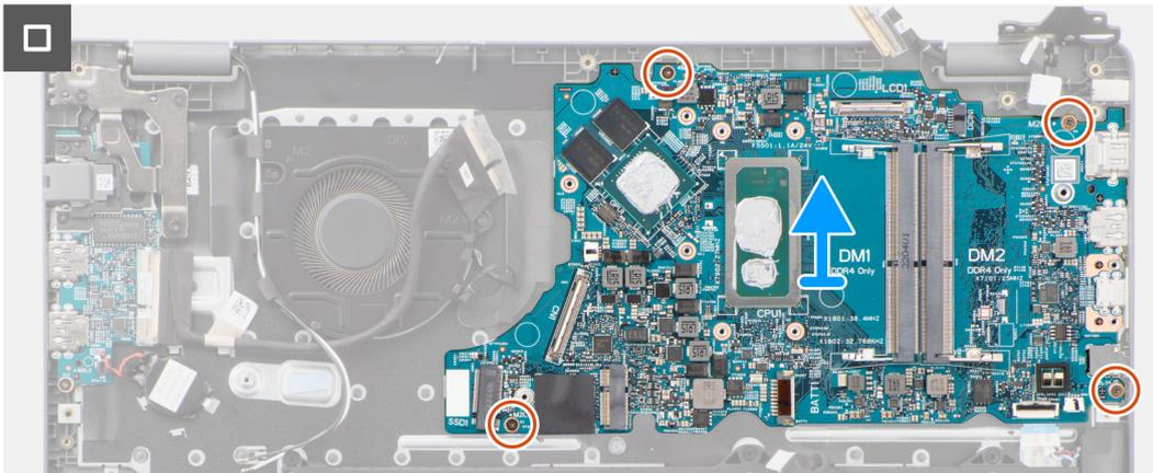
**⚠ VORSICHT:** Das System ist mit einer Knopfzellenbatterie ausgestattet, die mit der E/A-Platine verbunden ist. Durch das Trennen der E/A-Platine wird das BIOS-Setup-Programm auf die Standardeinstellungen zurückgesetzt. Notieren Sie sich die BIOS-Setup-Programmeinstellungen, bevor Sie das Kabel der E/A-Platine trennen.
