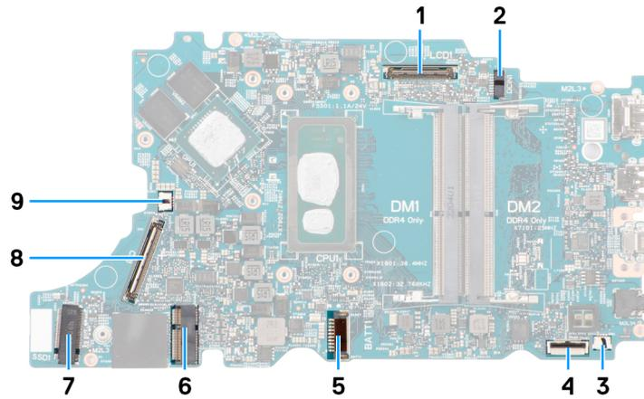
**Abbildung 1. Systemplatinenanschlüsse**
