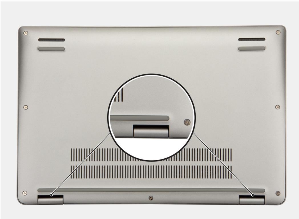
3. Hebeln Sie die Oberseite der Bodenabdeckung auf und arbeiten Sie auf der linken, rechten und unteren Seite weiter, um die Bodenabdeckung zu öffnen.
