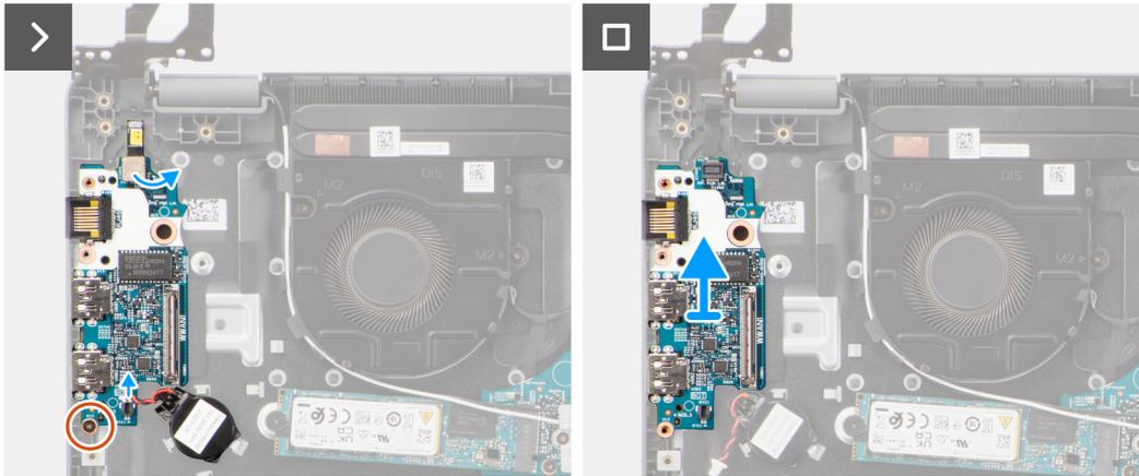
**⚠ VORSICHT:** Das System ist mit einer Knopfzellenbatterie ausgestattet, die mit der E/A-Platine verbunden ist. Durch das Trennen der E/A-Platine wird das BIOS-Setup-Programm auf die Standardeinstellungen zurückgesetzt. Notieren Sie sich die BIOS-Setup-Programmeinstellungen, bevor Sie das Kabel der E/A-Platine trennen.
