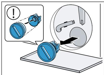
2. Pulire l'interno, la filettatura del coperchio della pompa e il corpo della pompa.
