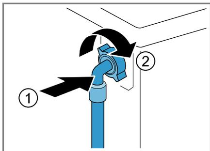
2. Collegare il tubo flessibile di carico dell'acqua al rubinetto (26,4 mm = 3/4").
