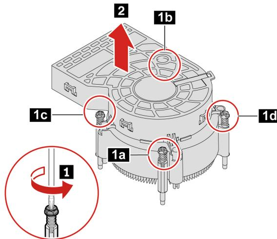
2. Posizionare l'assieme ventole e dissipatore di calore sulla scheda di sistema. Verificare che le quattro viti siano allineate ai fori sulla scheda di sistema. Seguire la sequenza riportata di seguito per stringere le quattro viti in modo da fissare il nuovo assieme ventole e dissipatore di calore. Non stringere eccessivamente le viti.
