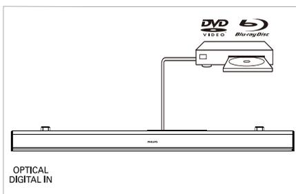
Utilizzando un cavo ottico, collegare il connettore **OPTICAL** della soundbar al connettore **OPTICAL OUT** sul TV o di un altro dispositivo.
