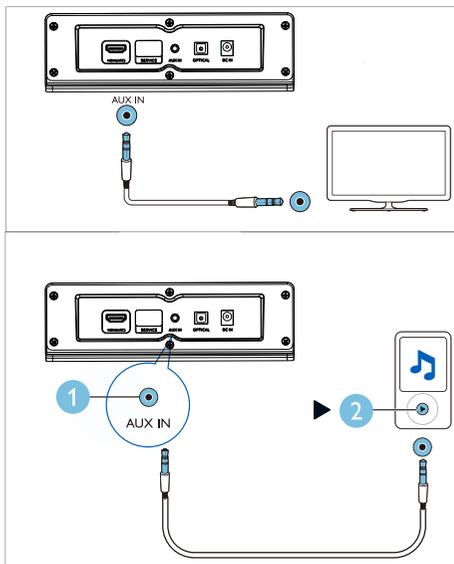
Utilizzando un cavo audio stereo da 3,5 mm, collegare il connettore **AUX IN** della soundbar al connettore **AUX** del televisore o di un altro dispositivo.
