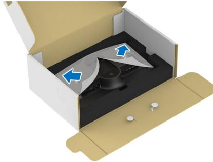
6. Insérez avec précaution les onglets de la colonne du pied dans les fentes du capot arrière de l'écran et appuyez l'ensemble du pied vers le bas pour l'enclencher en place.
