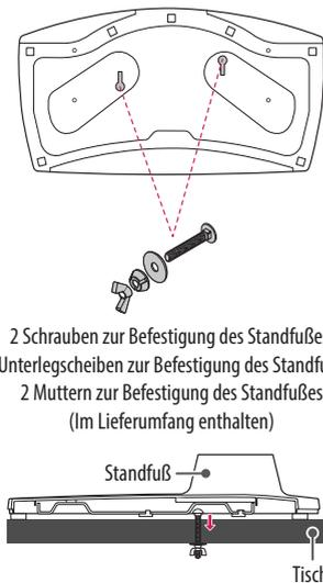
2 Schrauben zur Befestigung des Standfußes,
