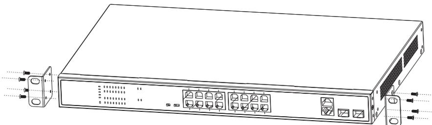
1. Individuare i fori di montaggio sul lato dello switch e fissare i ganci come segue la figura sopra.
