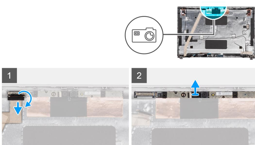
**Figure 2. Retrait du module de caméra infrarouge**
