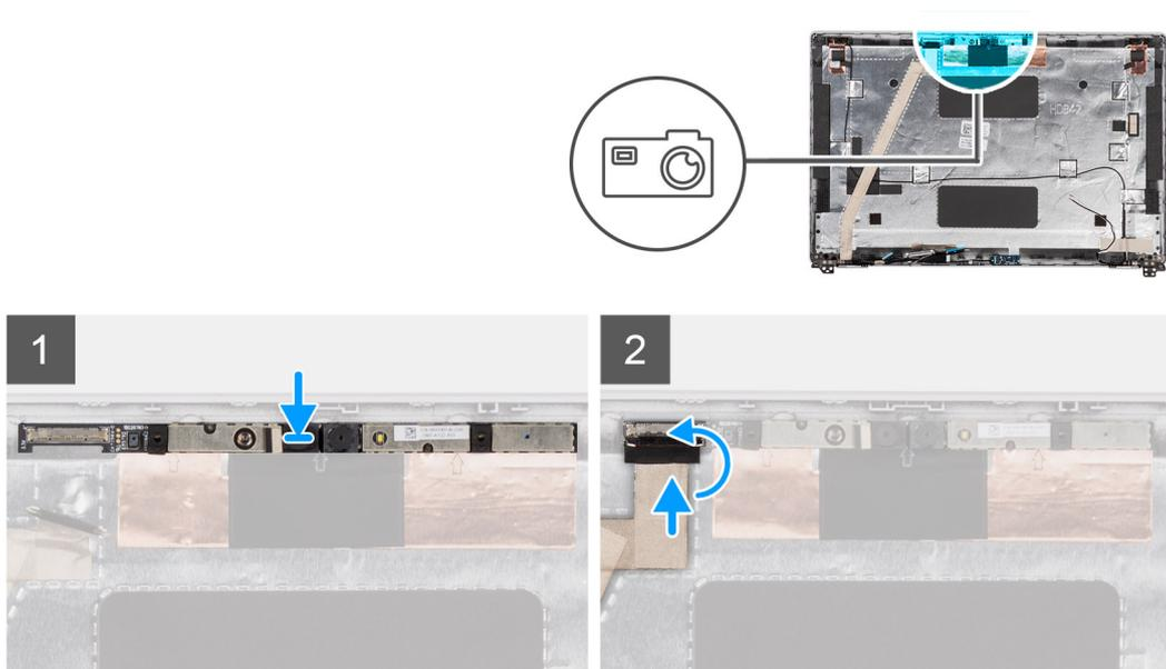
Figure 4. Installation du module de caméra infrarouge
