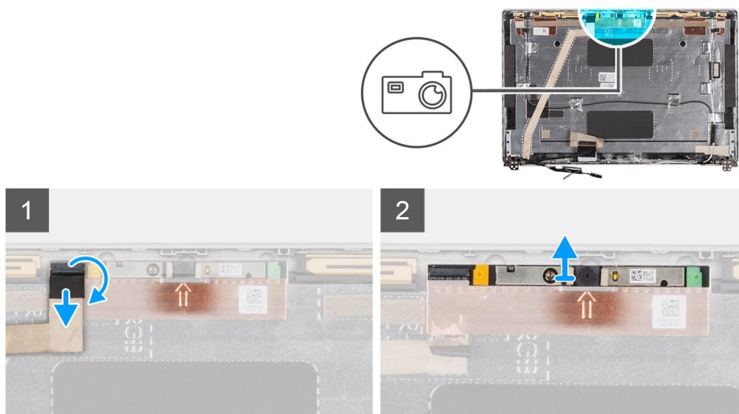
Figure 1. Retrait du module de caméra
