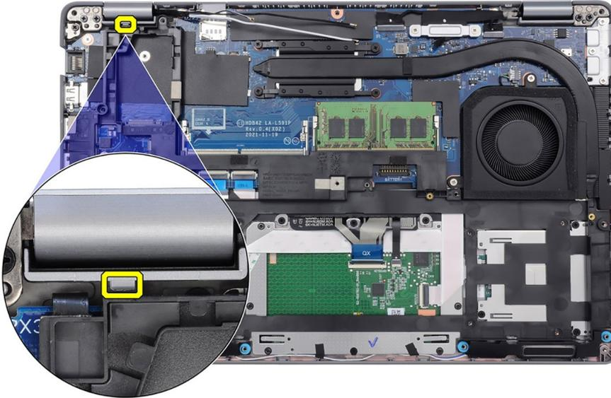
2. Remettez en place les dix vis (M2x3) et les trois vis (M2x5) qui fixent le cadre interne de l'assemblage à la carte système et à l'assemblage du repose-poignets.
