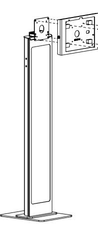
ADJUST TILT RESISTANCE BY TIGHTENING THE SCREW LOCATED ON THE HINGE ASSEMBLY
