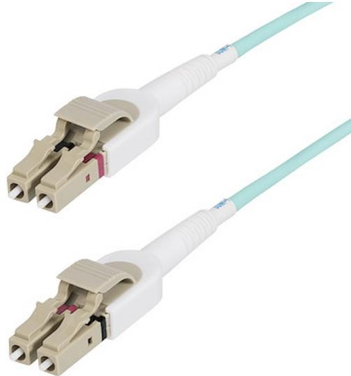
Il cavo in fibra ottica Multimodale commutabile OM4 da LC/UPC a LC/UPC consente connessioni di rete a 40/100Gbps. Gli alloggiamenti antistrappo retrattili consentono di cambiare la polarità sul campo, senza attrezzi. I connettori LC-Duplex con codice colore assicurano una configurazione della polarità senza errori.
