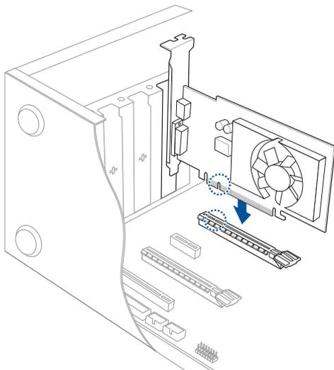
5. El ejector volverá a ajustarse en su posición automáticamente.
