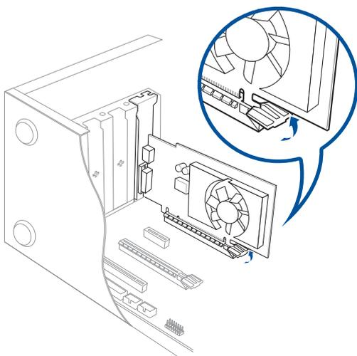
6. Utilice un destornillador y un tornillo para bloquear la tarjeta gráfica en el chasis.
