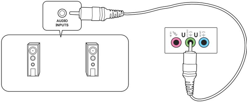
**Conexión de un sistema de altavoces de 4 canales**
