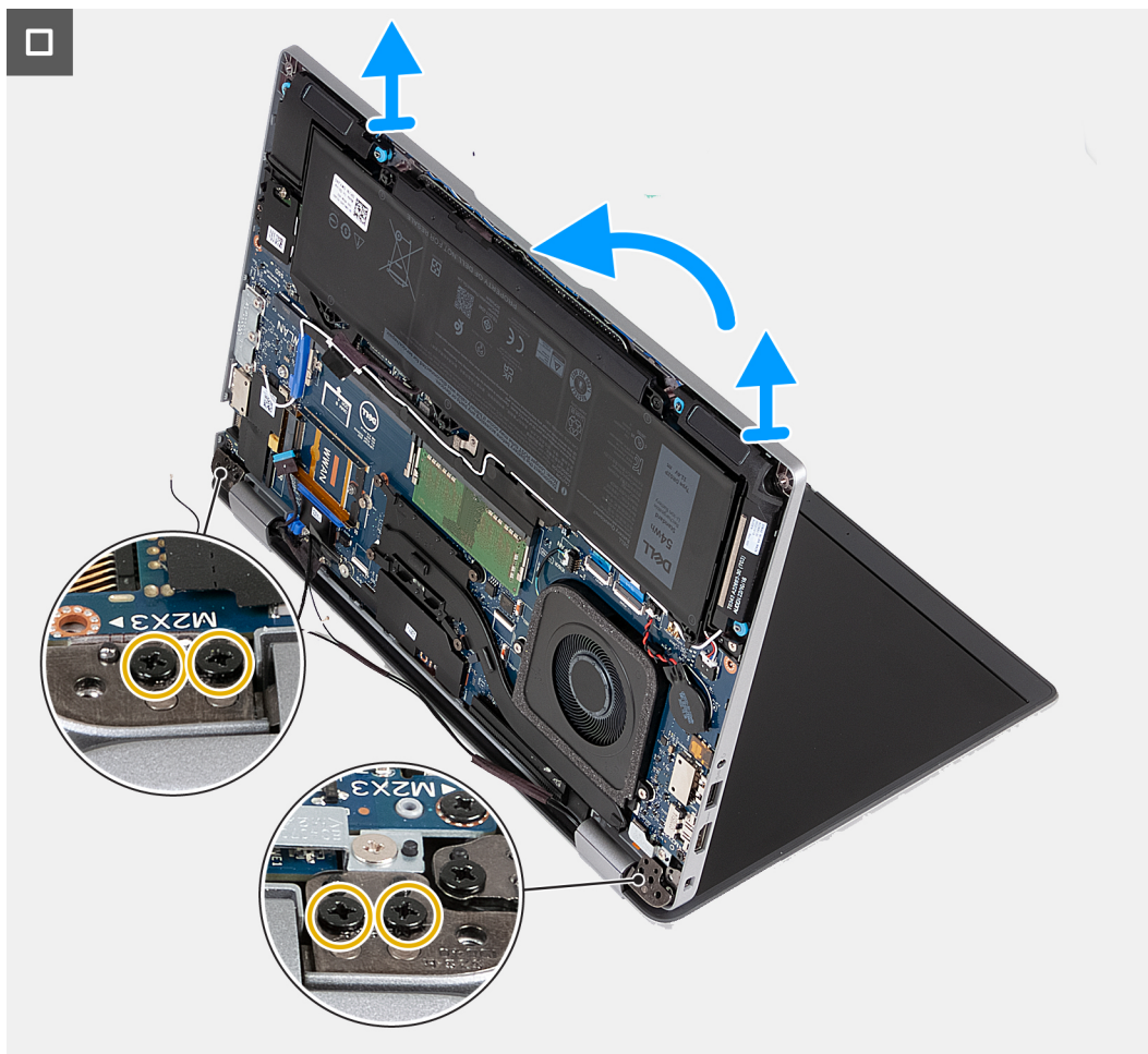
Figura34. Retirar o conjunto do ecrã - Para computadores enviados com placa 4G
