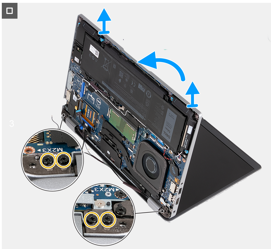
Figura36. Retirar o conjunto do ecrã - Para computadores enviados com placa 5G
