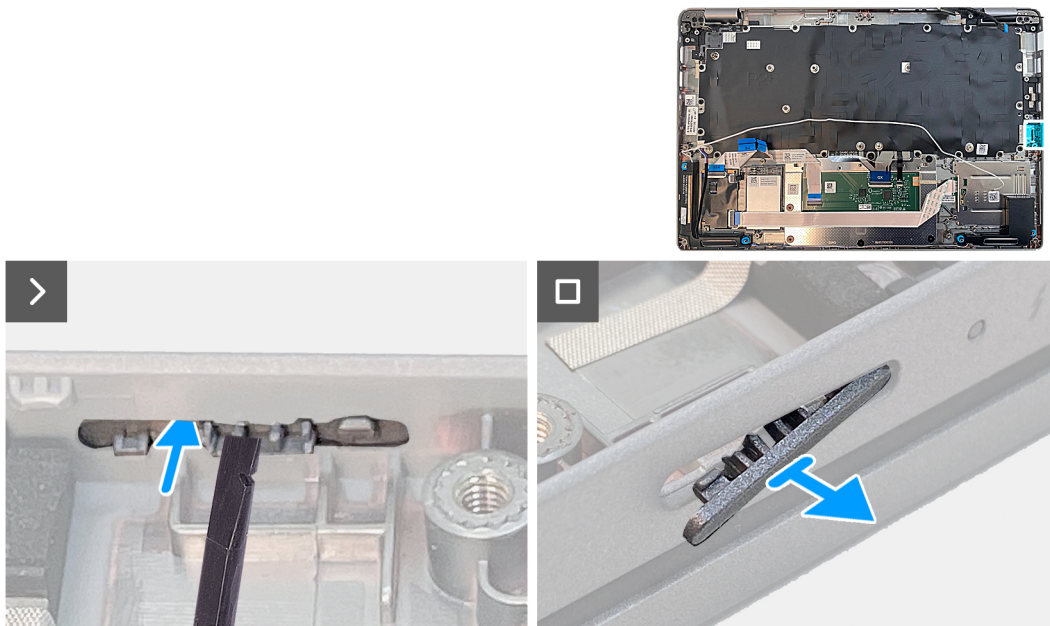
Afbeelding 65. De dummy simkaartslotvuller verwijderen
