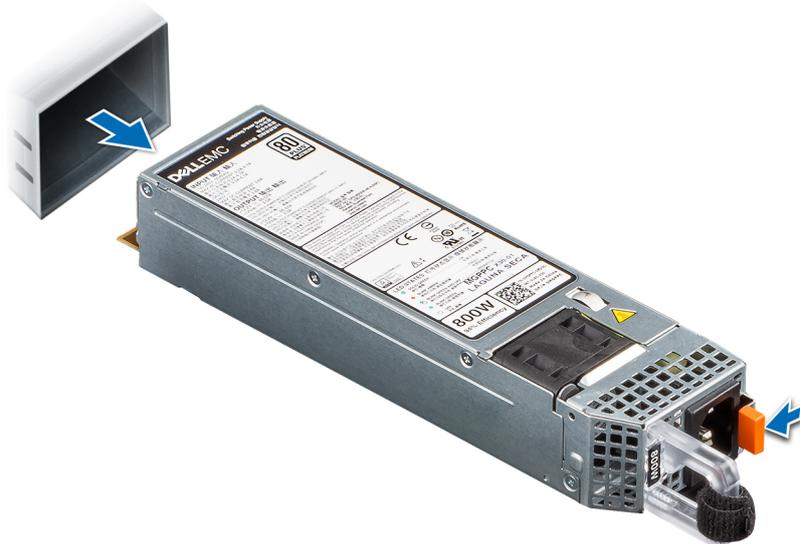
Figure 67. Retrait d'un bloc d'alimentation
