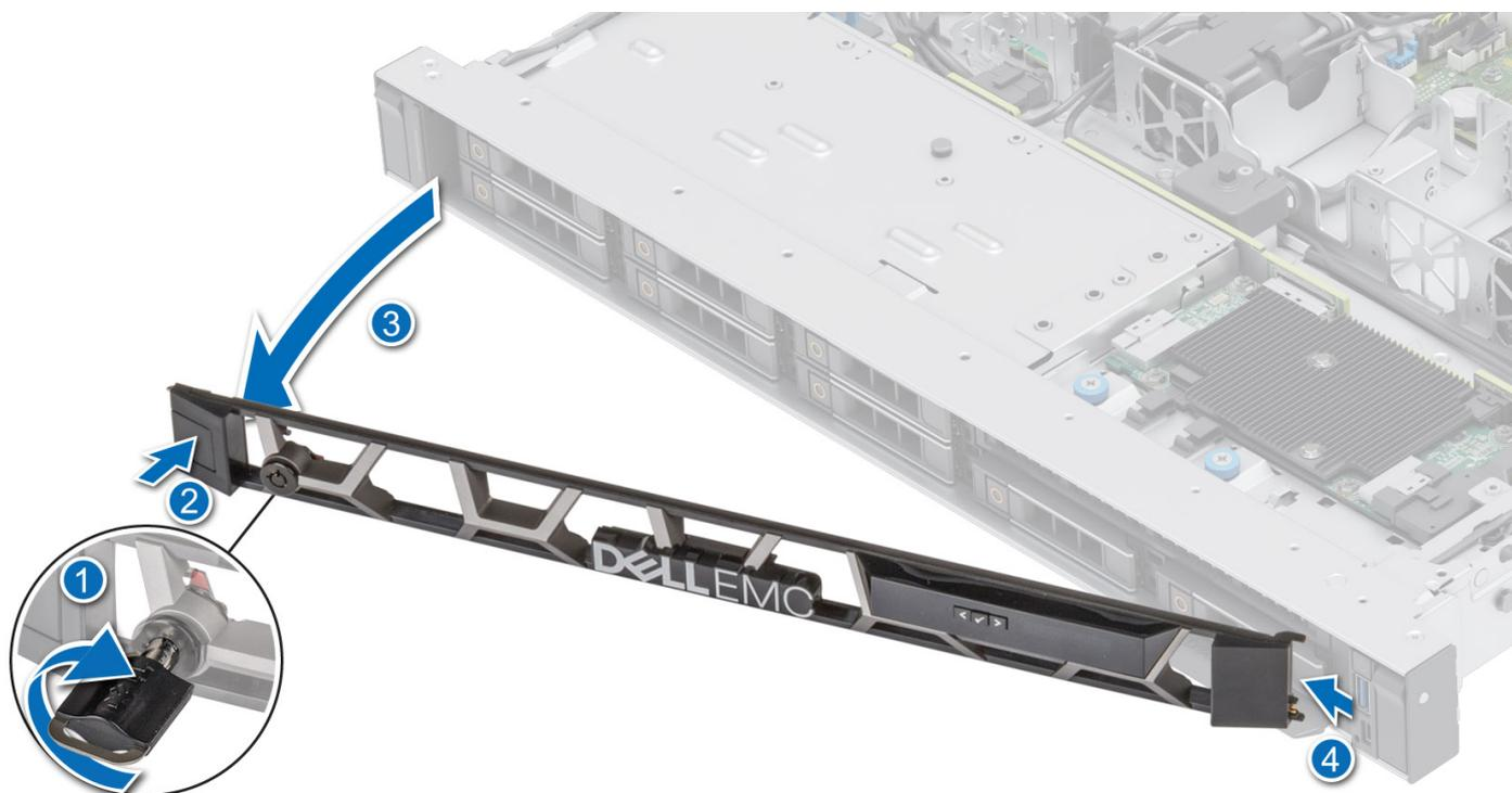
Figure 9. Retrait du panneau avant avec l'écran LCD
