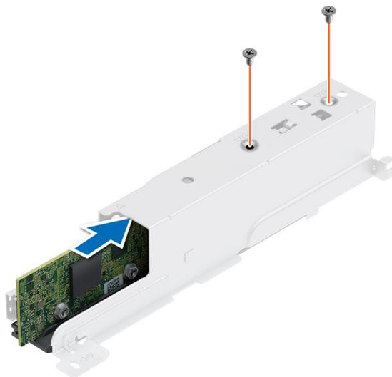
Figure 56. Installation du module BOSS S2
