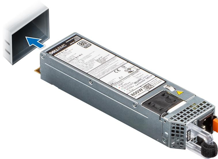
Figure 68. Installation d'un bloc d'alimentation
