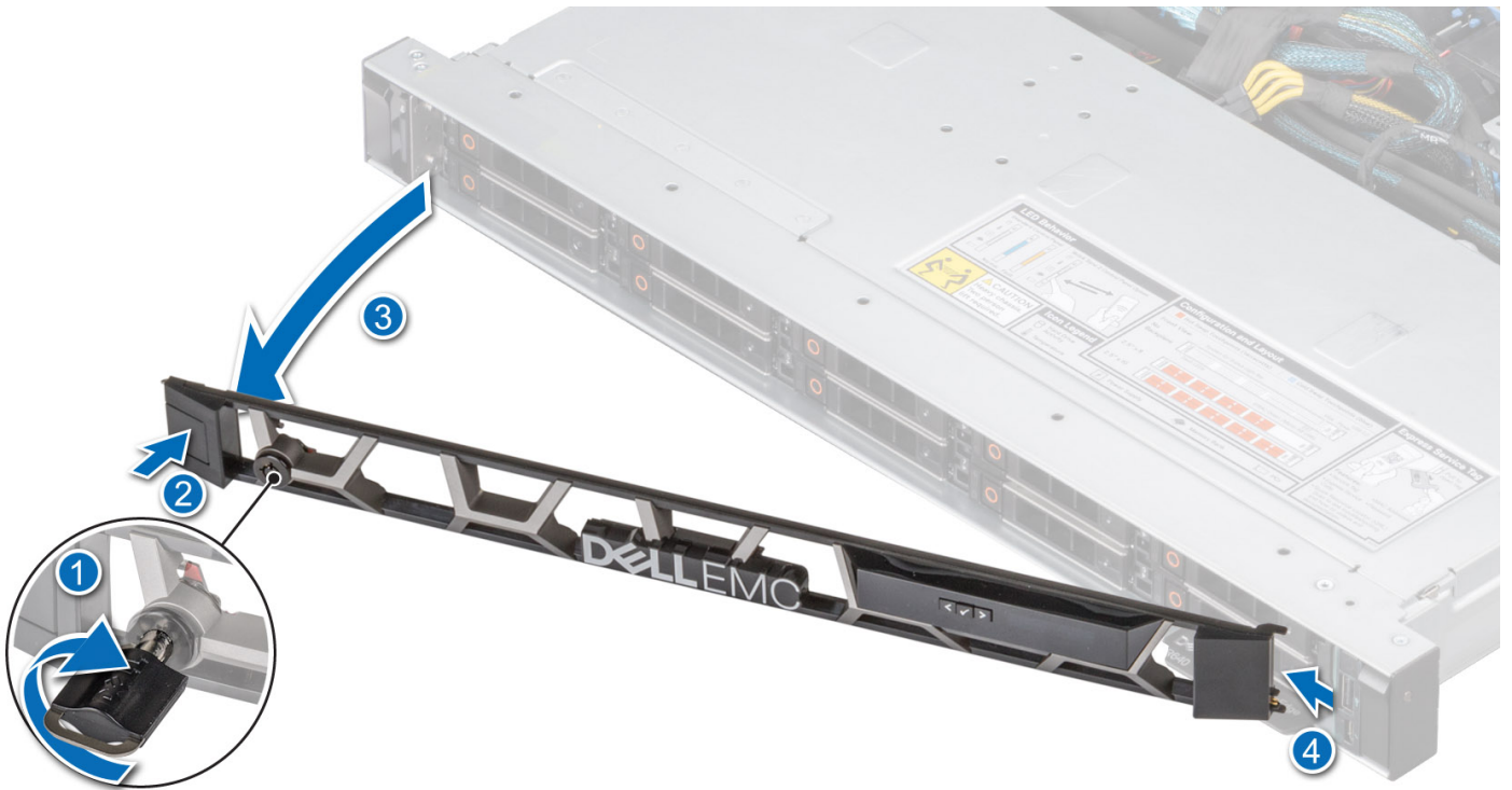
Figure 15. Retrait du panneau avant avec l'écran LCD
