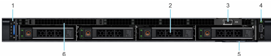
Figure 1. Vue avant d'un système à 4 disques de 3,5 pouces
