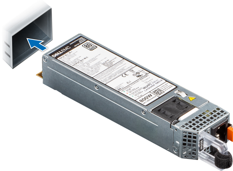
Figure 97. Installation d'un bloc d'alimentation
