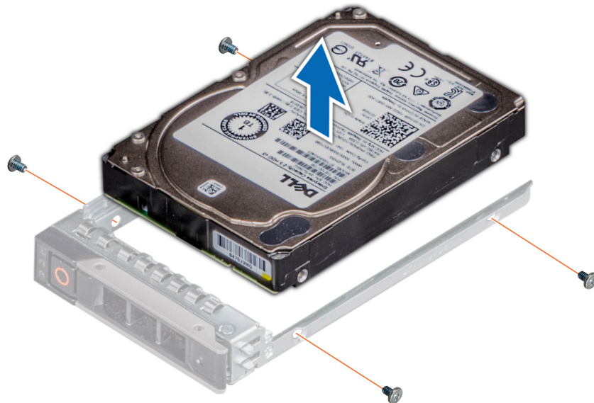
Abbildung 28. Laufwerk aus Laufwerksträger entfernen
