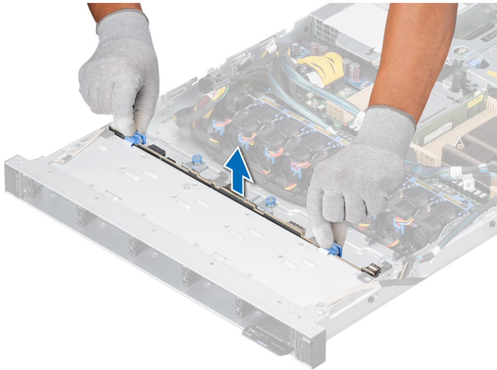
Abbildung 35. Entfernen der Rückwandplatine
