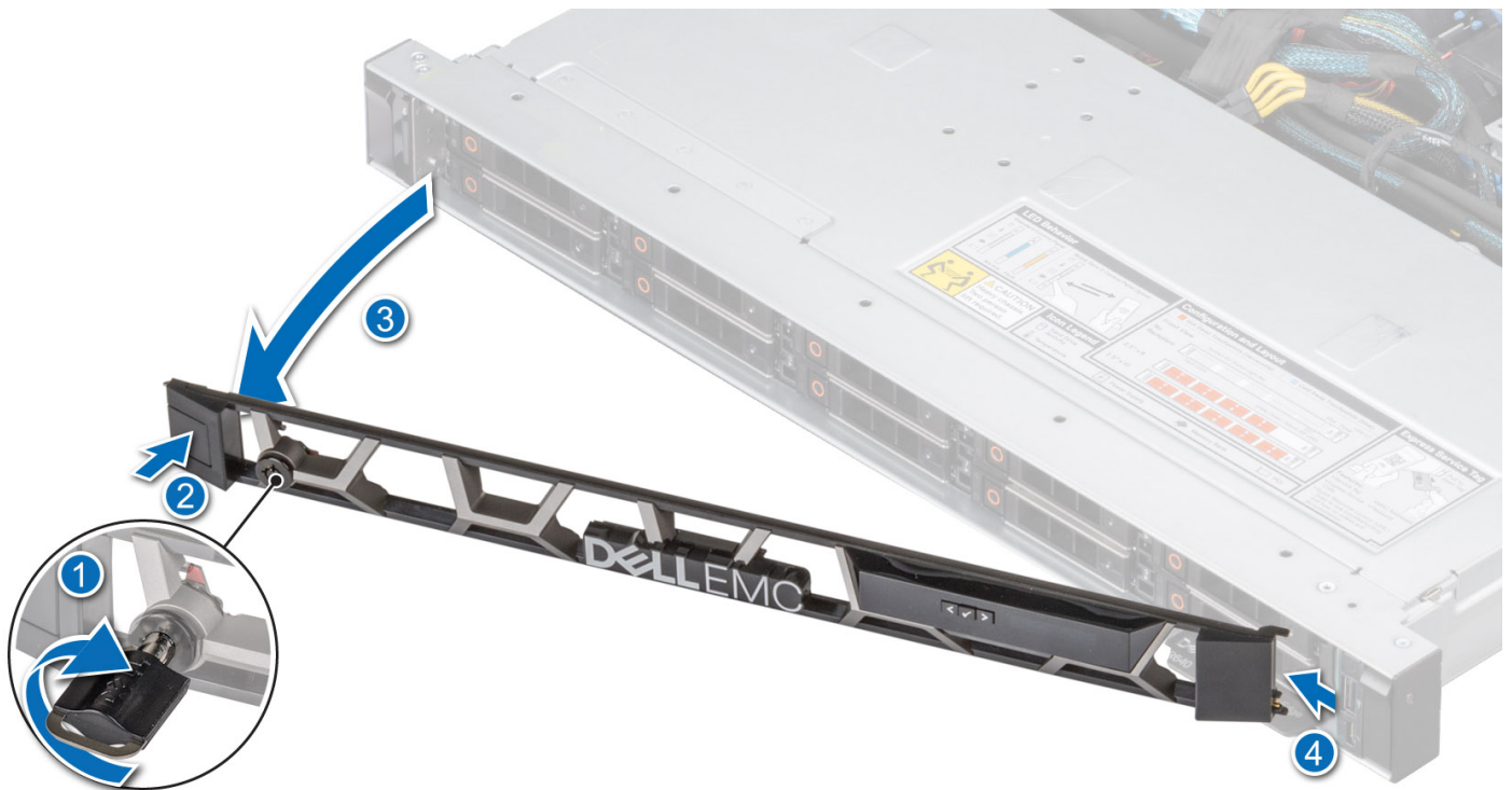
Abbildung 12. Entfernen der Frontblende mit LCD-Display
