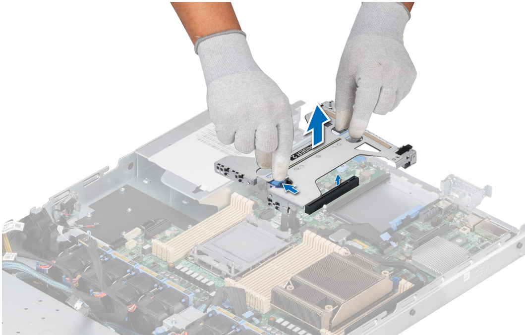
Abbildung 70. Entfernen von Riser 2a
