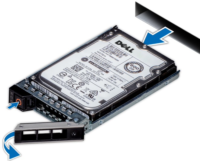
Abbildung 26. Entfernen eines Festplattenträgers
