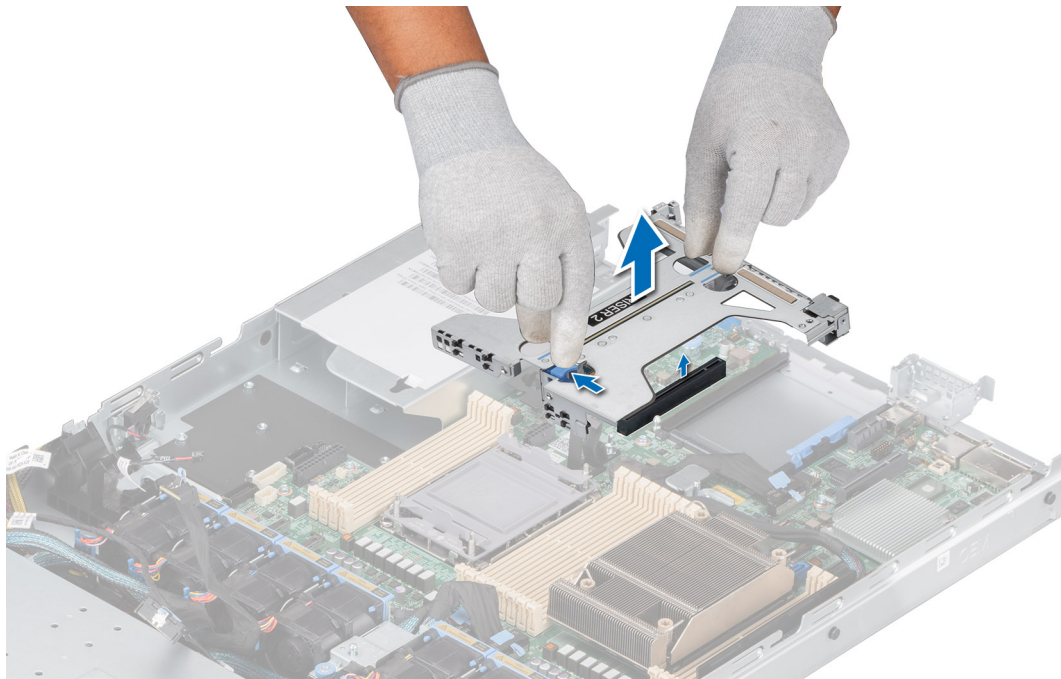
Abbildung 72. Entfernen von Riser 2c
