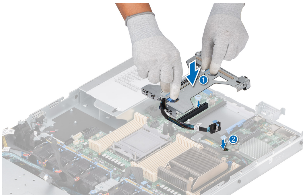
Ilustración 75. Instalación del soporte vertical 2b con el módulo SNAP
