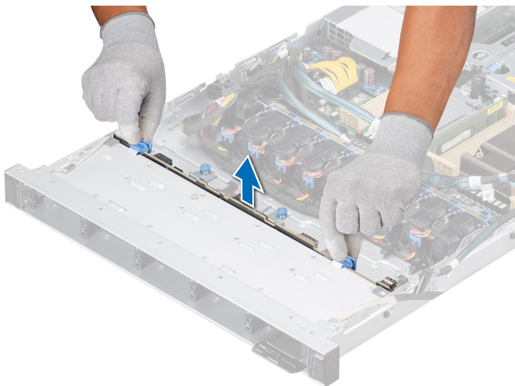
Ilustración 35. Extracción del plano posterior
