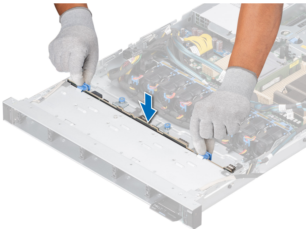
Ilustración 36. Instalación del backplane de la unidad
