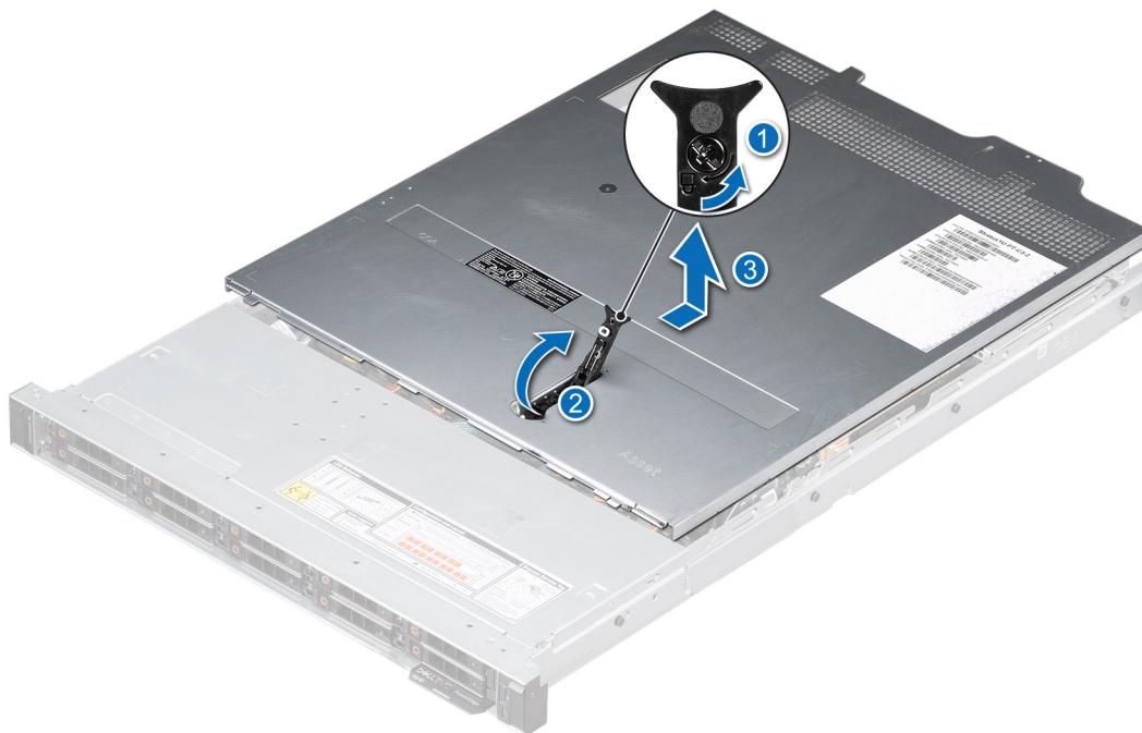
Ilustración 14. Extracción de la cubierta del sistema
