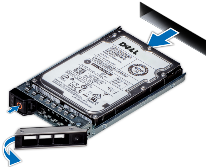
Abbildung 26. Entfernen eines Festplattenträgers
