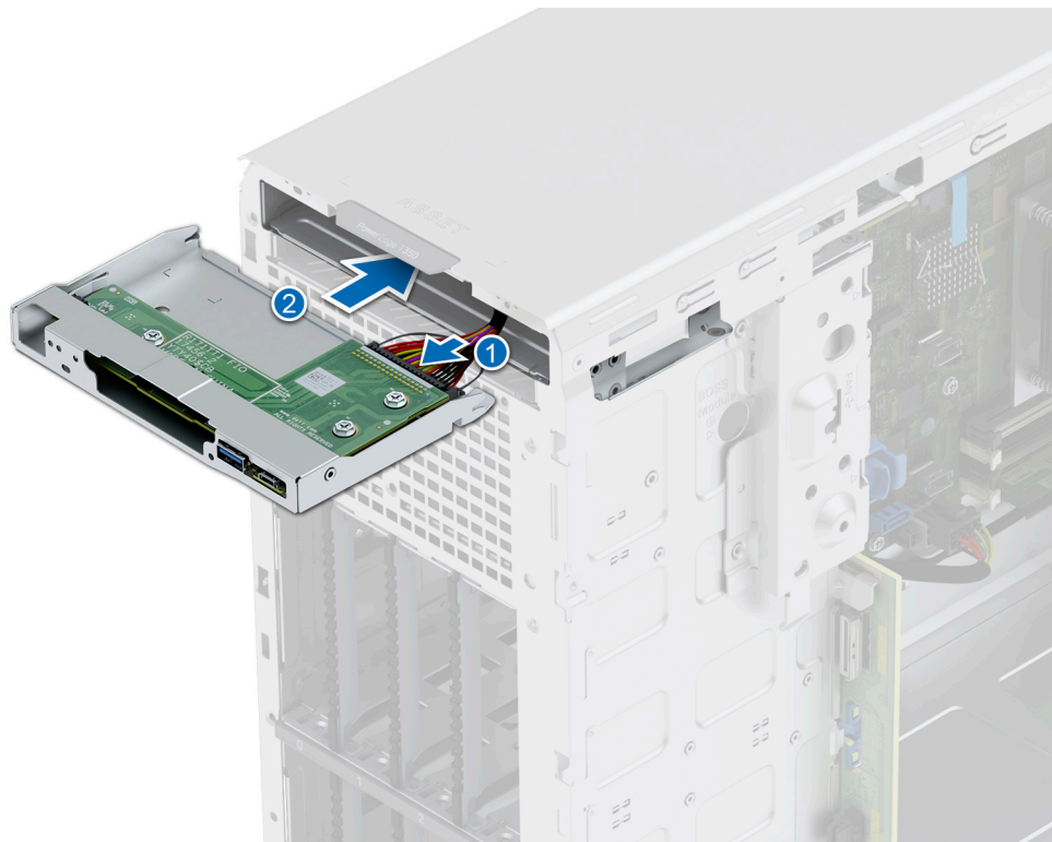
Figure 99. Installation du bâti du panneau de commandes
