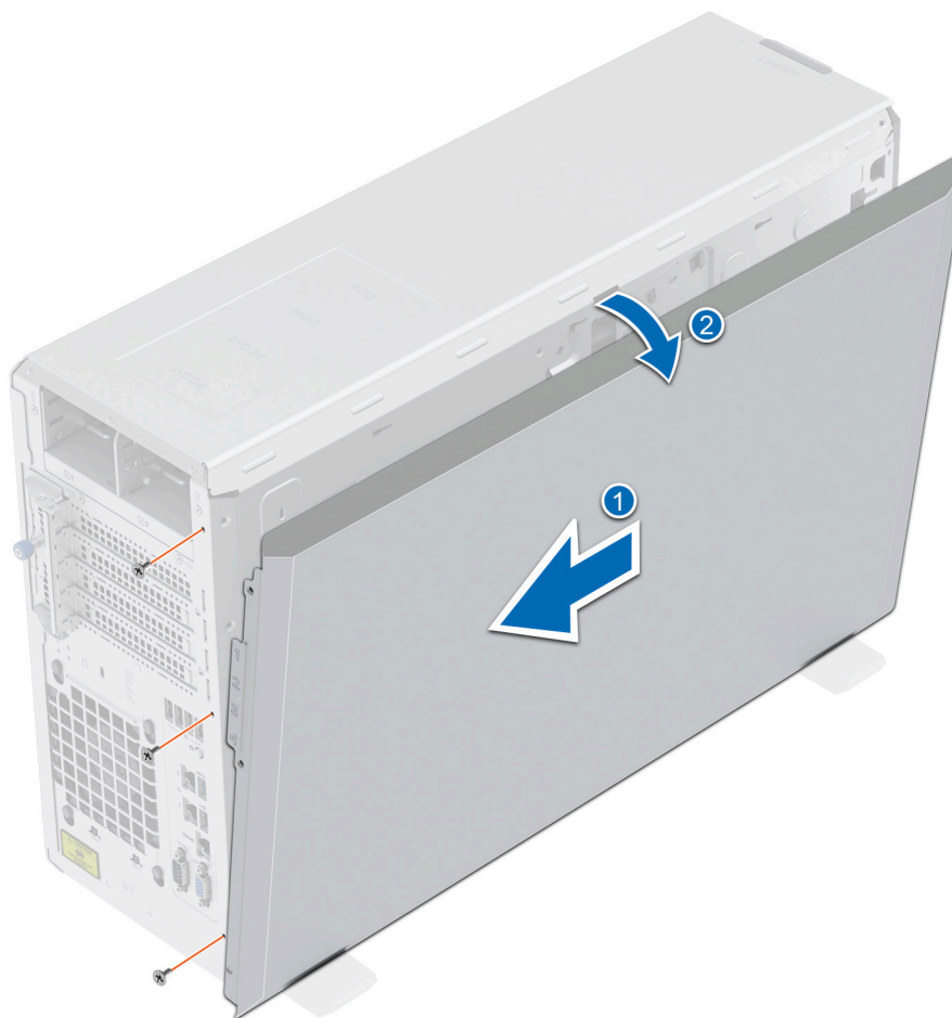
Figure 94. Retrait du capot latéral du système
