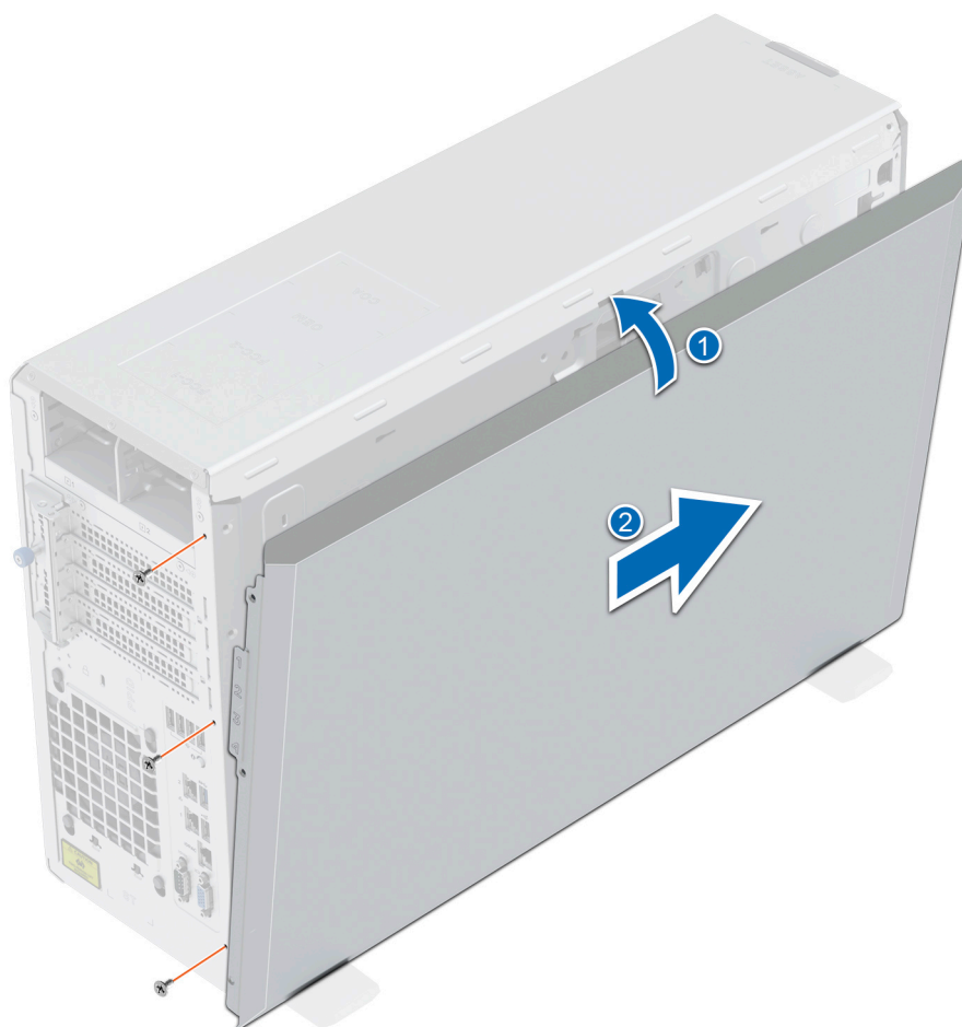
Figure 101. Installation du capot latéral du système
