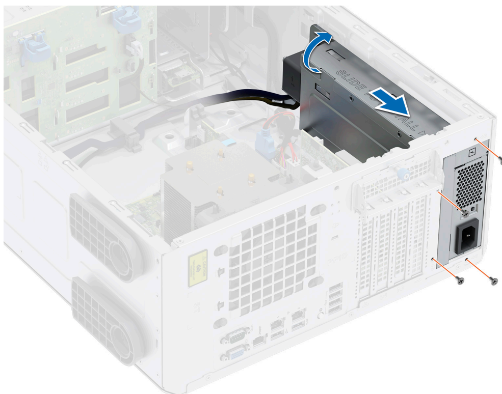
Figure 84. Installation du bâti du bloc d'alimentation
