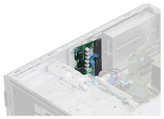
Abbildung 86. Installieren der Stromzwischenplatine
