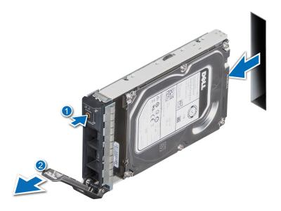
Abbildung 24. Entfernen eines Festplattenträgers
