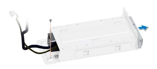
Abbildung 82. Entfernen eines verkabelten Netzteils
