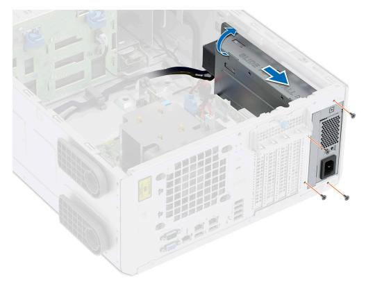
Abbildung 84. Einsetzen des Netzteilgehäuses
