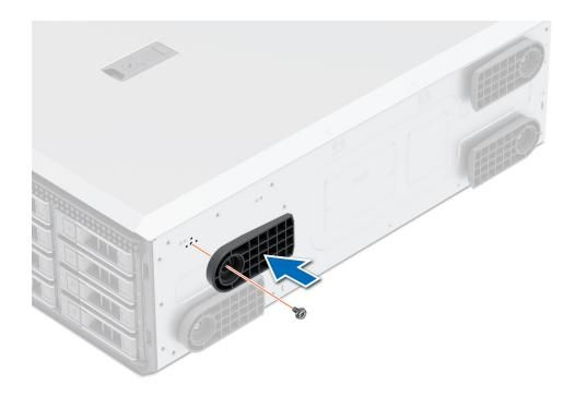
Abbildung 15. Installieren der Standfüße
