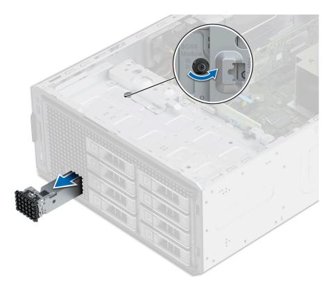
Abbildung 59. Entfernen des Platzhalters aus dem BOSS-S2-Modul
