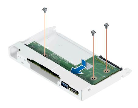
Abbildung 98. Installieren der Bedienfeldbaugruppe
