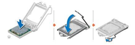
Abbildung 51. Einbauen des Prozessors
