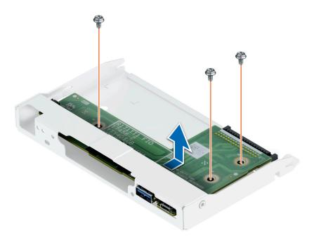
Abbildung 97. Entfernen der Bedienfeldbaugruppe
