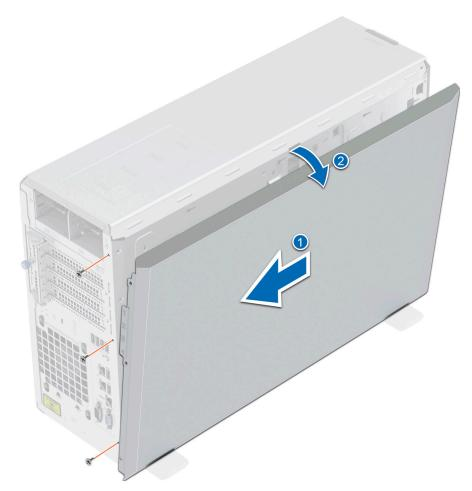
Abbildung 94. Entfernen der Seitenabdeckung des Systems
