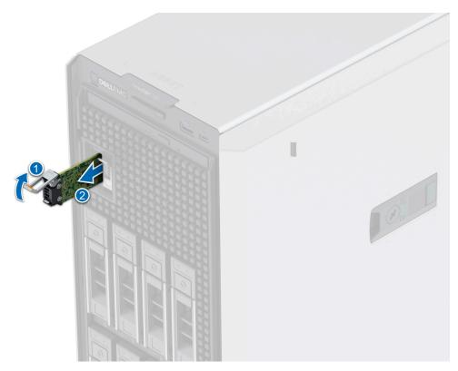
Abbildung 63. Entfernen des BOSS-S2-Kartenträgers
