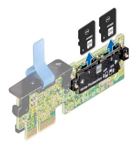
Abbildung 73. Entfernen der mikroSD-Karte
