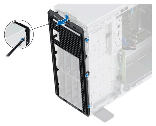
Abbildung 95. Entfernen der vorderen Abdeckplatte
