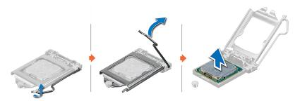
Abbildung 50. Entfernen des Prozessors
