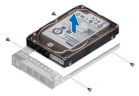
Abbildung 26. Laufwerk aus Laufwerkträger entfernen
