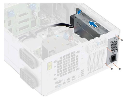
Abbildung 81. Entfernen des Netzteilgehäuses
