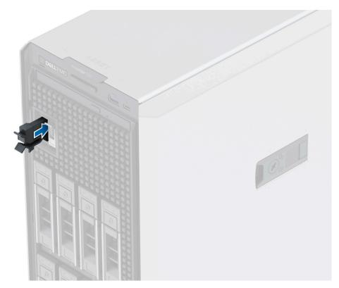
Abbildung 62. Einsetzen des Platzhalters für den BOSS-S2-Kartenträger
