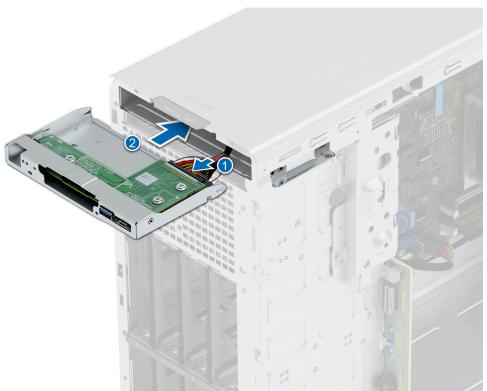
Abbildung 99. Installieren des Bedienfeldgehäuses
