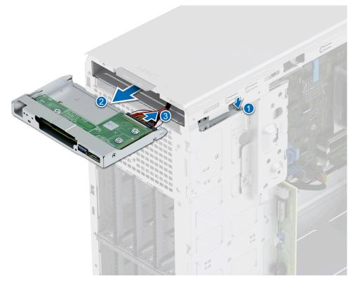
Abbildung 96. Entfernen des Bedienfeldgehäuses
