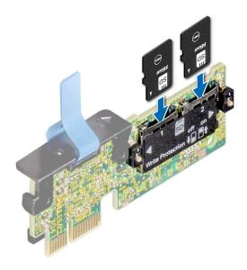
Abbildung 74. Einsetzen der MicroSD-Karte
