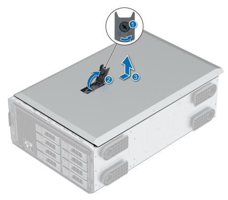
Abbildung 16. Systemabdeckung entfernen
