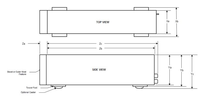
Figure 1. Dimensions du boîtier
