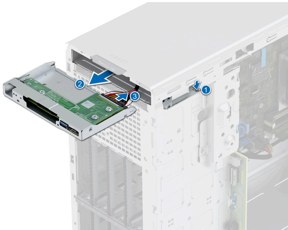
**Abbildung 96. Entfernen des Bedienfeldgehäuses**
