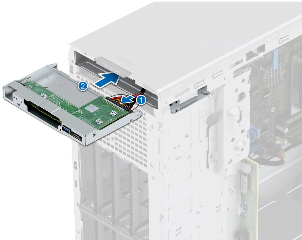
**Abbildung 99. Installieren des Bedienfeldgehäuses**
