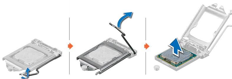
Abbildung 50. Entfernen des Prozessors
