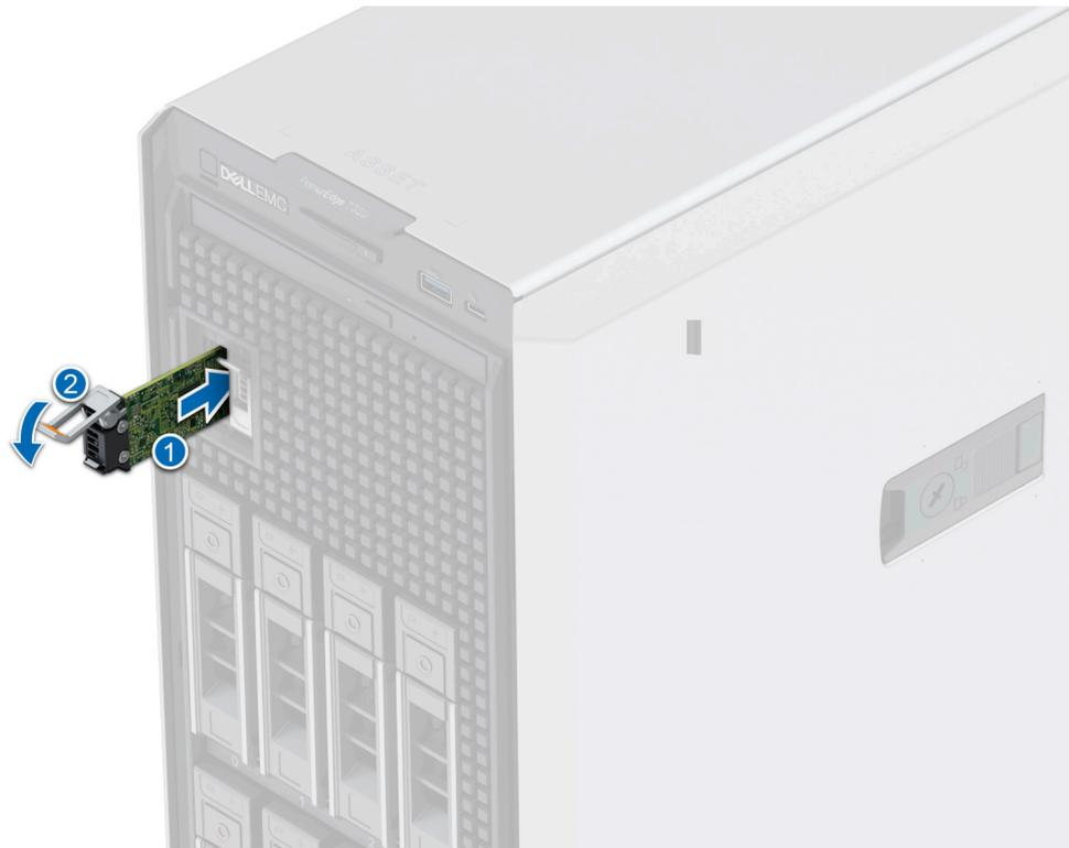
Abbildung 70. Installieren des BOSS-S2-Kartenträgers
