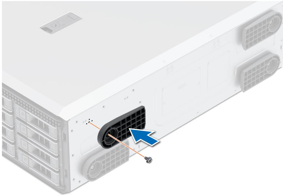
Abbildung 15. Installieren der Standfüße
