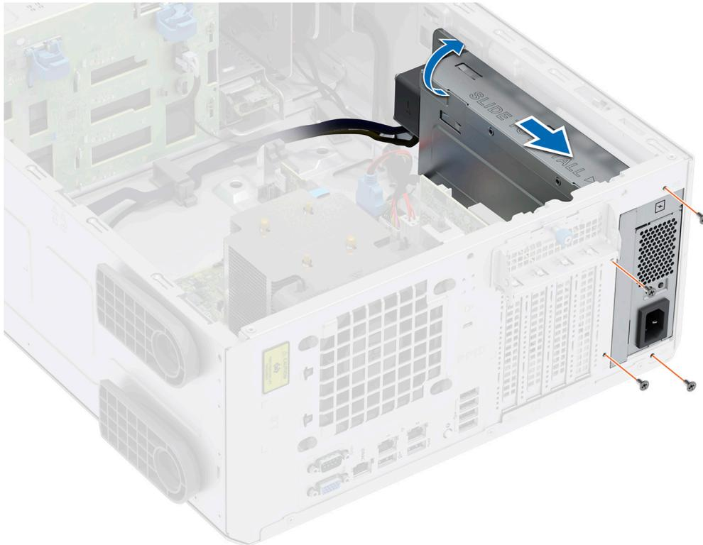
Abbildung 84. Einsetzen des Netzteilgehäuses
