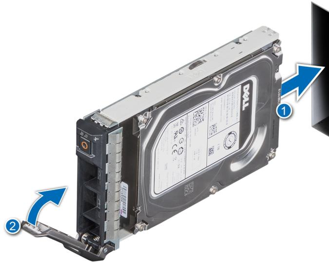
Abbildung 25. Installieren eines Laufwerksträgers
