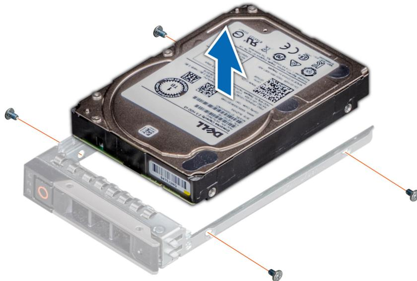
Abbildung 26. Laufwerk aus Laufwerksträger entfernen
