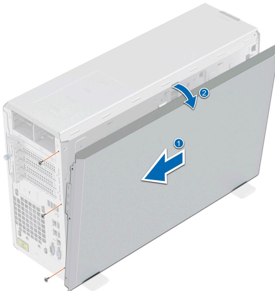
**Abbildung 94. Entfernen der Seitenabdeckung des Systems**
