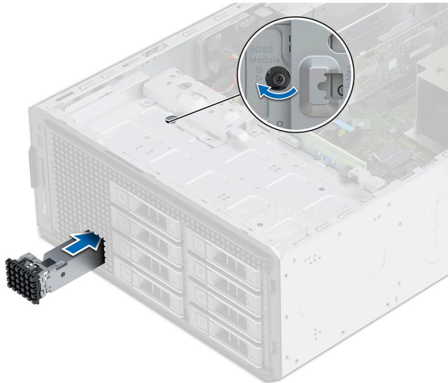
**Abbildung 103. Installieren des Platzhalters für das BOSS-S2-Modul**
