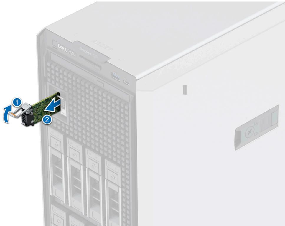
**Abbildung 63. Entfernen des BOSS-S2-Kartenträgers**
