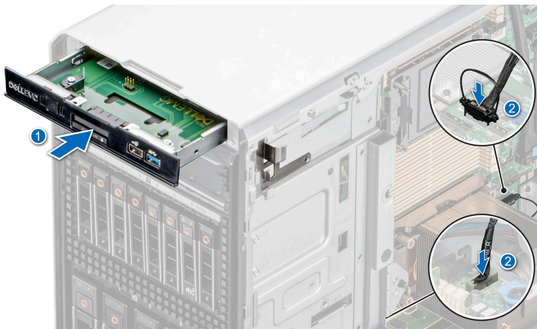
Ilustración 105. Instalación del módulo de I/O frontal para la configuración básica
