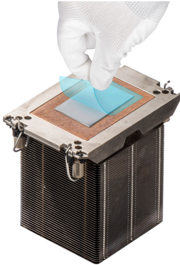
Ilustración 149. Extracción de la película de protección del material de interfaz térmica (TIM)
