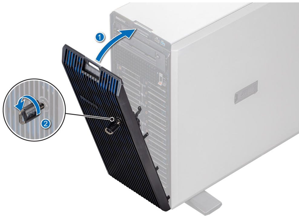
Figure 28. Installation du panneau avant
