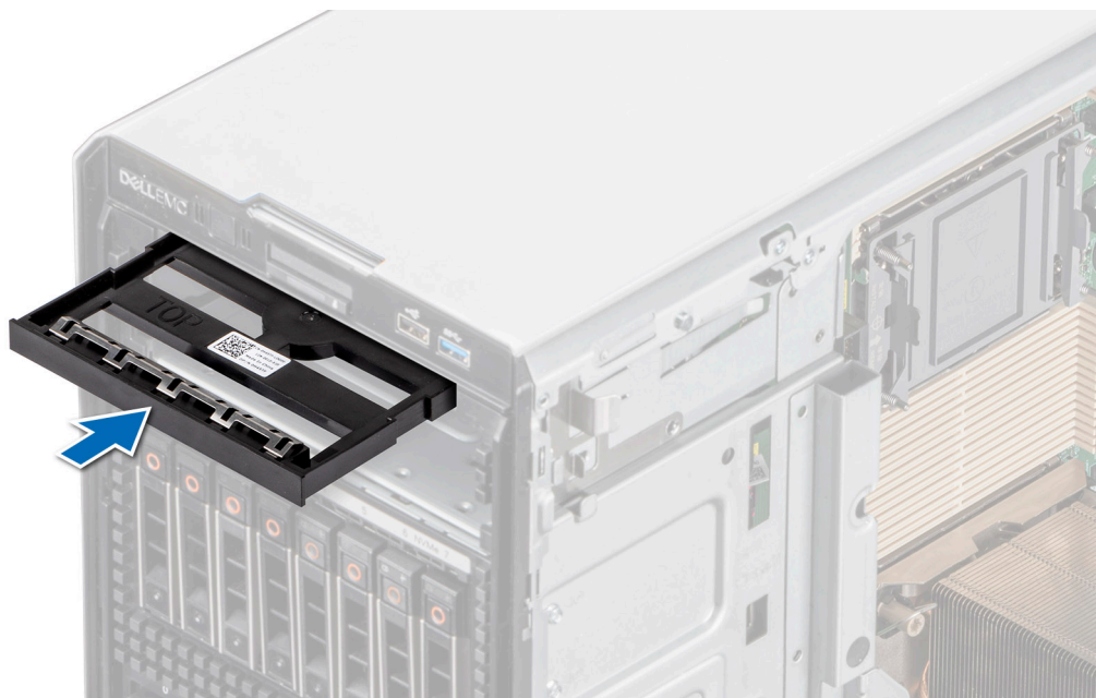
Figure 96. Installation du cache de lecteur optique
