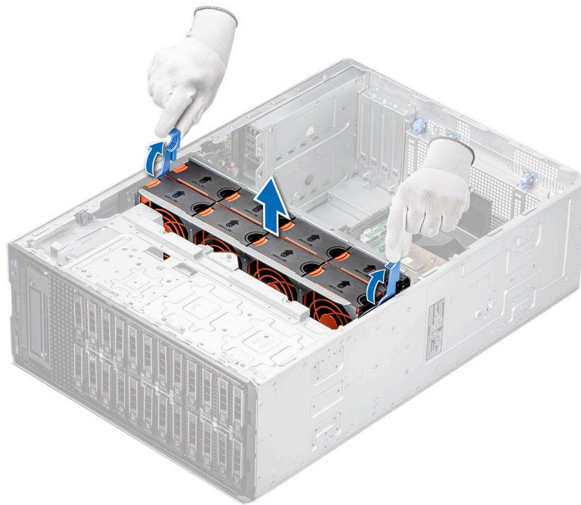
Figure 39. Retrait du bâti des ventilateurs
