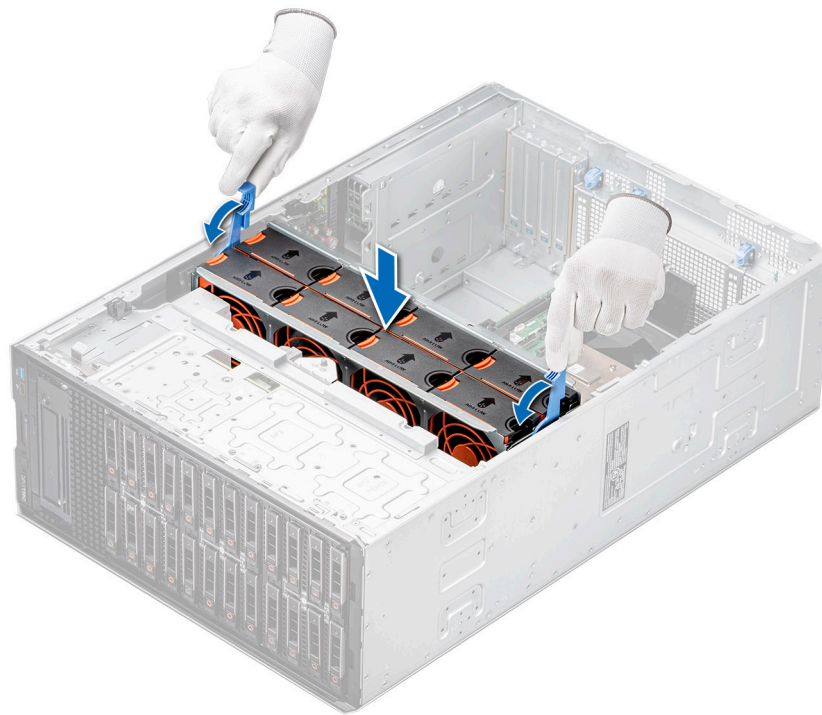
Figure 40. Installation d'un bâti de ventilateur de refroidissement
