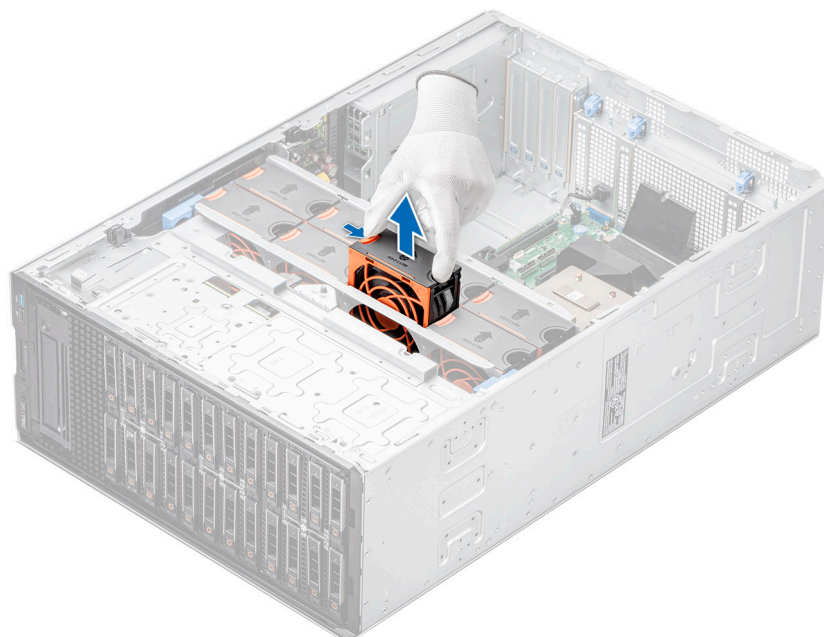
Abbildung 37. Entfernen eines Kühlungslüfters
