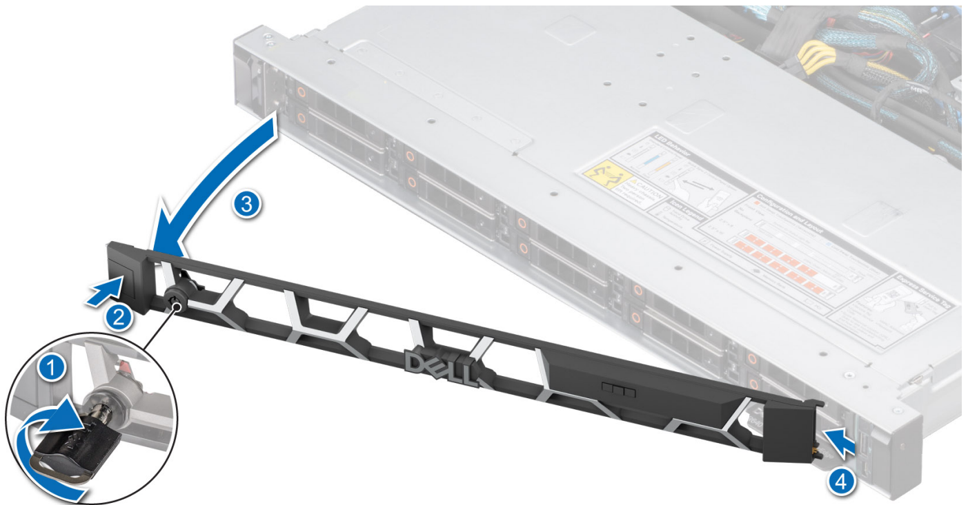
Abbildung 20. Entfernen der Frontverkleidung mit LCD-Bedienfeld
