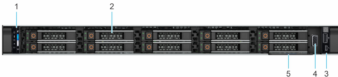
Abbildung 3. Frontansicht eines Systems mit 10 x 2,5-Zoll-Laufwerken
