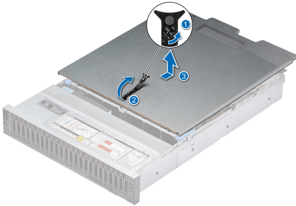
Figure 19. Retrait du capot du système
