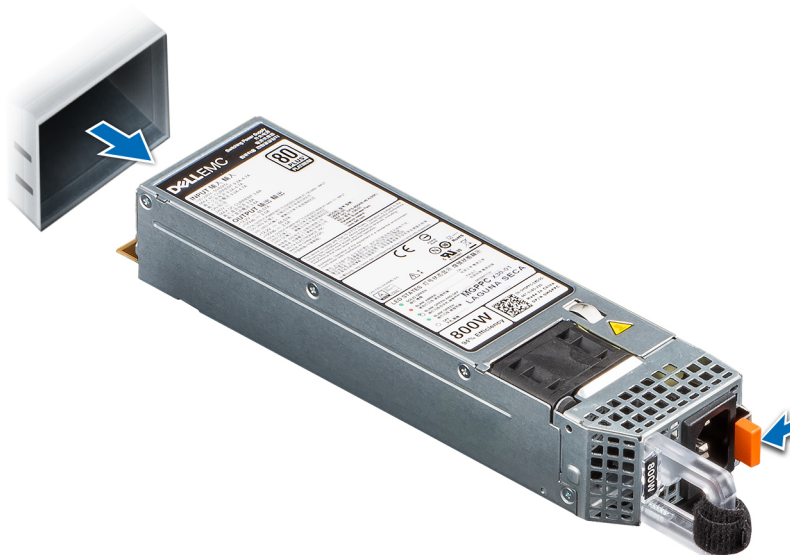
Figure 122. Retrait d'un bloc d'alimentation
