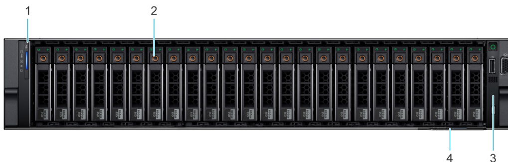
Figure 1. Vue avant d'un système à 16 disques SAS/SATA de 2,5 pouces + 8 disques NVMe de 2,5 pouces
