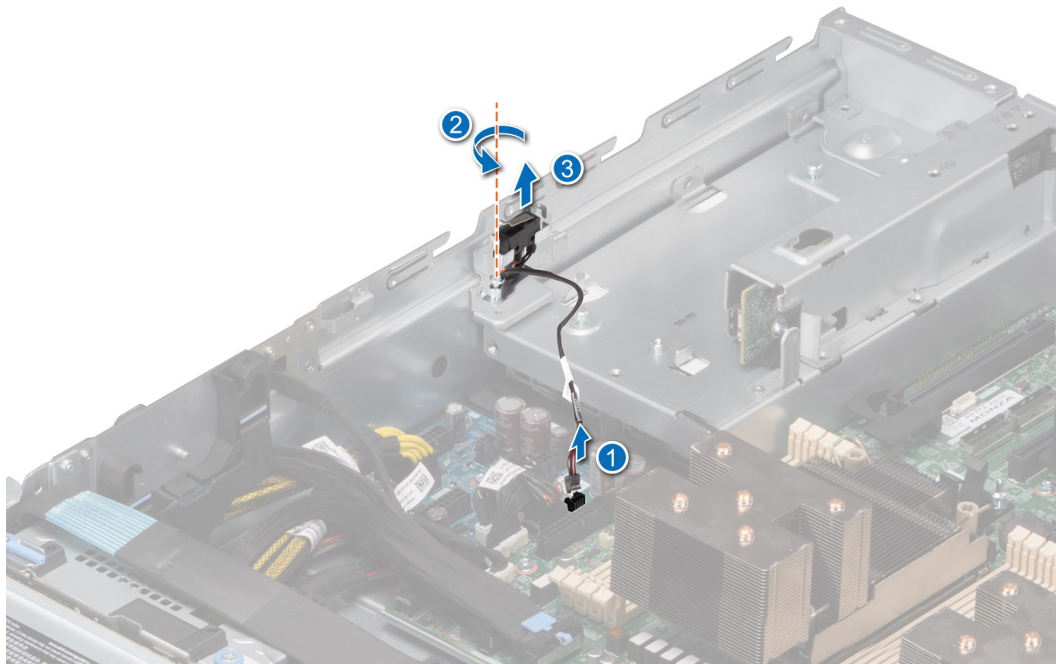
Figure 35. Retrait du module du commutateur d'intrusion
