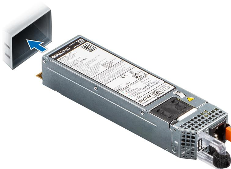
Figure 129. Installation d'un bloc d'alimentation
