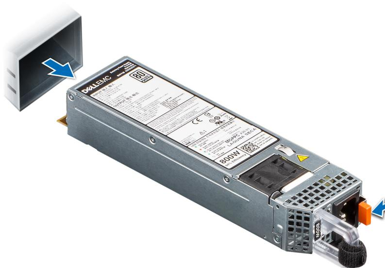
Figure 128. Retrait d'un bloc d'alimentation
