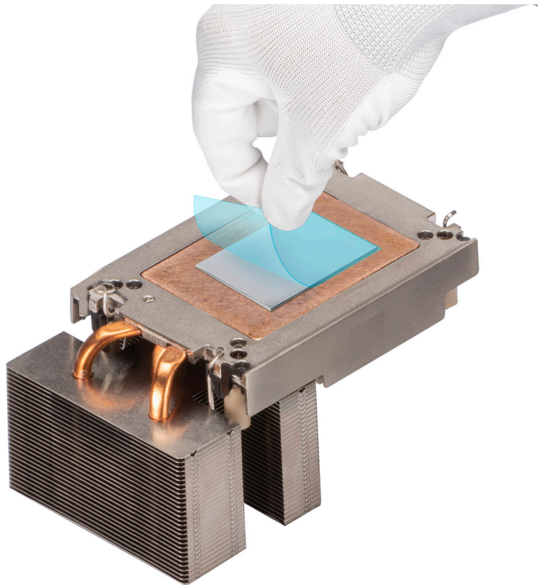
Abbildung 63. Entfernen Sie die Schutzfolie der Wärmeleitfolie (TIM)
