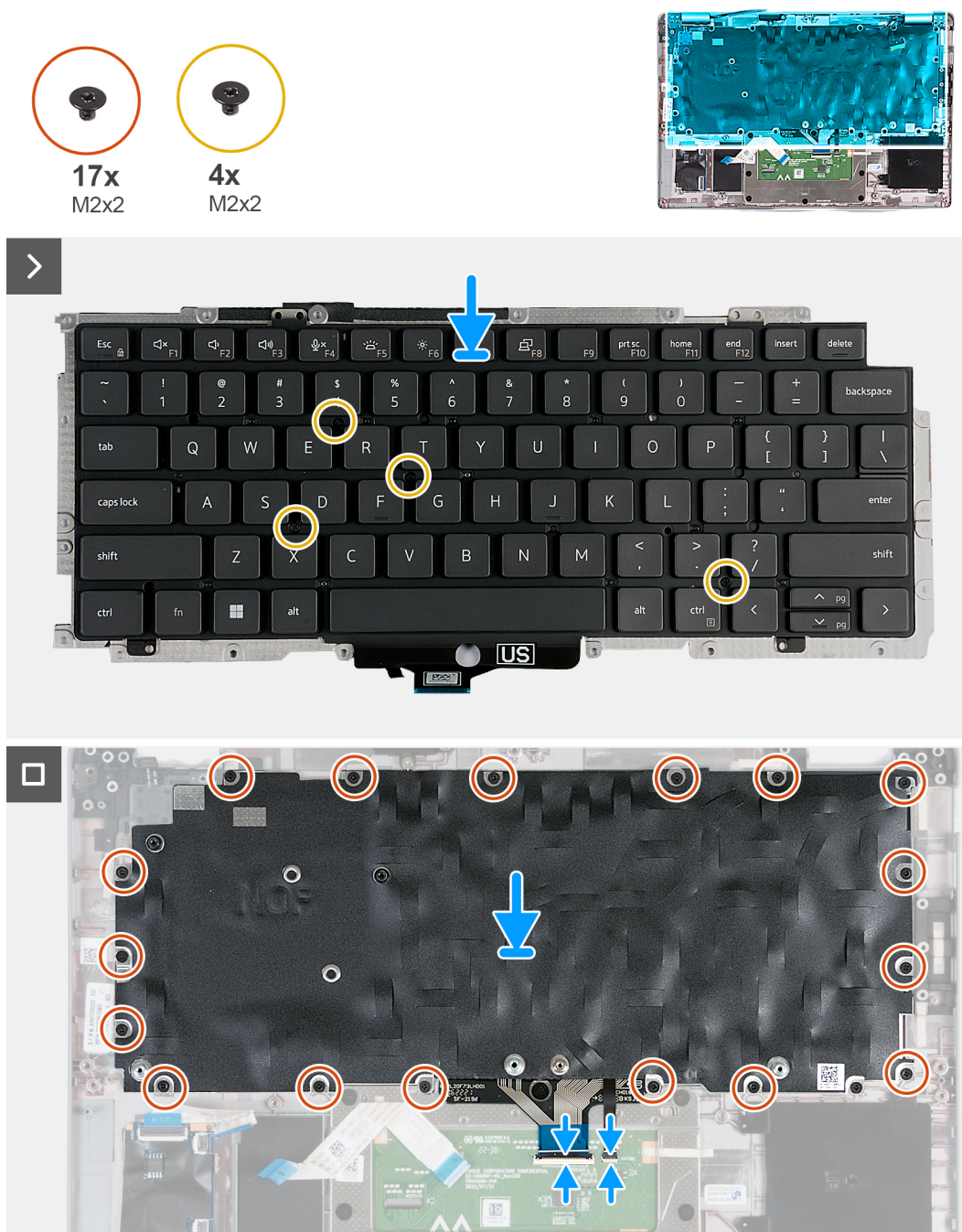
Rysunek 62. Instalowanie klawiatury
