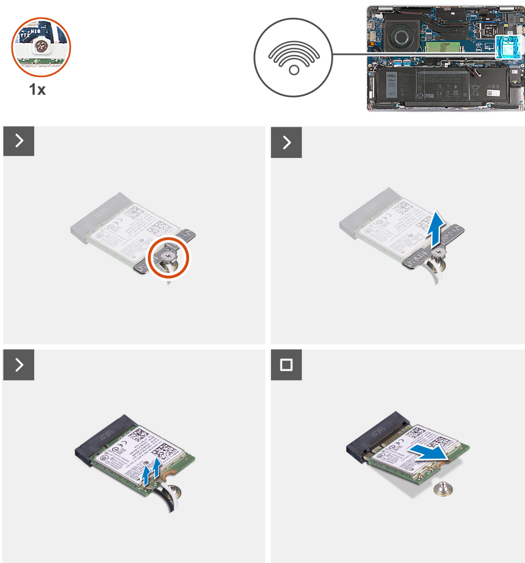
Rysunek 10. Wymontowywanie karty sieci bezprzewodowej
