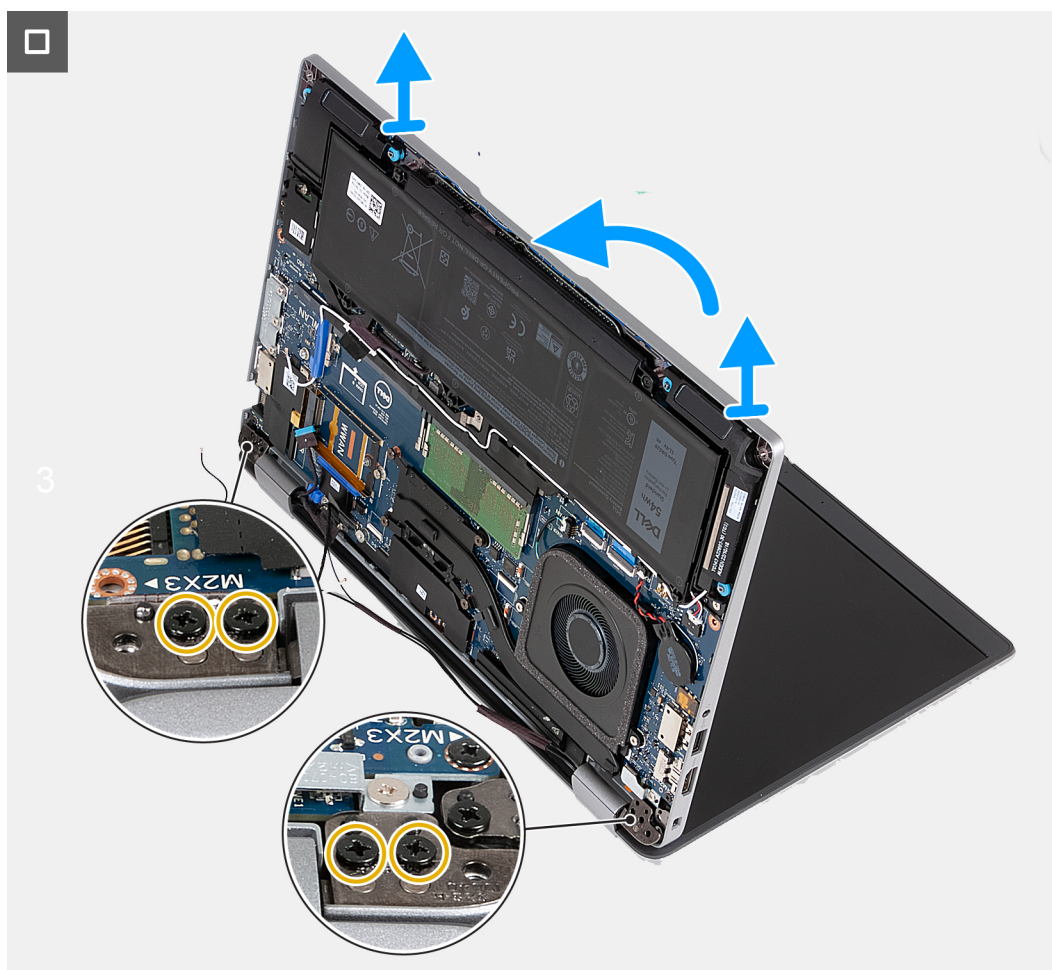
Rysunek 36. Wymontowywanie zestawu wyświetlacza — dotyczy komputerów wyposażonych w kartę sieci 5G
