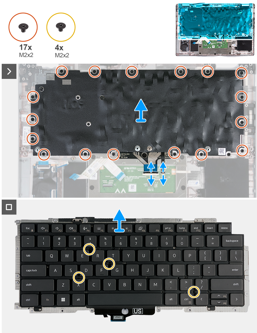
Rysunek 61. Wymontowywanie klawiatury
